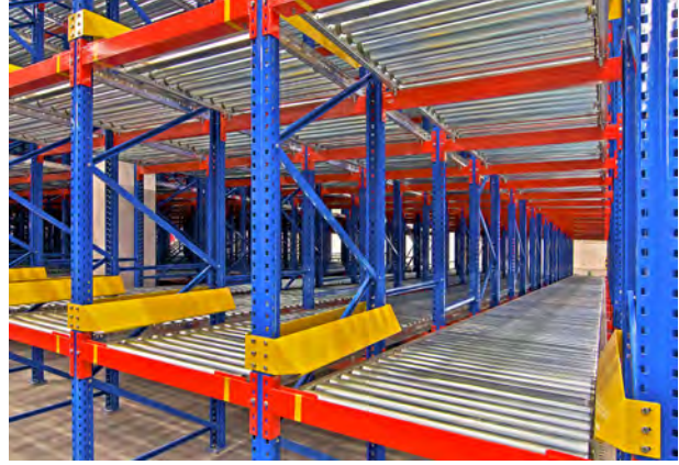
Görsel 5.11: Kayar raf ve arkadan itmeli (push back) sistemler
