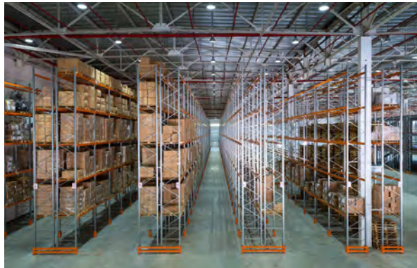
Görsel 5.6: Sırt sırta raf sistemleri
