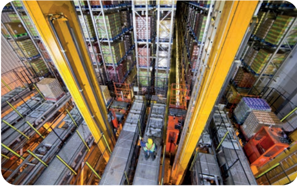
Görsel 2.36: Yüksek irtifalı raflarda tam otomatik depo sistemi
