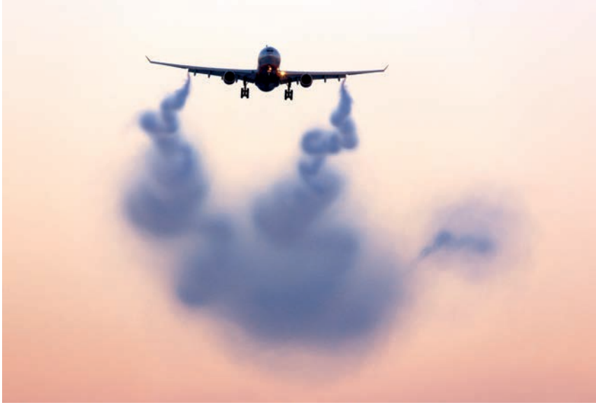
Görsel 1.16: Kanat uçlarında oluşan vortisler
