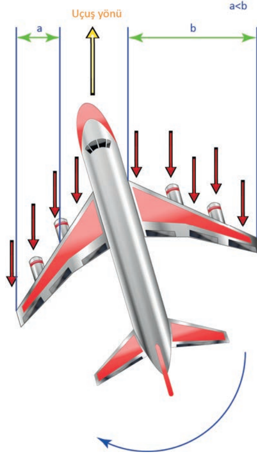
Görsel 2.20: Geriye ok açısının yönsel stabilite üzerindeki etkisi
