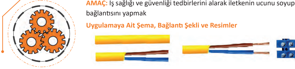
Görsel 5.7: Klemense iletken takılması
