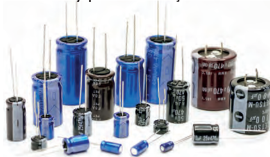
Görsel 4.11: Elektrolitik kondansatörler
