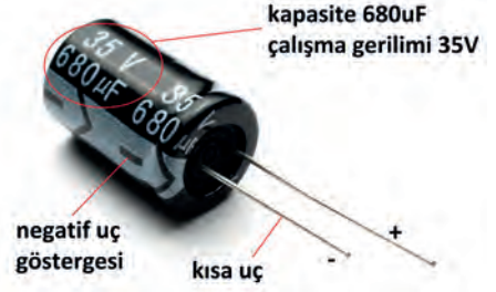
Görsel 4.24: Kondansatör etiket değerleri ve negatif uç göstergesi
