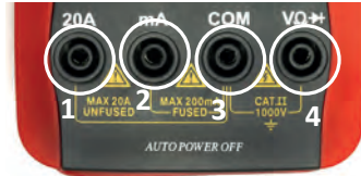
Görsel 2.18: Dijital AVOMETRE prob bağlantı terminalleri
