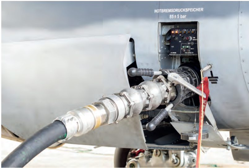
Görsel 5.33: Yakıt deposu ve yakıt deposunun topraklanması
