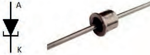
Görsel 7.7: Tunel diyot sembolü ve görünüşü
