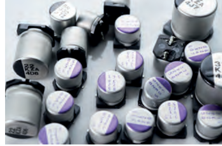
Görsel 4.15: SMD elektrolitik kondansatörler
