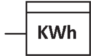
Şekil 2.37: Elektrik sayacı sembolü
