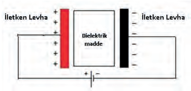
Şekil 4.1: Kondansatörün temel yapısı
