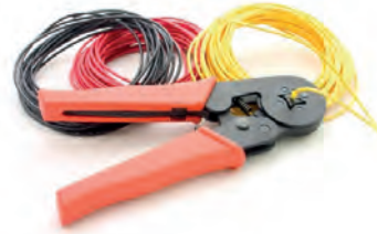
Görsel 5.25: Pinin sıkıştırılması
