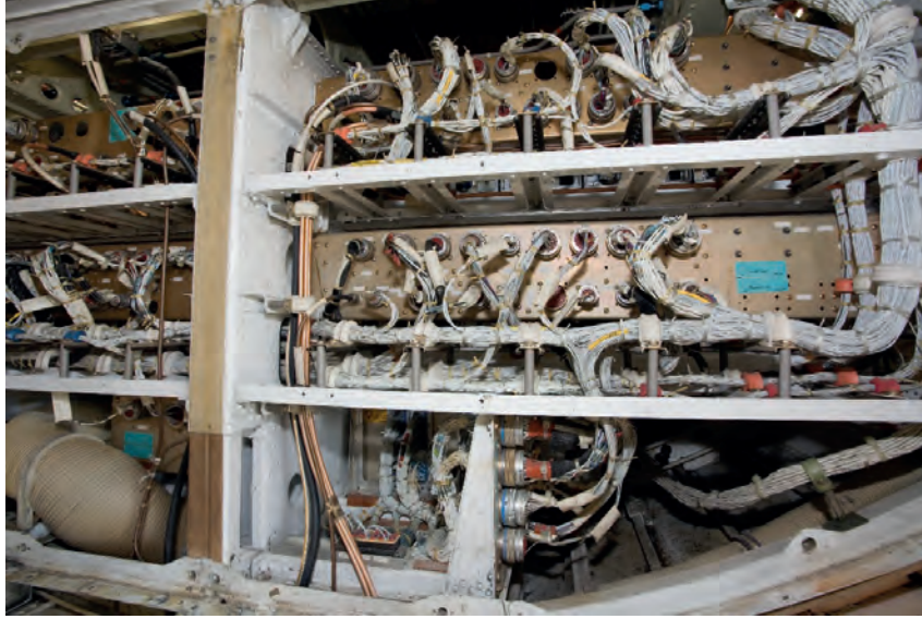
Görsel 5.11: Uçak üstü harness (demetleme) uygulaması
