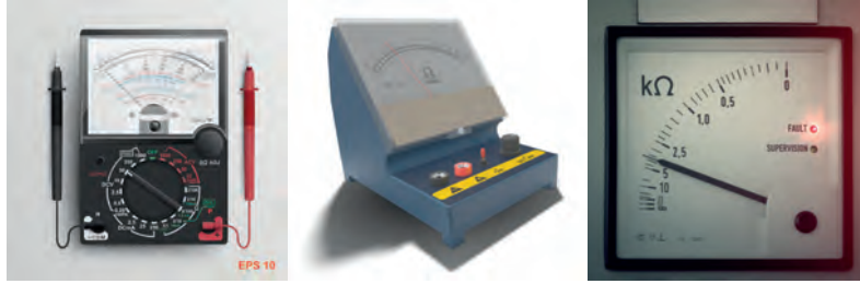
Görsel 2.8: Analog ohmmetre örnekleri
