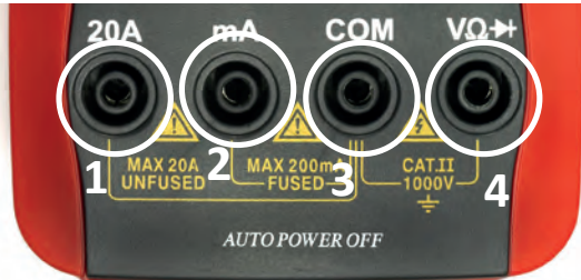
Görsel 2.18: Dijital AVOMetre prob bağlantı terminalleri
