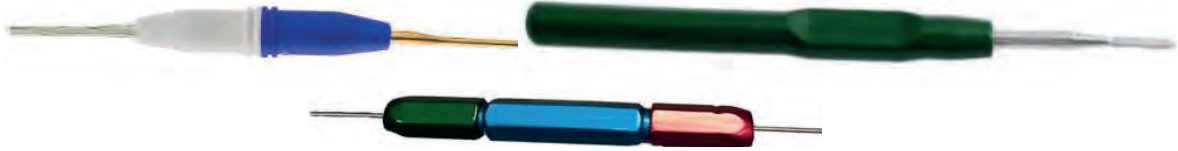
Görsel 5.19: Pin ekleme ve sökme aletleri
