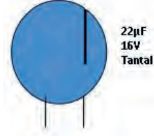
Şekil 4.15: İkinci tip tantal kondansatör renk bantları
