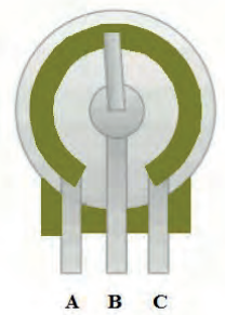
Görsel 3.14: Potansiyometre içyapısı
