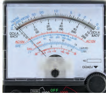
Görsel 2.21: Analog AVOMetre skalası
