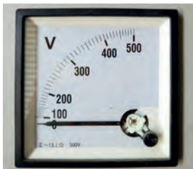
Görsel 2.5: Analog pano tipi voltmetre (0-500 V)
