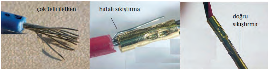
Görsel 5.12: Yanlış ve doğru pin bağlantısı
