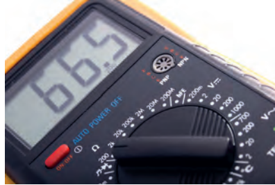
Görsel 2.9: Dijital ohmmetre
