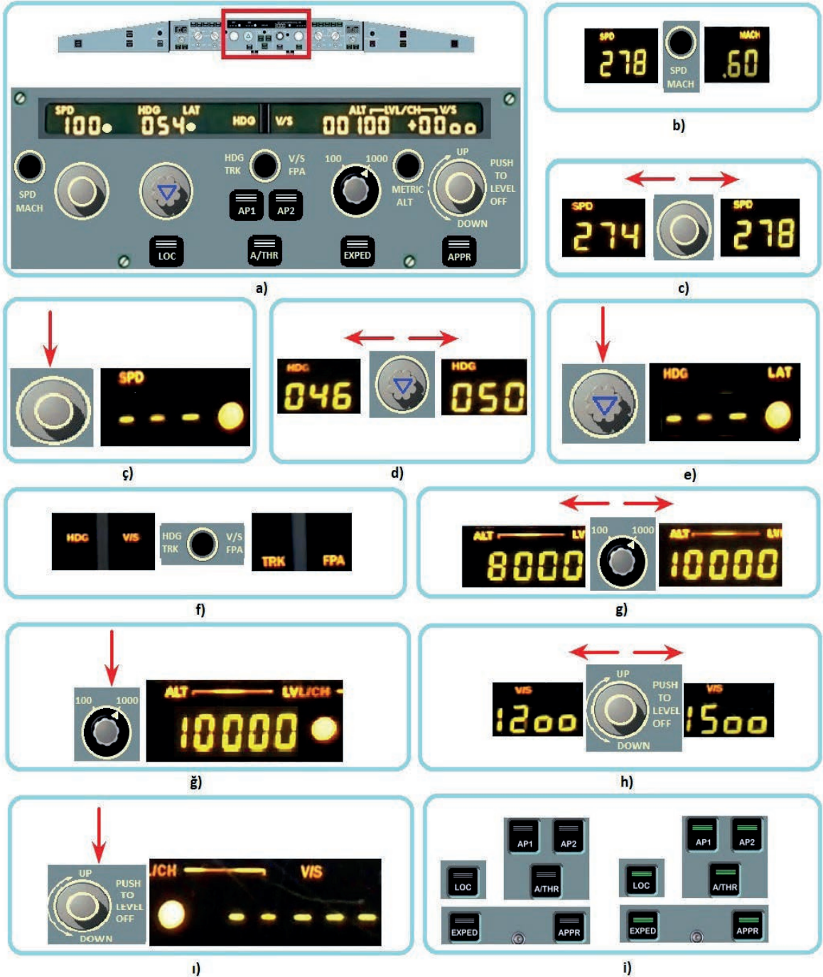
Görsel 4.62: FCU panelinin test edilmesi Kullanılacak Araç Gereç, Makine ve Avadanlık
