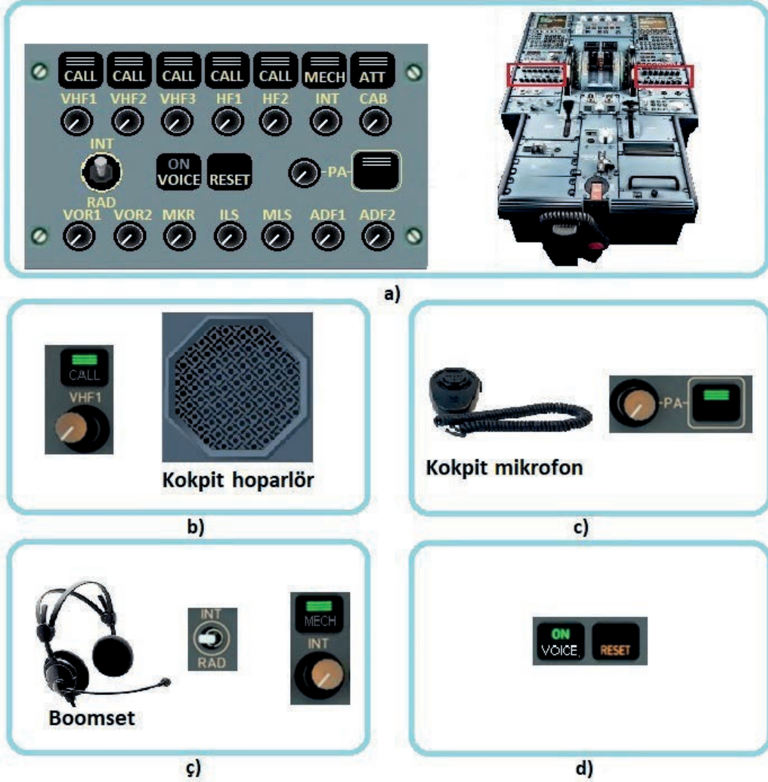
Görsel 4.59: Ses kontrol panelinin test edilmesi
