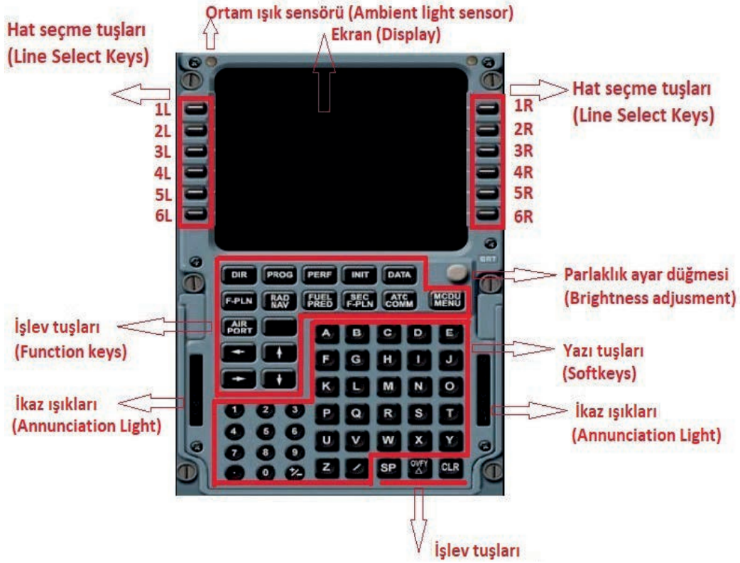
Görsel 6.33: Çok amaçlı kontrol ve görüntüleme ünitesi (MCDU) tuşları
