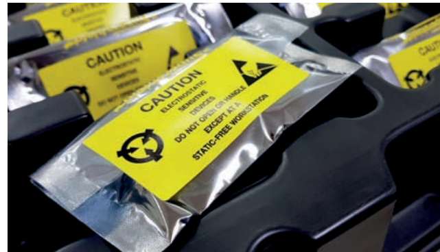
Görsel 3.13: Antistatik poşet ve üzerinde bulunan sarı uyarı etiketi
