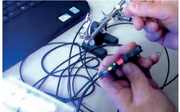
Görsel 5.125: Yük devredeyken karşılıklı sensör düzeneği
