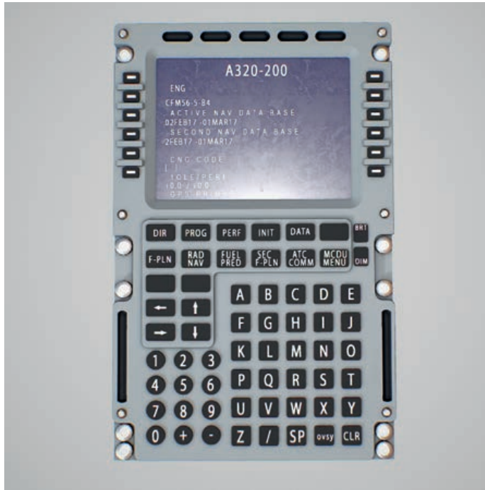
Görsel 6.32: Çok amaçlı kontrol ve görüntüleme ünitesi (MCDU)
