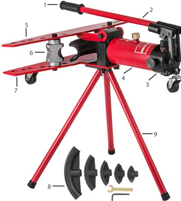
Görsel 4.38: Hidrolik boru bükme makinesi kısımları
