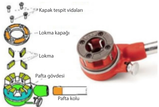
Görsel 4.12: Sabit lokmalı cırcırlı boru paftası
