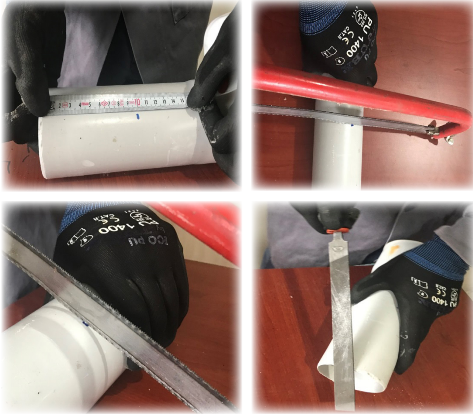
Görsel 5.15: PVC boru kesme ve pah kırma aşamaları
