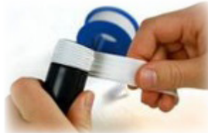
Görsel 4.22: Teflon bant sarılması
