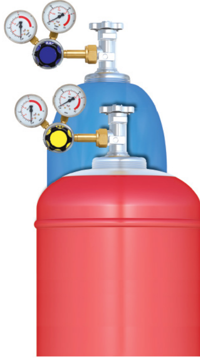
Görsel 8.6: Regülatör montajı
