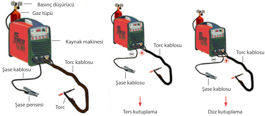
Görsel 13.16: TIG kaynak makinesi kutuplama
