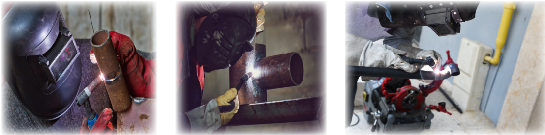
Görsel 13.19: TIG boru kaynağında ek telinin verilmesi
