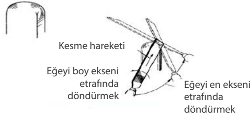
Görsel 3.15: Küresel yüzeylerin eğelenmesi
