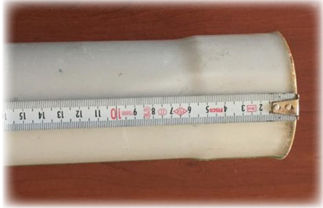
Görsel 5.20: Muf açılmış boru ölçüsü
