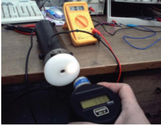
Görsel 7.18: Takometrenin sensörüyle gerilim ölçme
