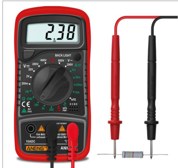
Görsel 5.4: Avometrenin ohmmetre kademesiyle direnç ölçme
