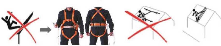
Şekil 12.10: Çatı çalışma kuralları
