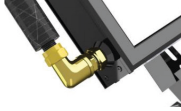
Görsel 12.13: Kollektör boyler dönüş bağlantılarının yapılması
