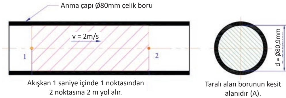
Şekil 9.1: Boru içinden geçen akışkanın hızı ve hızla bağlı olarak kapladığı hacim
