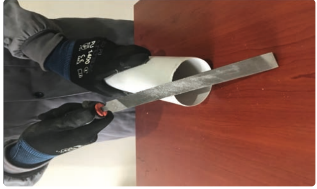
Görsel 4.5: PVC borularda pah kırma
