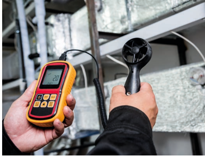
Görsel 7.5: Hava hızı ölçümü
