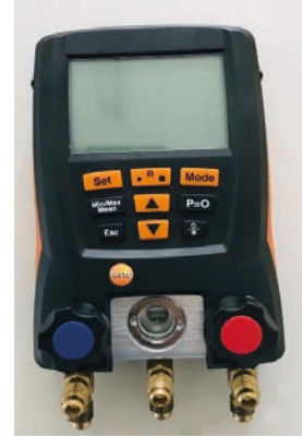
Görsel 12.15: Dijital şarj manifoldu
