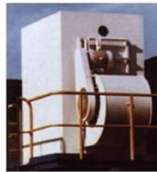
Görsel 8.2: Üflemlerli tip (radyal fanlı) su soğutma kuleleri
