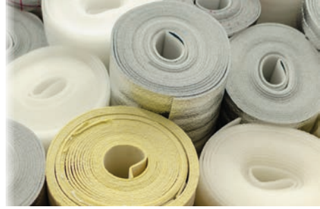
Görsel 4.8: Polietilen yalıtım malzemesi
