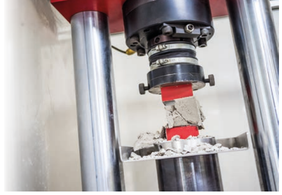
Görsel 4.3: Mekanik dayanım testi
