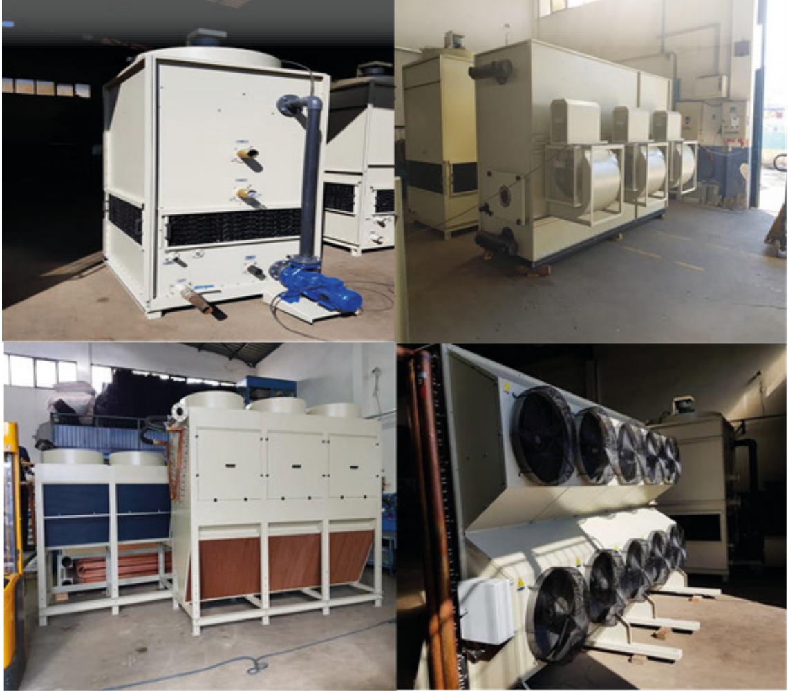
Görsel 8.1: Su soğutma kuleleri
