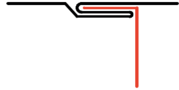
Şekil 2.47: Diğer parçanın yerleştirilmesi
