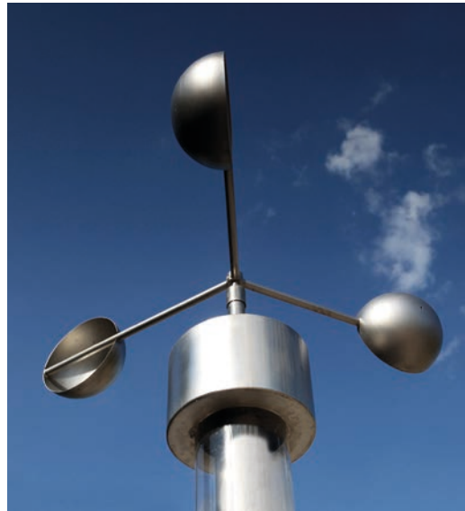
Görsel 5.12: Mekanik anemometre
