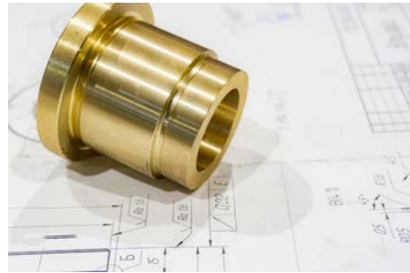
Görsel 1.1: Bakır ve çinkonun oluşturduğu pirinç alaşımı
