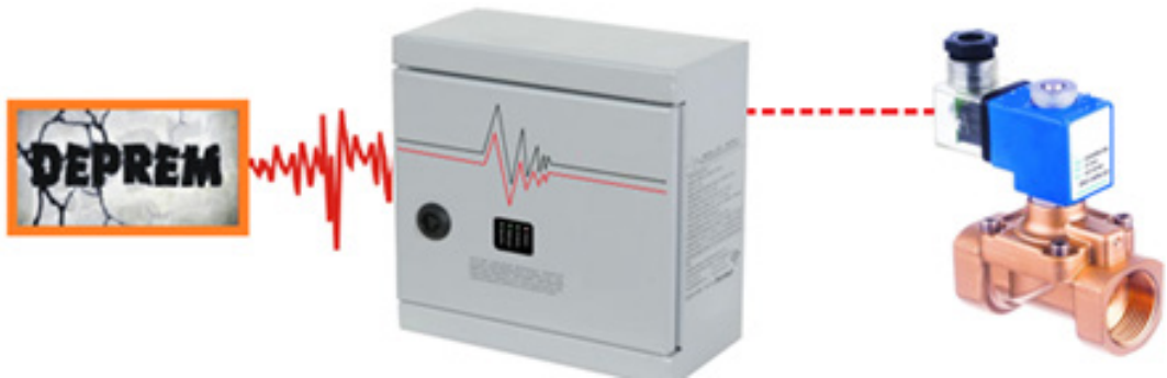
Görsel 3.9: Elektromekanik deprem vanası çalışma prensibi
