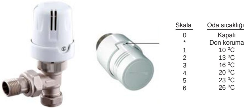
Görsel 9.28: Termostatik vana ve termostatik vana skalası
