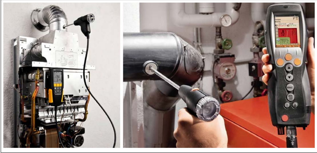
Görsel 2.15: Baca gazı analiz cihazı ile ölçüm ve parametrelerin analizi
