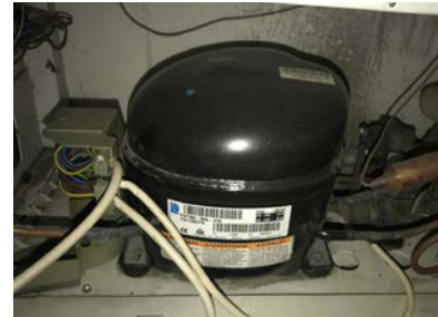
Görsel 2.6: Derin dondurucuda kullanılan kompresör
