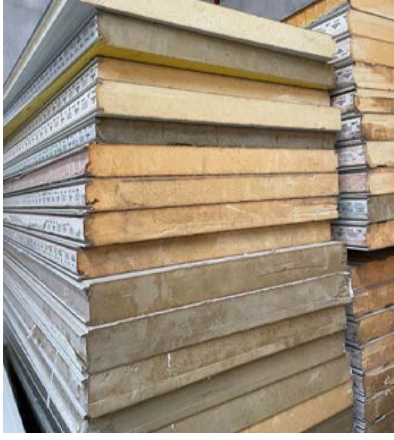
Görsel 6.6: Soğuk oda yapımında kullanılan tavan, duvar ve zemin panelleri
