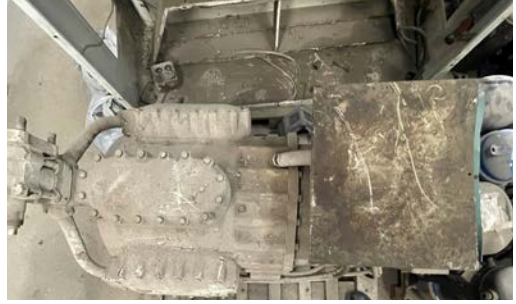
Görsel 7.5: İki aşamalı yarı hermetik kompresör
