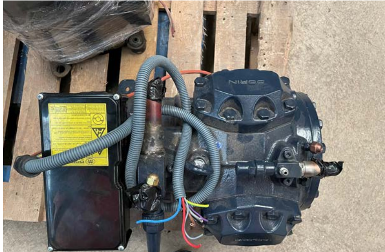
Görsel 7.4: Yarı hermetik pistonlu kompresörün dış yapısı
