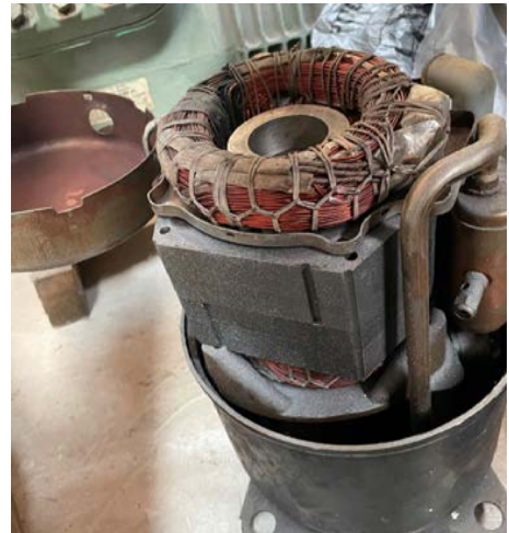
Görsel 7.2: Hermetik tip kompresörün iç yapısı
