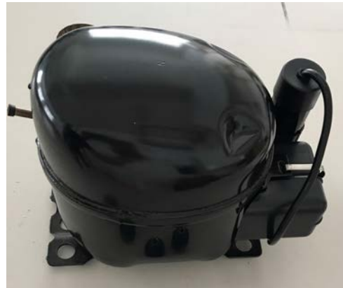
Görsel 1.8: Soğutucularda kullanılan kompresör
