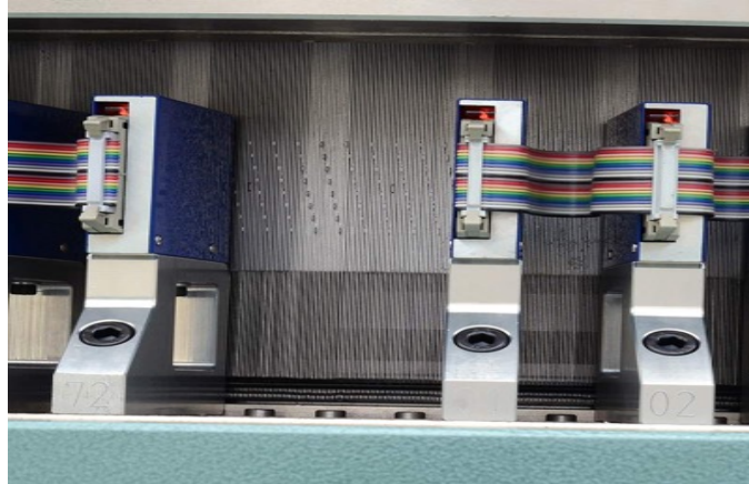
Görsel 1.5: Yuvarlak örme makinesinde elektronik jakar modülleri
