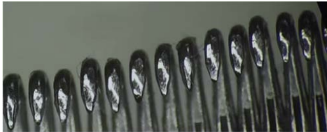
Görsel 2.19: İğnede kanca aşınması
