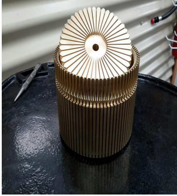
Görsel 2.22: Silindir ve kapakta iğne sıraları
