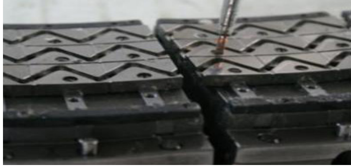
Görsel 2.12: Yuvarlak örme makinelerinde çeliklerin sabitlenmesi
