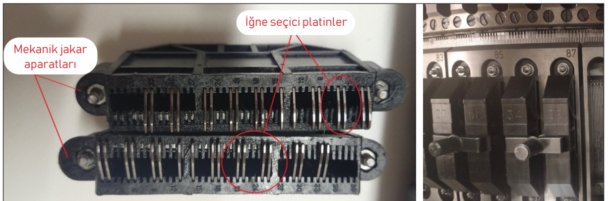
Görsel 1.15: Mekanik jakar modülünün makineye takılması
