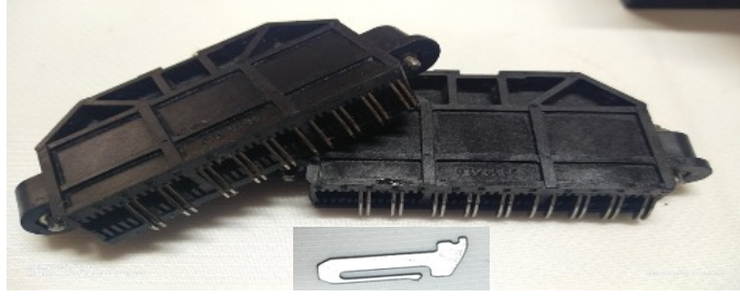
Görsel 1.4: Mekanik jakar ünitesi ve iğne seçici platin
