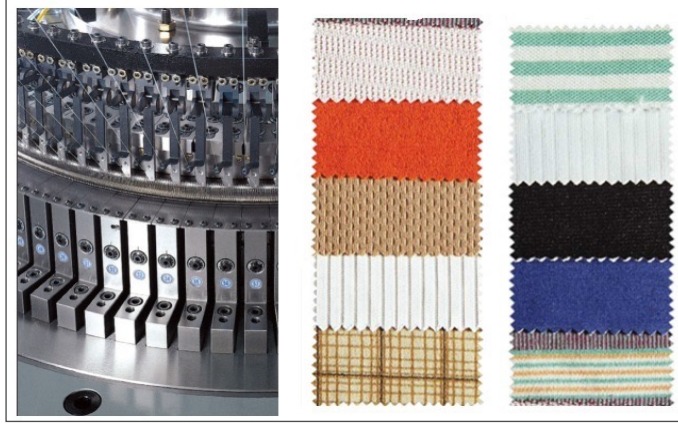
Görsel 1.1: Yuvarlak örme makinesinde jakar desenli üretim
