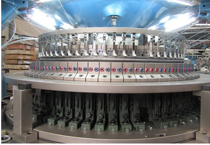
Görsel 2.38: Mekanik jakar modüllerinin makine üzerindeki konumları
