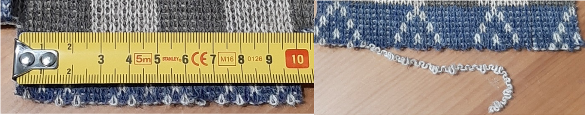
Görsel 4.9: İlmek iplik uzunluğunun ölçümü
