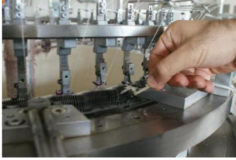
Görsel 2.15: Yuvarlak örme makinelerinde platinlerin takılması
