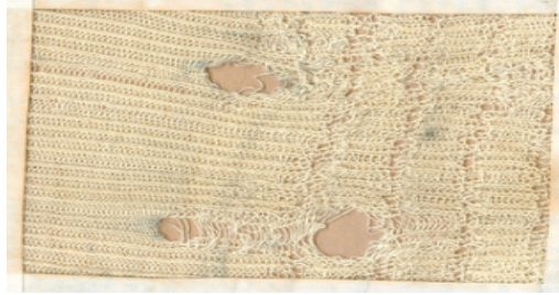
Görsel 2.18: Dil kırılması sonucu oluşan hata
