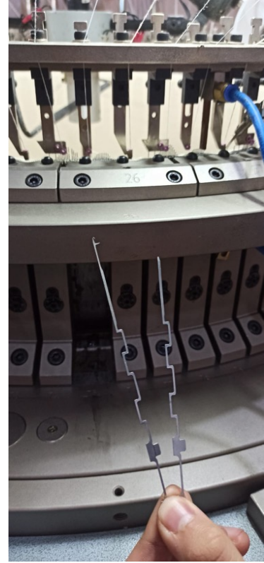
Görsel 2.30: Arızalı iğne değişimi
