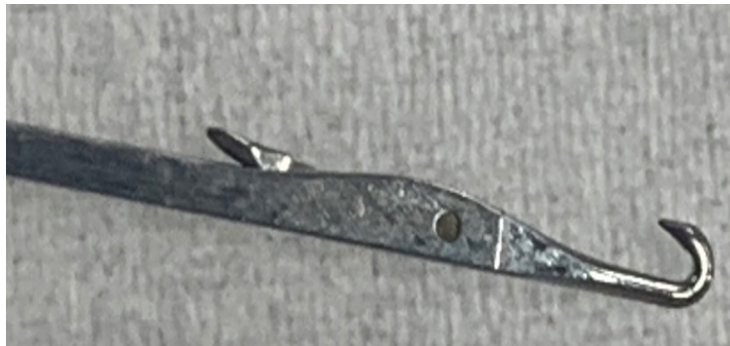
Görsel 2.21: İğnede gövde aşınması
