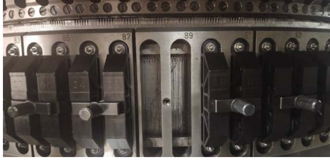
Görsel 1.3: Yuvarlak örme makinesinde mekanik jakar aparatı
