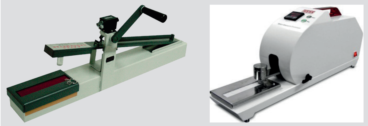
Görsel 16.6: Mekanik ve Elektronik Test Cihazları Crockmeter(Krokmetre)
