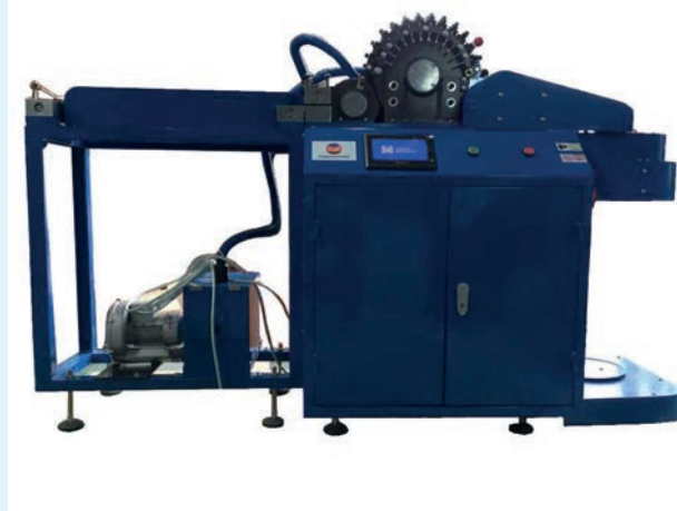
Görsel 3.12: Laboratuvar Tipi Tarak Makinesi
