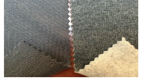
Görsel 15.2 Şardonlama İşlemi Uygulanmamış ve Uygulanmış Kumaş
