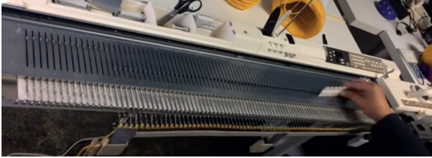
Görsel 10.6: İğnelerin Çalışma Konumuna Getirilmesi
