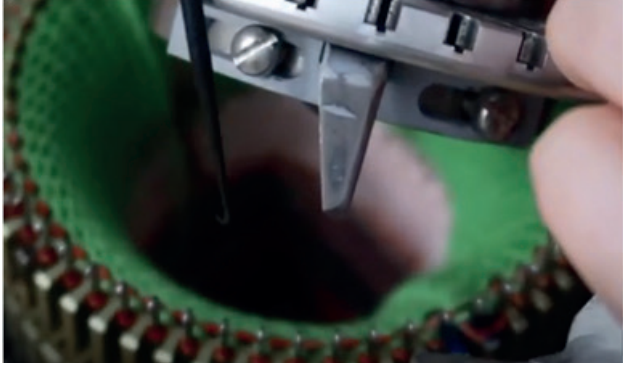
Görsel 10.28: Kapak İğne Sisteminin Silindire Takılması
