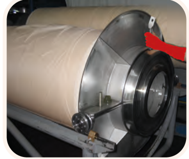
Görsel 2.57: Kelepçenin çıkarılması
