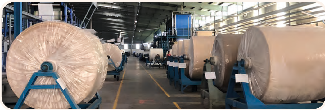
Görsel 3.15: Hava geçirmez malzeme ile sarılmış ve beklemeye alınmış doklar
