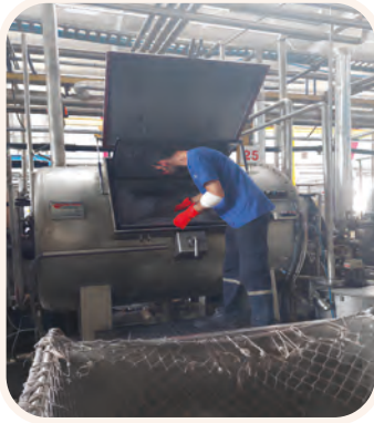
Görsel 4.11: Filelerin tambura yerleştirilmesi
