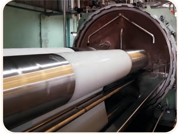
Görsel 2.42: Kumaşın diğer sargı silindirine aktarılması
