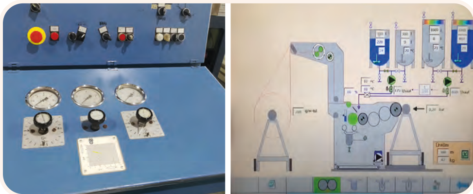
Görsel 3.9: Sıkma silindir basınç ayarı ve programatörden kontrolü
