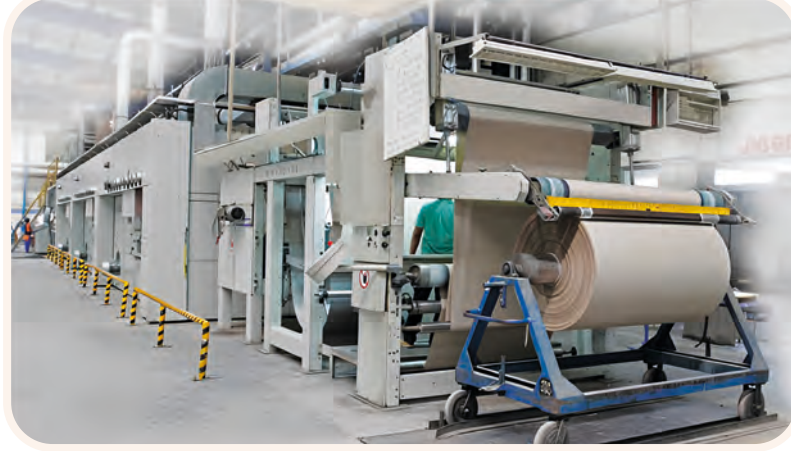
Görsel 3.32: Pad-thermosol boyama yöntemine göre çalışan boyama makinesi
