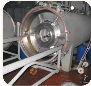
Görsel 2.53.b: Kumaşın makineye yerleştirilmesi
