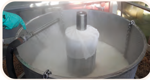
Görsel 1.12: Pres makinesinde elyafın ıslatılması
