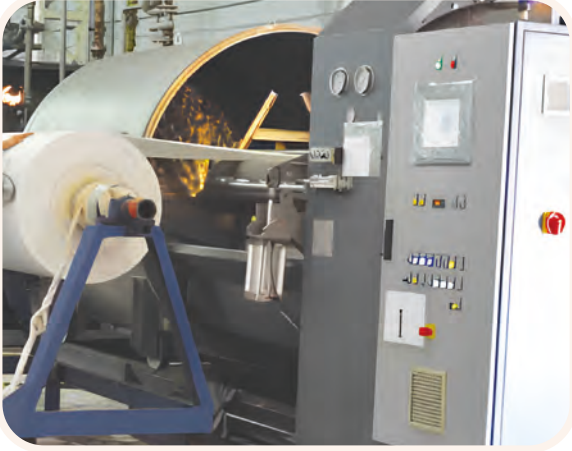
Görsel 2.41: Sargı silindirine kumaşın sarılması ve makineye yüklenmesi
