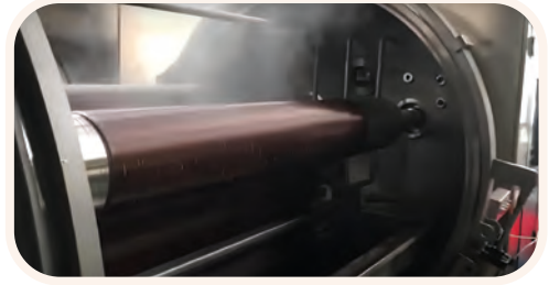
Görsel 2.43: Sargı silindirlerinde boyanan kumaş
