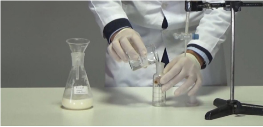
Görsel 7.6: Numune suyun hidrometri şişesine doldurulması
