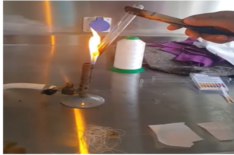
Görsel 6.1: Liflerin tüp yardımıyla ısıtılması
