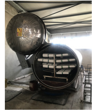
Görsel 6.7: Yıkama öncesi bobin ipliğin fiksajı (termofiksaj makinesi)
