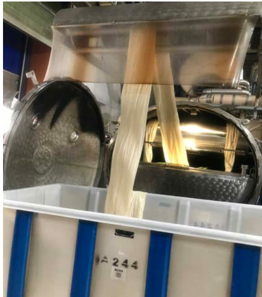
Görsel 4.13: Ağartma işlemi için kumaşı makineye besleme
