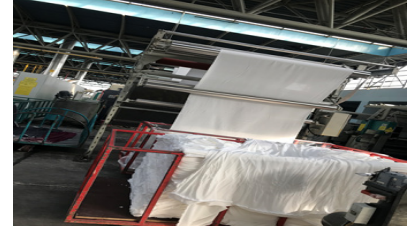
Görsel 6.17: Termofiksaj işleminden sonra kumaş çıkışı
