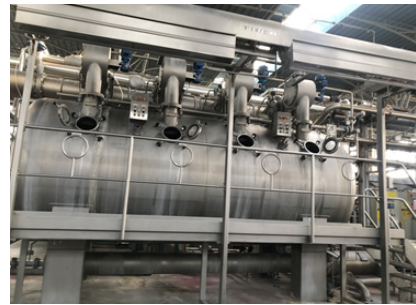
Görsel 6.3: Polyester kumaşların yıkanmasında kullanılan jet boyama makinesi
