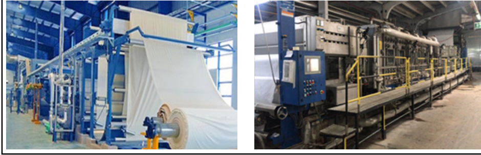
Görsel 3.3: Haşıl sökme işleminde kullanılan makineler
