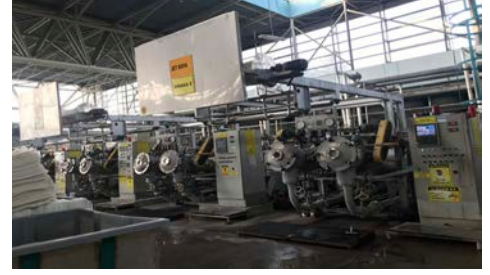
Görsel 3.8: Çektirme yöntemiyle ağartma (HT jet makine)
