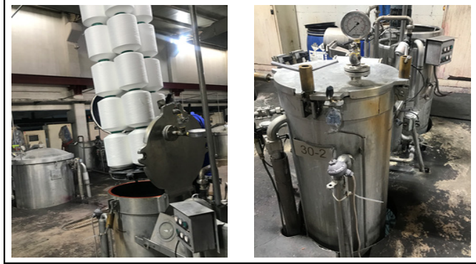
Görsel 6.4: Numune HT bobin boyama (yıkama) makinesi
