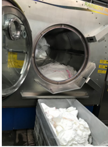
Görsel 6.23: Atmosferik boyama makinesine parça mamulün verilmesi
