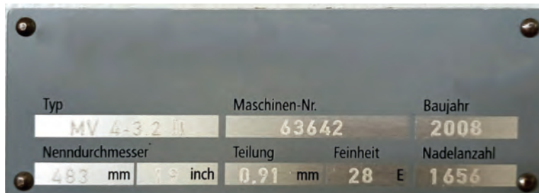
Görsel 1.3: Örme makinesi etiket levhasında incelik bilgisi
