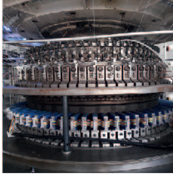
Görsel 3.5: Silindirik plakası elektronik seçimli yuvarlak örme makinesi örücü elemanları
