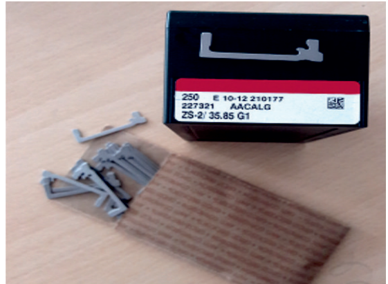
Görsel 3.18: 10 G ve 12 G düz örme makinelerinde kullanılan u platin ve orijinal kutusu
