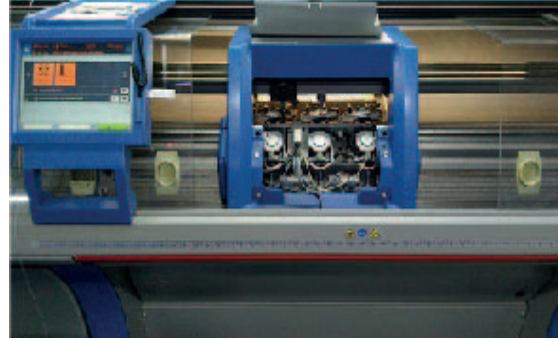
Görsel 3.6: Elektronik seçimli düz örme makinesi örücü elemanları
