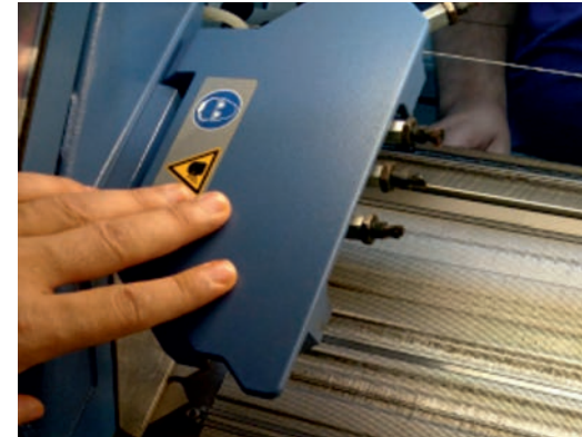
Görsel 5.19: Düz örme makinesinde otomatik plaka yağlama sistemi
