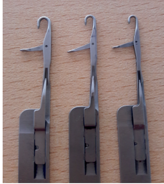
Görsel 3.15: İğne kalınlığı, boyu ve şekli aynı olup baş kısımları farklı 4 G, 5 G ve 7 G iğneler
