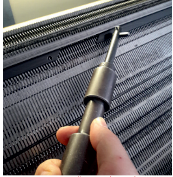
Görsel 3.16: Platin değişimi için iğne bıçağı açma
