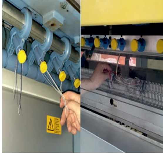
Görsel 5.13: Düz örme makinesinde tarak ve ana merdane-deki ipliklerin temizlenmesi
