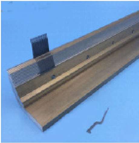
Görsel 1.21: Çözümlü örme makinelerinde kullanılan blok iğne rayları
