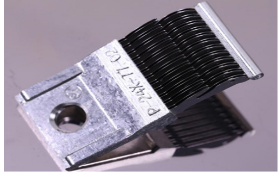
Görsel 1.22: Çözgümlü örme makinelerinde baskı platin blokları
