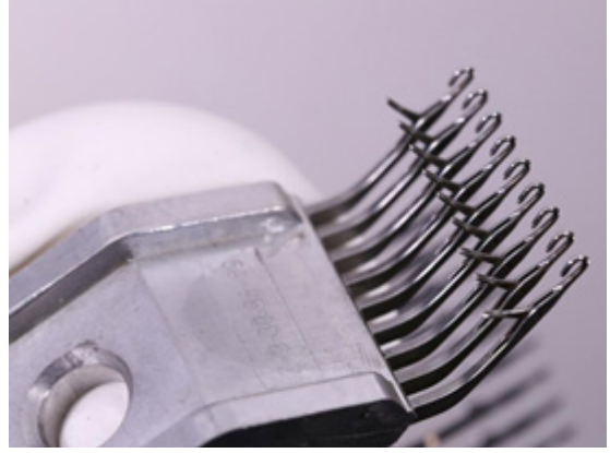
Görsel 1.19: Çözümlü örme makinelerinde kullanılan dilli iğne blokları
