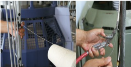
Görsel 2.3: İpliğin kılavuz borularından geçirilişi
