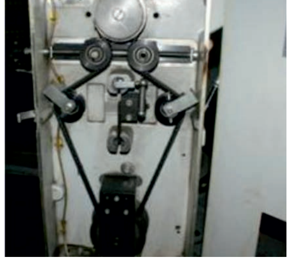
Görsel 2.23: Yuvarlak örme makinesinde kumaş çekim sistemi dişlileri
