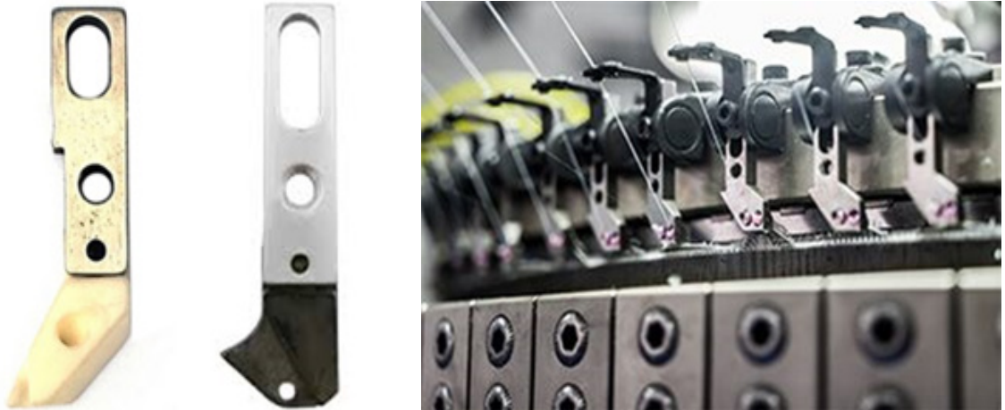
Görsel 1.39: Yuvarlak örme makinesinde mekik ve konumları
