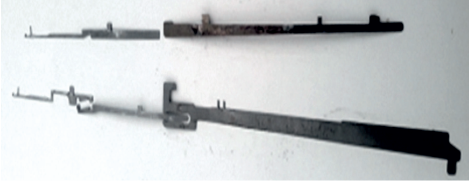
Görsel 1.33: Yuvarlak örme makinesinde seçici platinli iğnelerin plakada duruş şekilleri
