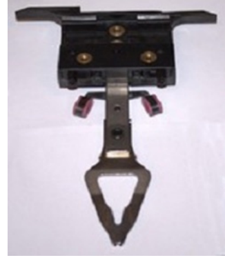
Görsel 1.40: Düz örme makinesinde mekiğin konumu
