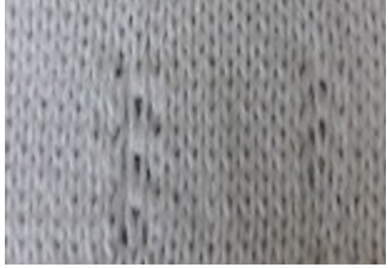
Görsel 3.11: Bozuk iğne başı ve dilinden kaynaklı kumaş hatası
