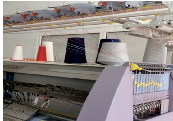
Görsel 3.25: Düz örme makinesinde 4 renk ipliğin, 2 kat olarak 3,4,5 ve 6 numaralı mekiklere bağlanması
