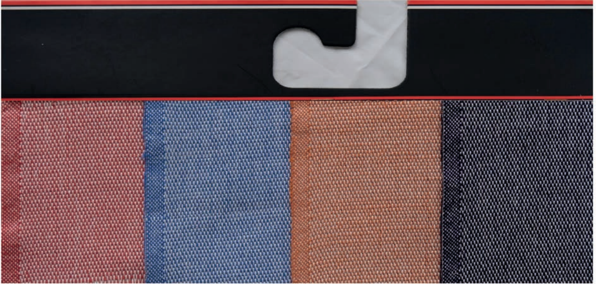
Görsel 1.19: R_{\frac{2}{2}} örgülü numuneye ait kumaş kartelası
