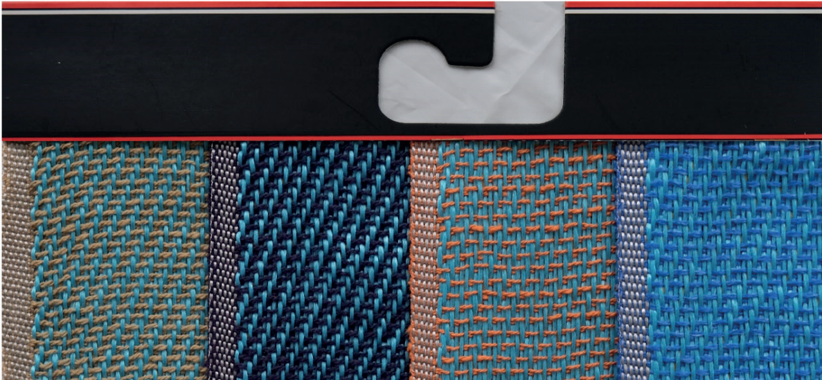
Görsel 7.14: İlave atkı bağlantılı çift katlı numuneye ait kumaş kartelası
