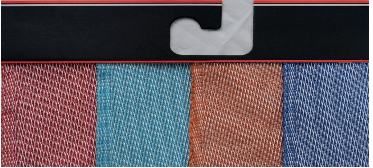
Görsel 5.7: Bağlantı noktası ekleyerek krep örgülü numuneye ait kumaş kartelası
