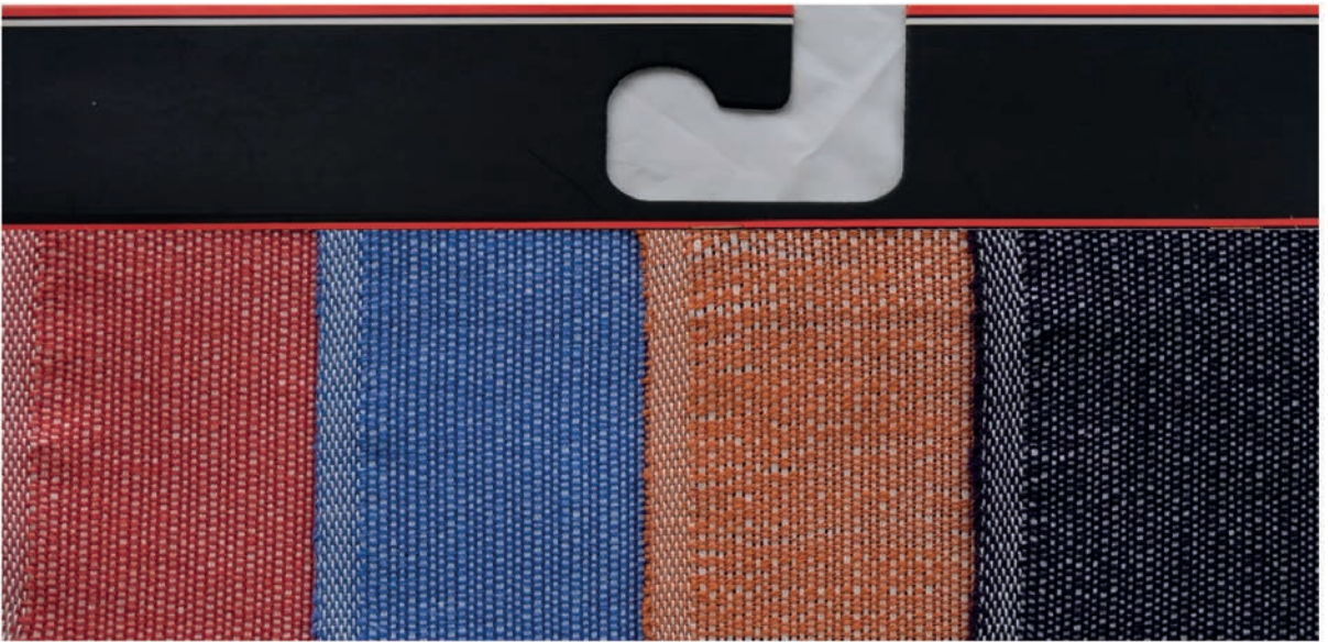
Görsel 1.11: R_a \frac{2}{3} \frac{3}{2} örgülü numuneye ait kumaş kartelası
