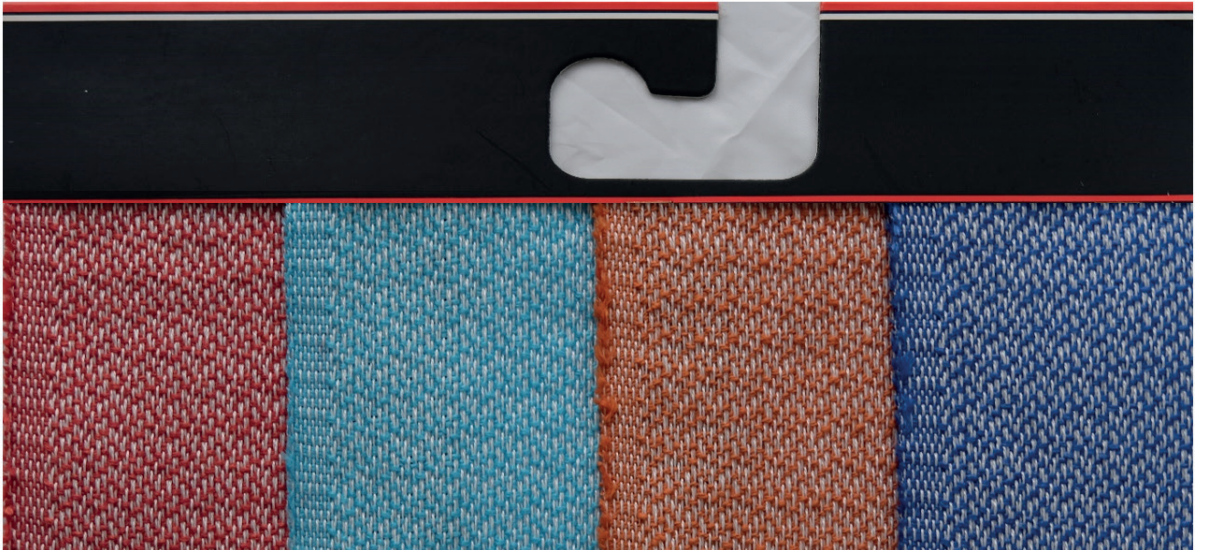
Görsel 5.21: Seçilen örgü ve karışık tahar uygulamasıyla krep örgülü numuneye ait kumaş kartelası
