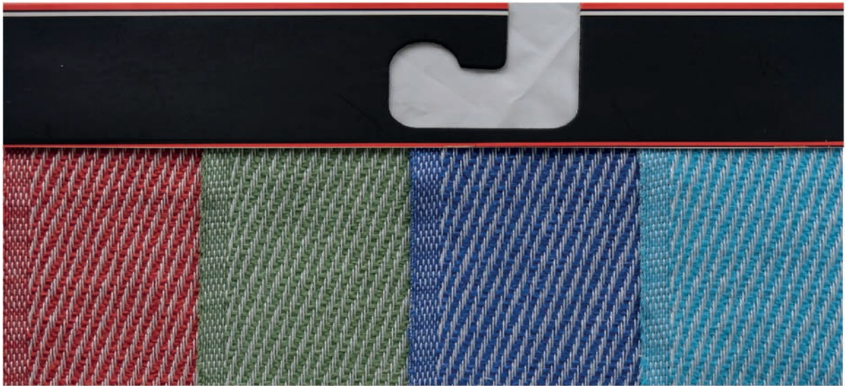
Görsel 2.35: D \frac{5}{5}z çözgü yönünde diyagonal dimi örgülü numuneye ait kumaş kartelası
