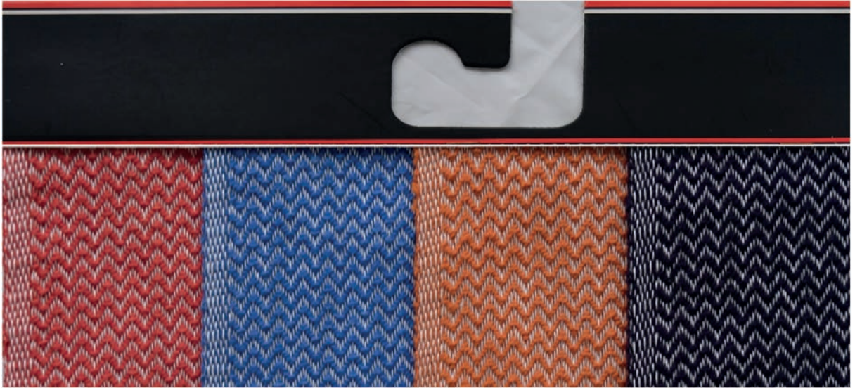
Görsel 2.21: D \frac{3}{2}z çözü yönünde kırık dimi örgülü numuneye ait kumaş kartelası
