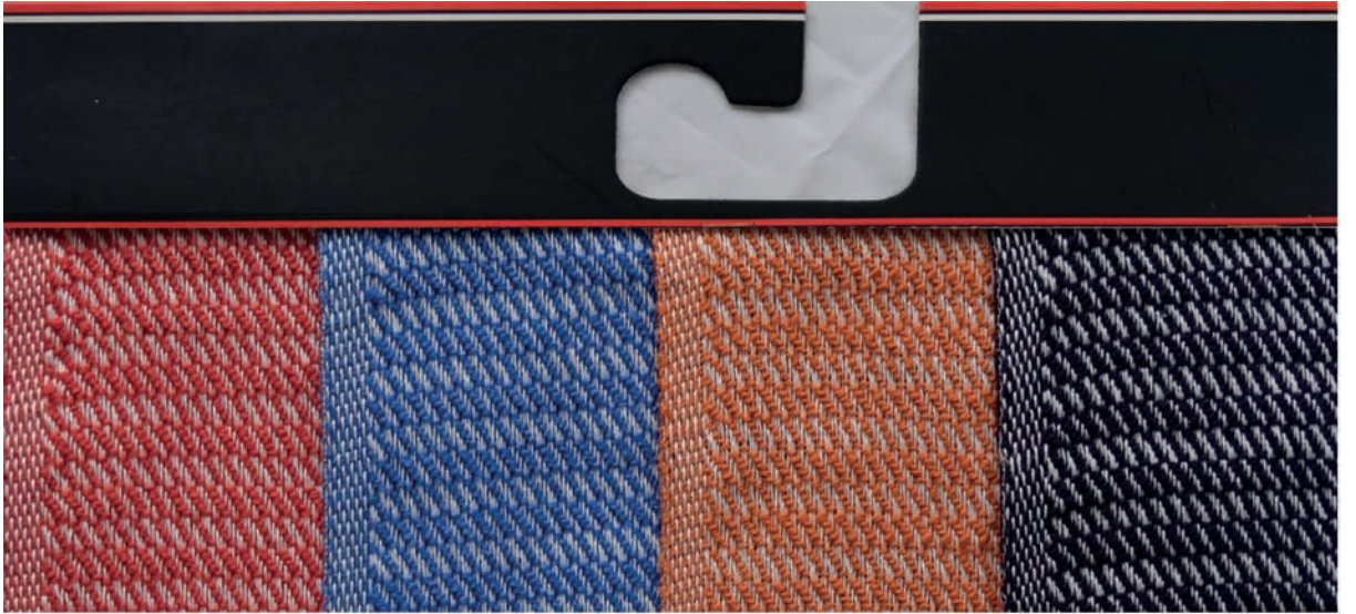
Görsel 2.14: D \frac{3}{2} s atkı yönünde kesik dimi örgülü numuneye ait kumaş kartelası
