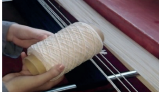
Görsel 1.4: Çözgü hazırlama işlemi
