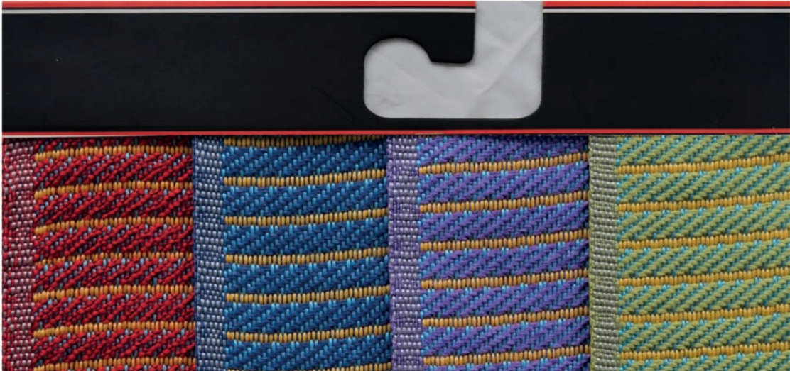
Görsel 8.14: Alt çözü kord örgülü numuneye ait kumaş kartelası
