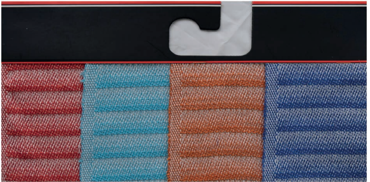
Görsel 3.21: S \frac{4}{1} (2) atkı yönünde yarım gölgeli saten örgülü numuneye ait kumaş kartelası
