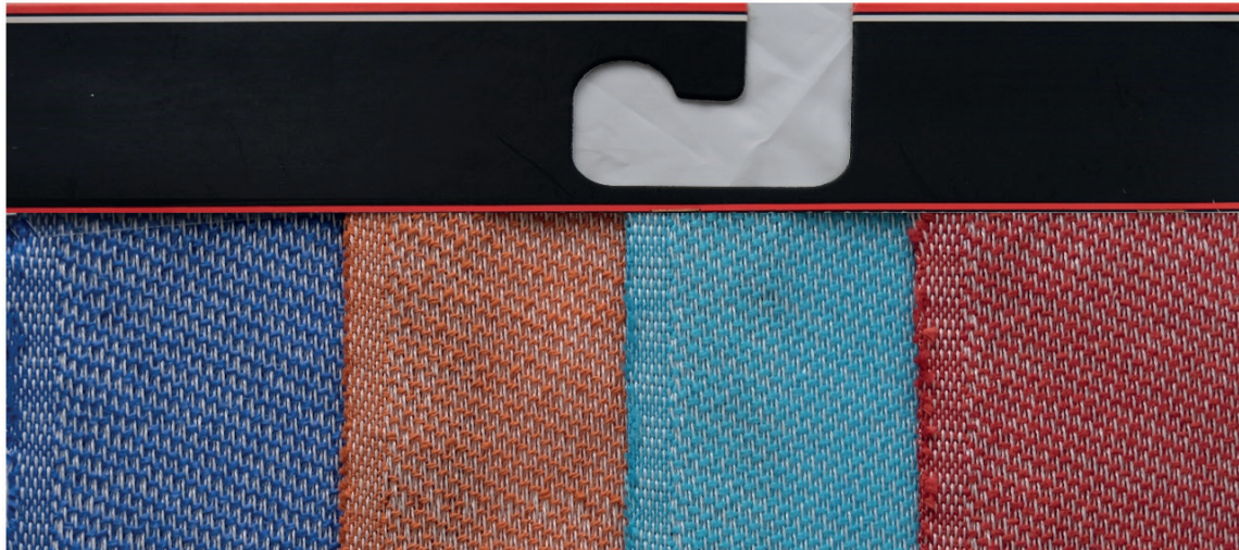
Görsel 5.28: Bağlantı noktalarına motif ilavesi ile krep örgülü numuneye ait kumaş kartelası
