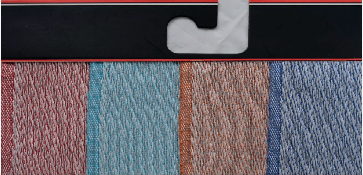
Görsel 3.14: S \frac{9}{1} (7) karışık saten örgülü numuneye ait kumaş kartelası
