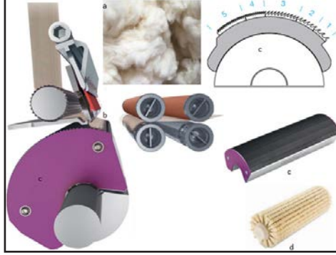
Görsel 1.9: Penye makinesinde kemling oluşumu
