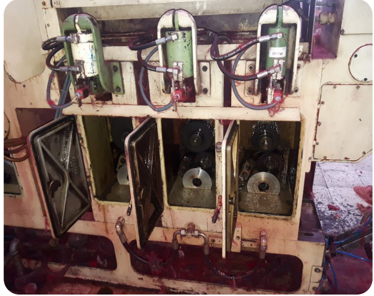
Görsel 5.14: Şanzıman kapakları açılarak çekim ayarına hazırlanması
