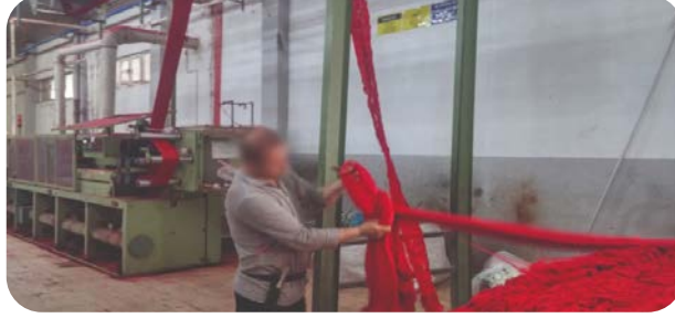
Görsel 5.23: Tow kablosunun bağlanması
