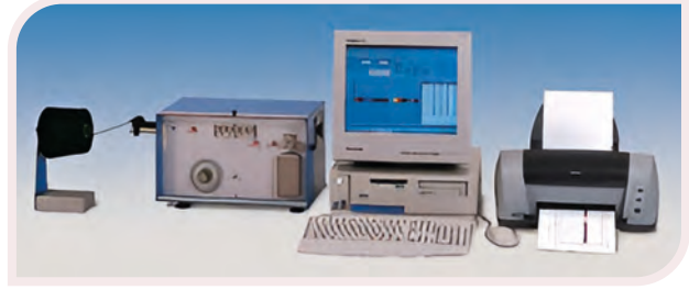
Görsel 5.18: Sürtünme katsayısı ölçüm cihazı
