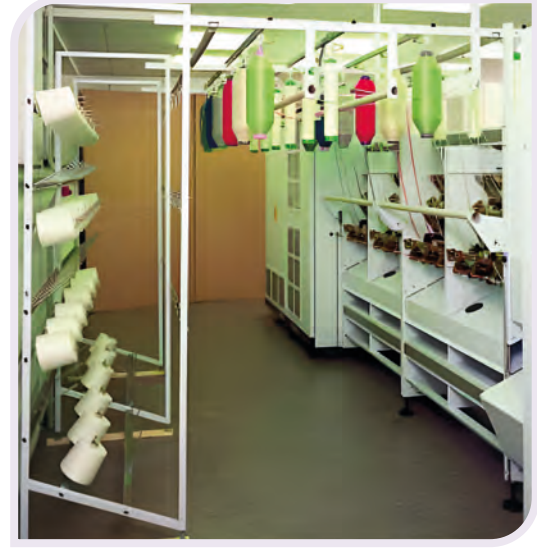
Görsel 4.15: Fashionator fantezi iplik makinesinde fitil bandı ve iplik beslenmesi
