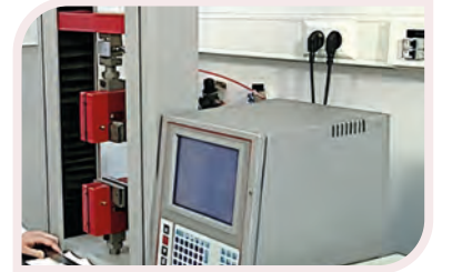
Görsel 5.21: Dikiş mukavemeti ölçümü için kullanılan çekme cihazı
