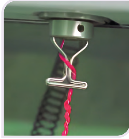
Görsel 4.17: Fashionator fantezi iplik makinesinde fitil, iplik, cer bandı ve efekt ipliğinin oyuk iğde birleştirilerek ipliğe büküm verilmesi
