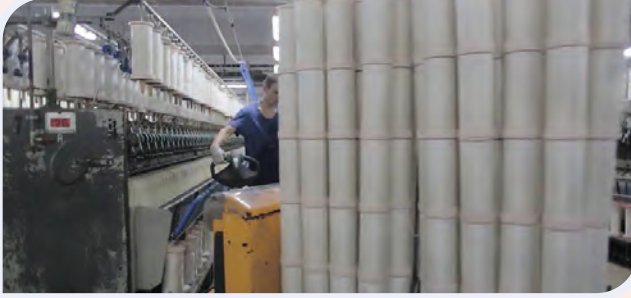
İplik makinesine fitil sevk etme ve iplik sarma
