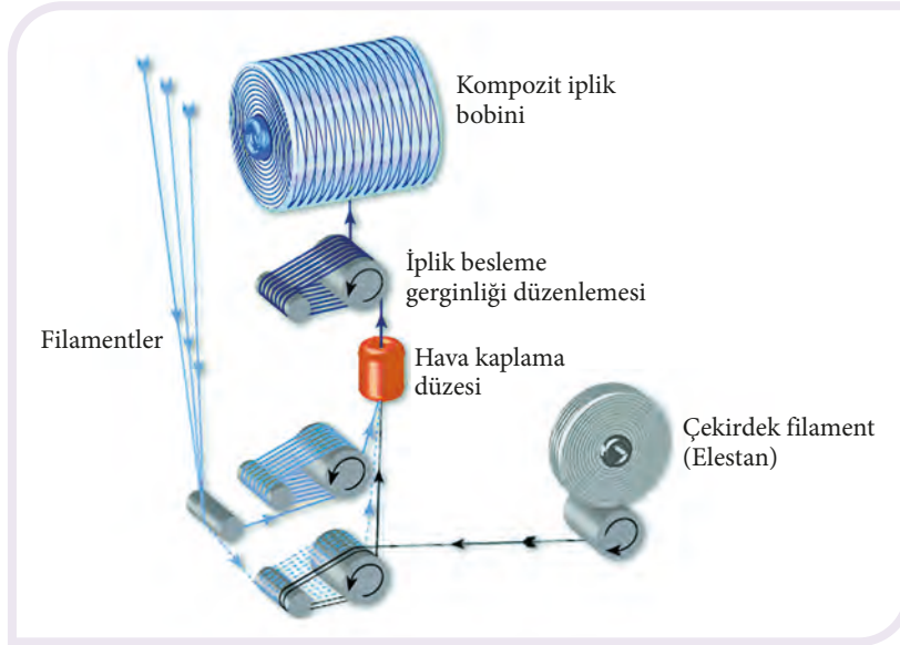
Görsel 4.6: Havalı sistem ile örtülü iplik üretimi
