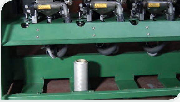
Friksiyon iplik makinesinde özlü iplik üretimi
