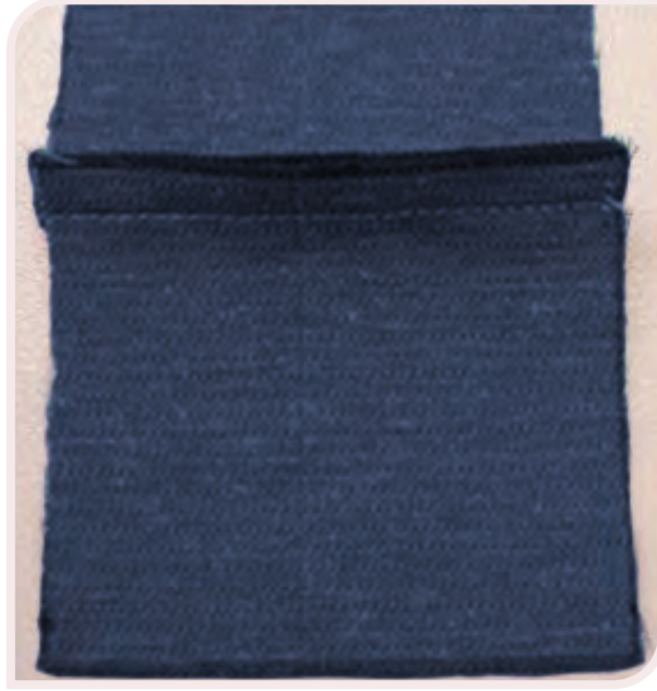
Görsel 5.23: Dikiş kayma testi için hazırlanmış numune
