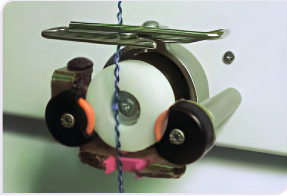
Görsel 4.19: Fashionator fantezi iplik makinesinde parafinleme işlemi
