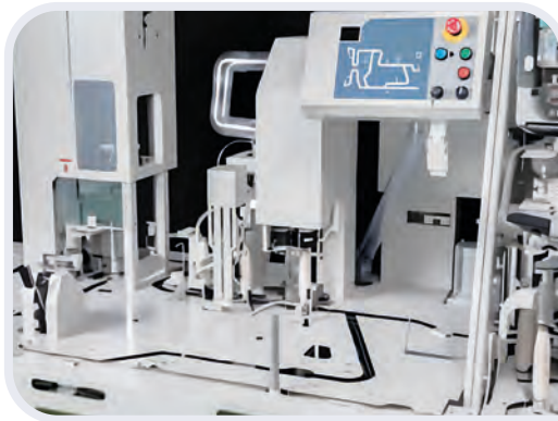
Görsel 1.42: Bobin makinesinde tray tipi besleme
