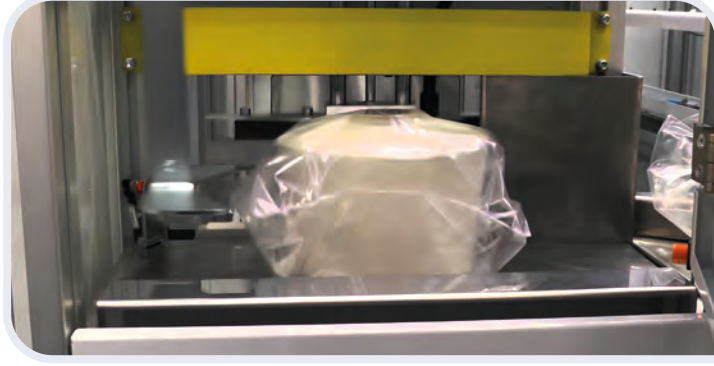
Görsel 1.53: Bobin ambalajlama makinesinde bobinlerin polietilen film tabakası ile kaplanması
