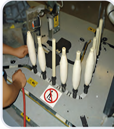
Görsel 1.38: Bobin makinesinin alt rayının temizlenmesi
