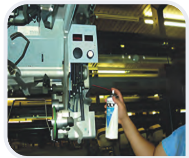
Görsel 1.34: Bobin çıkartma kolunun temizlenmesi
