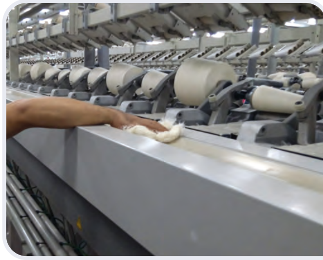
Görsel 1.30: Bobin taşıma bandının temizlenmesi
