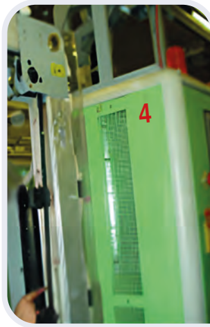
Görsel 1.37: Bobin makinesinin kops rayının temizlenmesi ve değiştirilmesi
