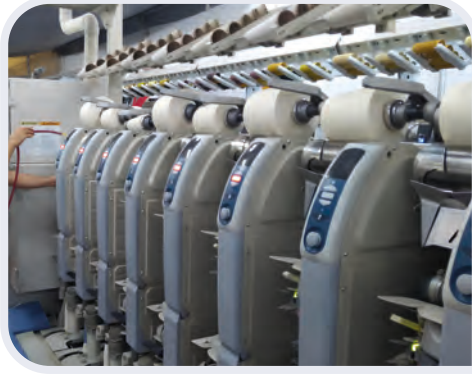
Görsel 1.35: Bobin makinesinin basınçlı hava ile temizlenmesi
