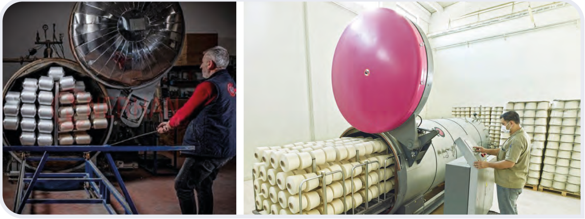
Görsel 9.6: Makineye manuel ve otomatik olarak iplik besleme
