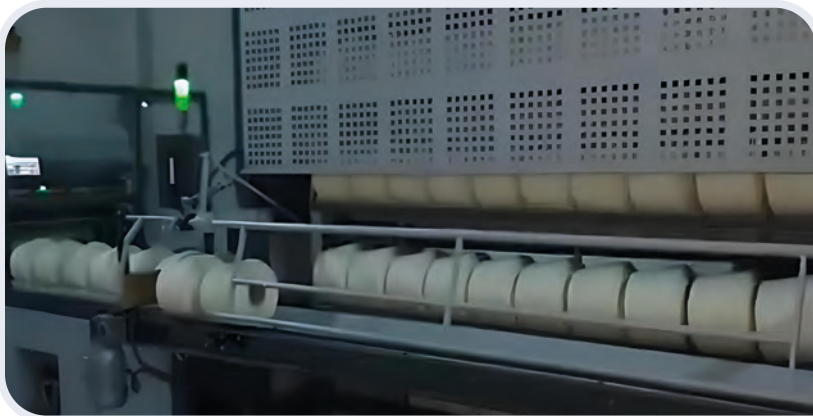
Görsel 1.52: Bobin ambalajlama makinesinde bobin besleme kısmı
