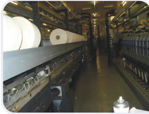
Görsel 1.39: Bobin makinesinin arka kısmının temizlenmesi
