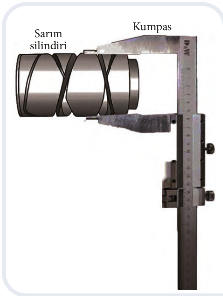
Görsel 2.6: Sarım silindirin kumpas ile çapının ölçümü
