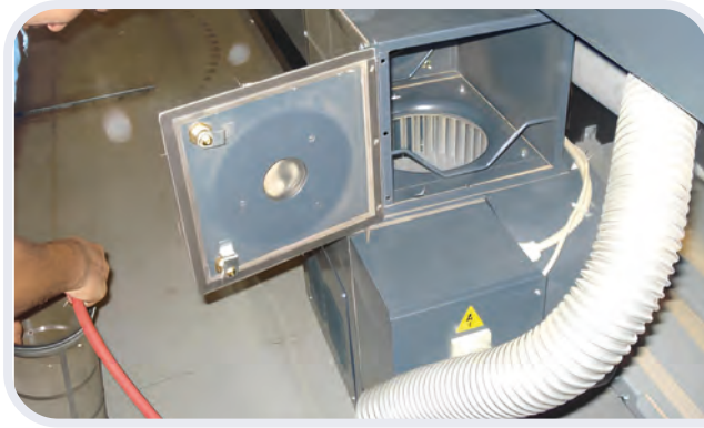
Görsel 1.36: Bobin makinesi filtresinin temizlenmesi
