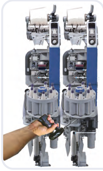
Görsel 1.28: Magazin alt aksamının elyaf toplama tabancası yardımı ile temizlenmesi
