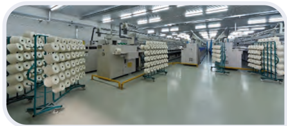
Görsel 1.57: Bobinlerin bobin arabasına yerleştirilmesi
