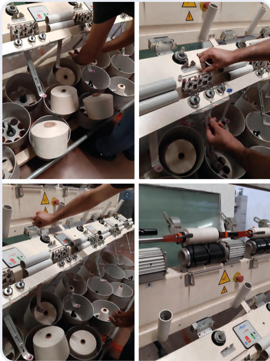
Görsel 5.7: Katlama makinesinde besleme ve üretim
