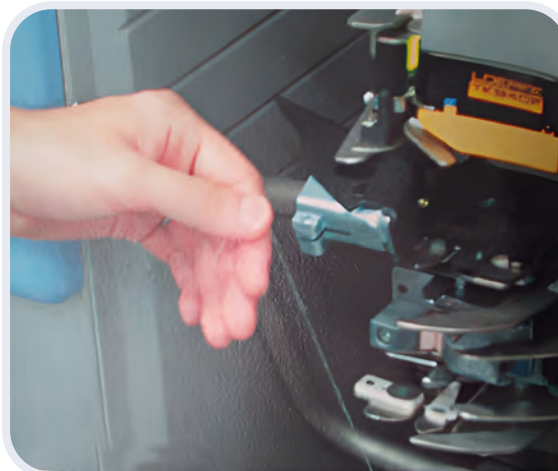
Görsel 1.45: Emiş ağzındaki iplik ucunun elle kesilmesi
