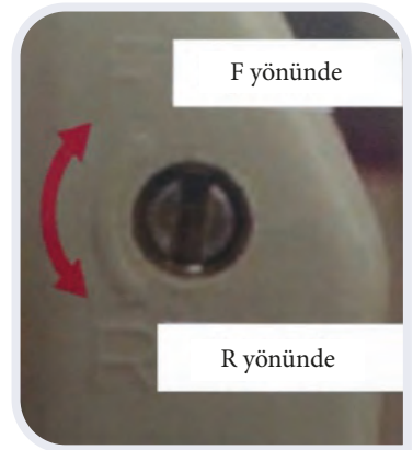
Görsel 3.12: Bal-con sensörünün ayar yönü
