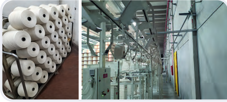
Görsel 1.51: Bobin taşıma arabası ve otomatik taşıma sistemi
