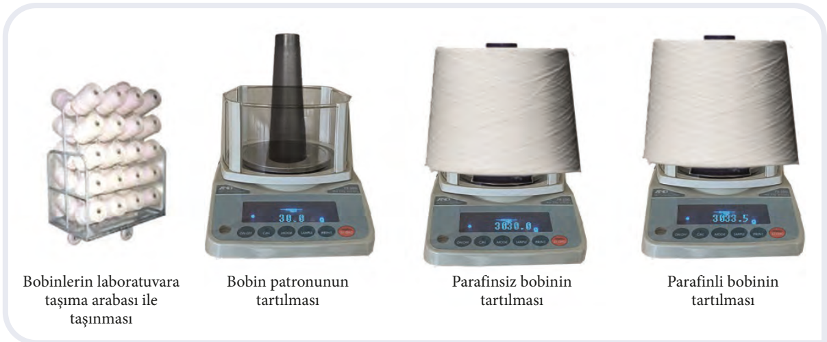
Görsel 2.11: Bobinin parafin miktarı kontrolünün yapılması
