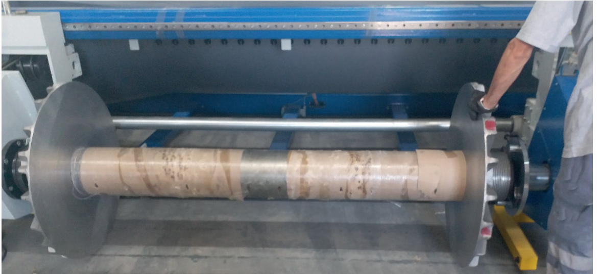
Görsel 1.50: Dokuma levendinin makineye takılması
