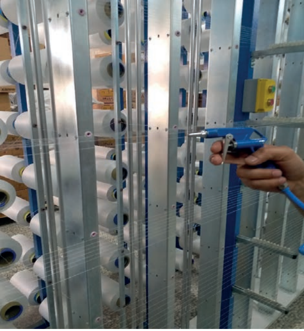
Görsel 1.60: : Çağlığın basınçlı hava ile temizlenmesi
