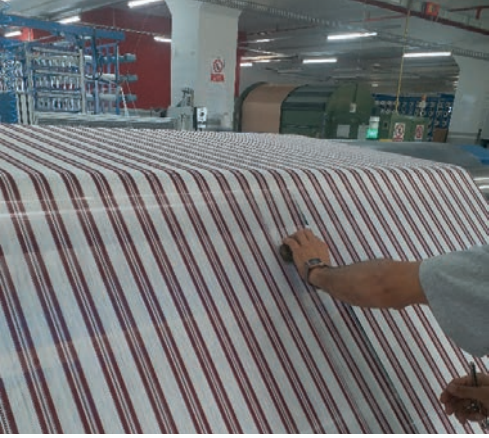
Görsel 1.56: Kopan çözügelerin bağlanması
