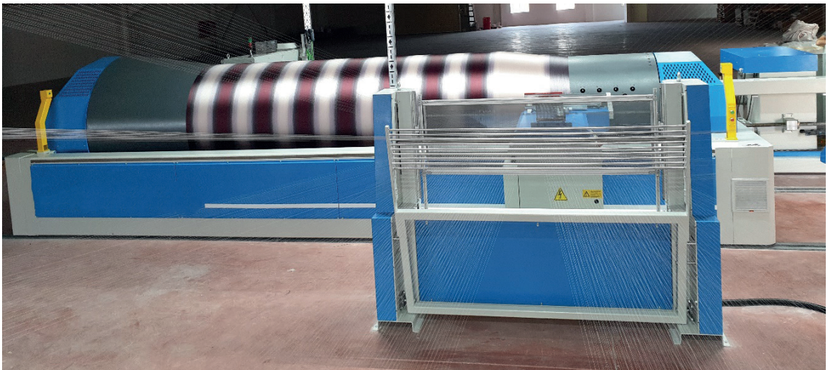
Görsel 1.15: Çapraz tarağının çözgü makinesindeki konumu
