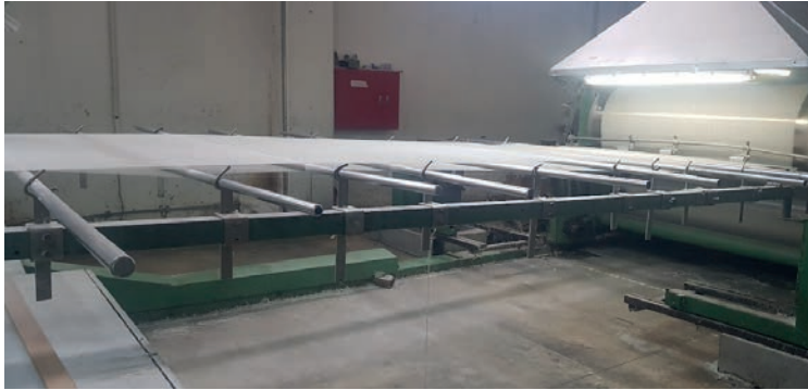
Görsel 2.14: Silindirli kurutmada çapraz çubukları
