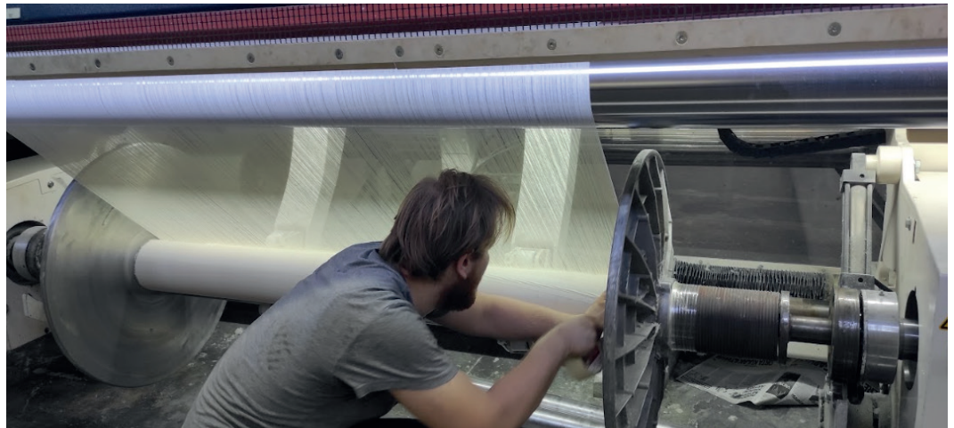
Görsel 2.46: Yeni levent başlangıcında bant atılması
