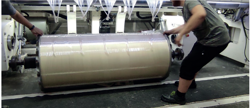
Görsel 2.43: Çözü levendinin streç filmle sarılarak çıkarılması
