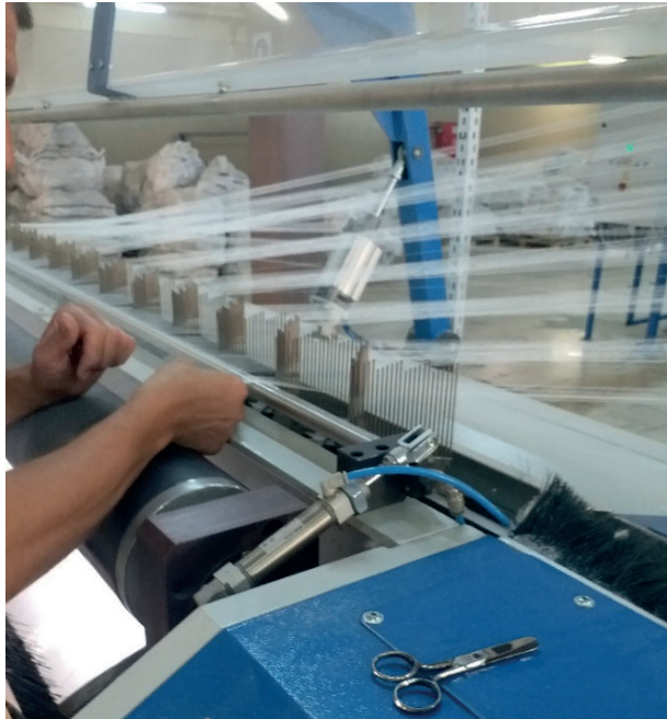
Görsel 1.84: İpliklerin toplama tarağından geçirilmesi
