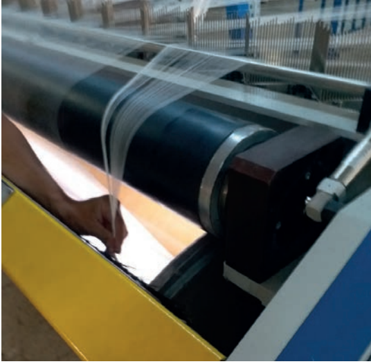
Görsel 1.85: Fazla kılavuz ipliklerin ayrılması
