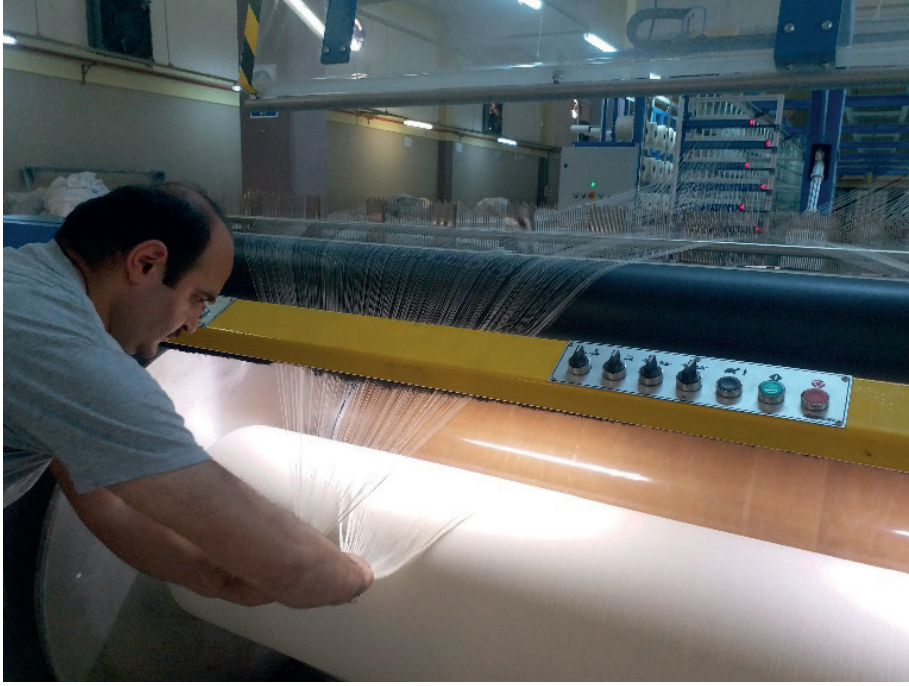
Görsel 1.100: Çözümlerin kesilerek levente bağlanması
