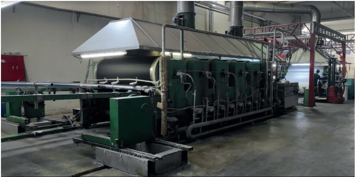
Görsel 2.12: Açık silindirli kurutma
