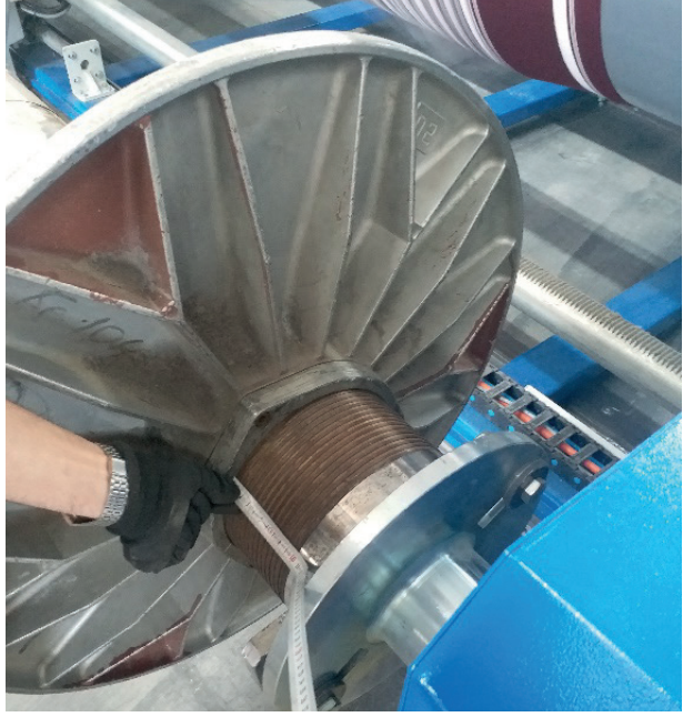
Görsel 1.52: Çözgü levent kampanalarının çözgü enine göre ayarlanması
