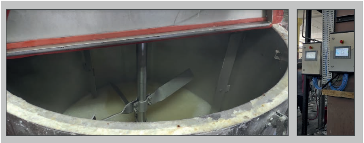
Görsel 2.26: Haşıl çözeltisinin hazırlanması ve kontrol paneli
