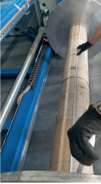
Görsel 1.51: Çözgü levent eninin ölçülmesi
