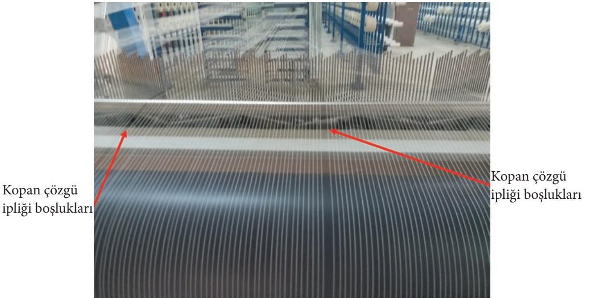
Görsel 1.89: Kopan çözgü ipliklerin yerlerinin belirlenmesi
