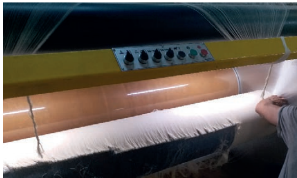
Görsel 1.92: Çözgü ipliklerinin kesilerek temizlenmesi
