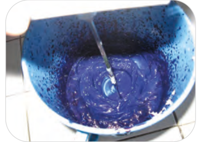
Görsel 4.6: Karıştırılmakta olan pata boyar maddenin ilavesi
