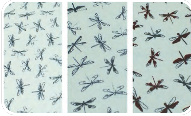
Görsel 5.19: Renklerin baskı sırasına göre basılarak desenin kumaş yüzeyinde oluşturulması
