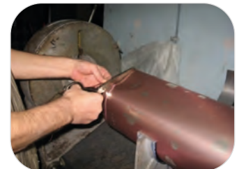
Görsel 3.44: Şablon kenar fazlalığının kesilmesi
