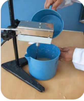
Görsel 11.2: Pat hazırlamak için karıştırma kabına su ve guar eteri konulması
