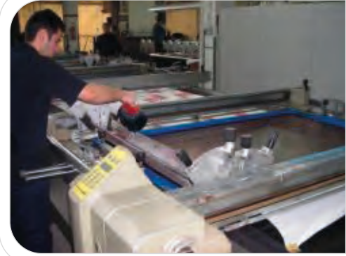
Görsel 6.8: Film-druck şablon üzerine baskı patı besleme
