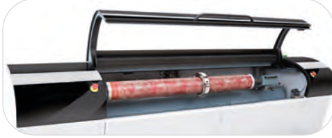
Görsel 3.23: Lazer yöntemi ile pozlandırma makinesi
