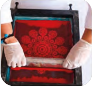
Görsel 6.13: Baskı patının kumaşa aktarılması
