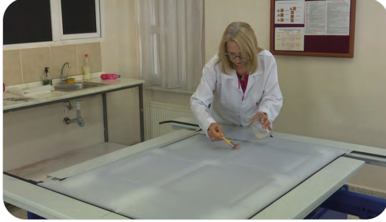
Görsel 2.9: Gaze bezinin şablon çerçevesine yapıştırılması
