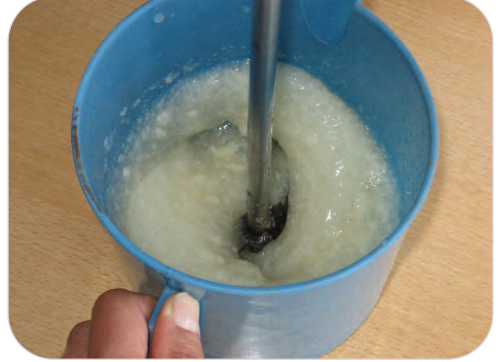
Görsel 10.2: Nişasta eterinin konsantrasyon miktarına uygun şekilde suyla 2.800 devir/dakika hızla karıştırılması
