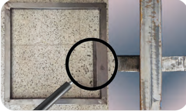
Görsel 2.5: Şablon çerçevesinin taşlanmamış ve taşlanmış görünümü
