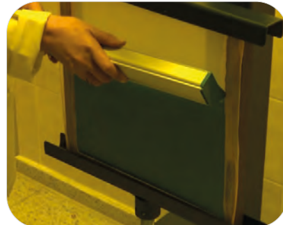
Görsel 2.20: Emülsiyonun gaze üzerine çekilmesi
