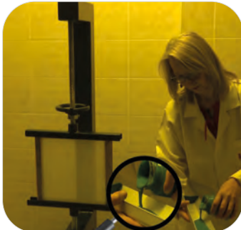
Görsel 2.19: Emülsiyonun oluklu rakleye dökülmesi
