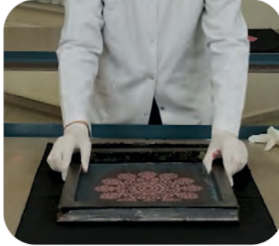
Görsel 15.20: Şablonun kumaş üzerine yerleştirilmesi
