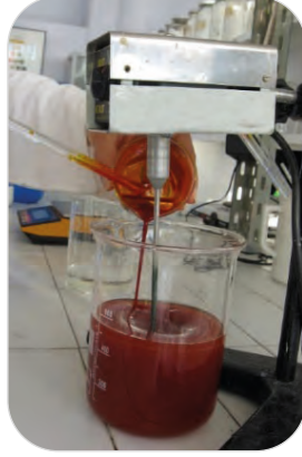
Görsel 8.10: Aktif boyar maddenin karıştırılmakta olan pata ilave edilmesi
