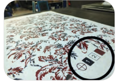
Görsel 8.18: Kalıp sırası ve aksların kumaş üzerindeki görünümü
