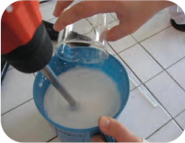
Görsel 4.4: Kıvamlaştırıcı ve suyun karıştırılarak hazırlanması
