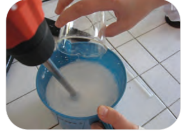
Görsel 7.5: Pata amonyak ilave edilmesi
