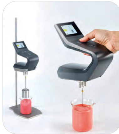
Görsel 7.6: Viskozimetreyle viskozite ölçümü
