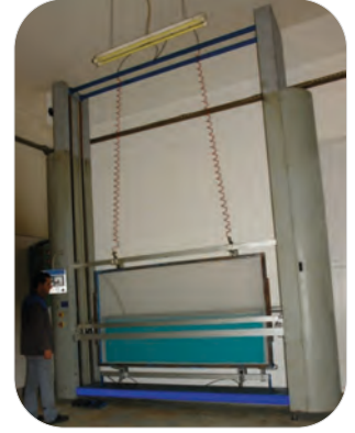
Görsel 2.12: Otomatik lak çekme makinesinde lak çekme işlemi
