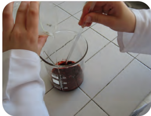
Görsel 9.4: Boyar madde, üre ve çözünmeye yardımcı maddenin ayrı bir kaptaki çözündürülmesi
