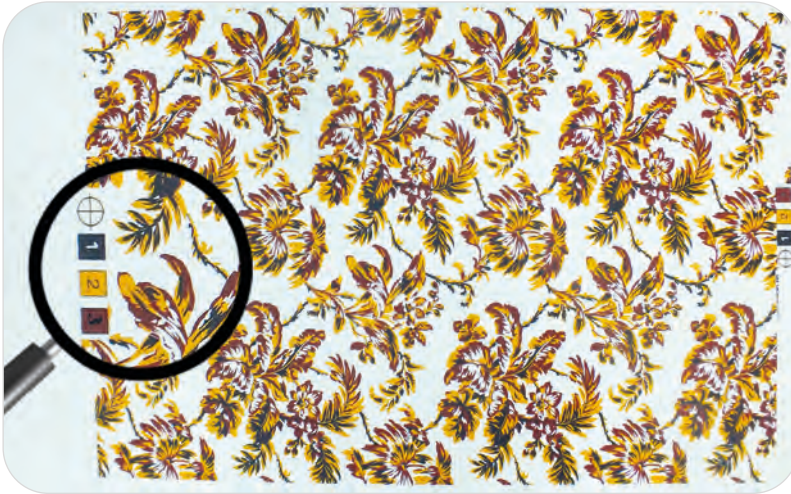
Görsel 9.9: Şablondaki desene ait aks ve renk sırasının kumaşta görünümü
