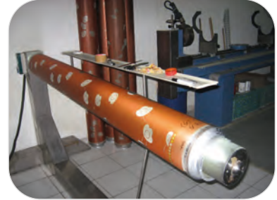
Görsel 3.37: Rötuş sehpasında rötuşlama işlemi
