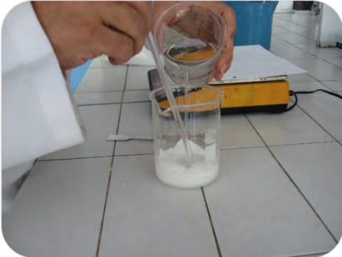
Görsel 10.3: Alkalinin ayrı bir kapta suyla çözündürülmesi
