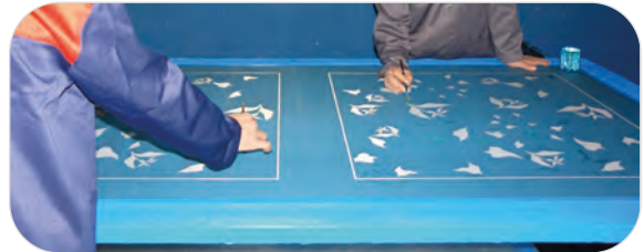
Görsel 2.30: Kapatarak şablonun rötuşlanması
