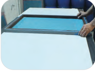
Görsel 5.17: Baskı kalıbının kumaş üzerine yerleştirilmesi
