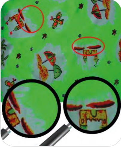
Görsel 5.22: Kirlenme (kalıp sırası) hatası
