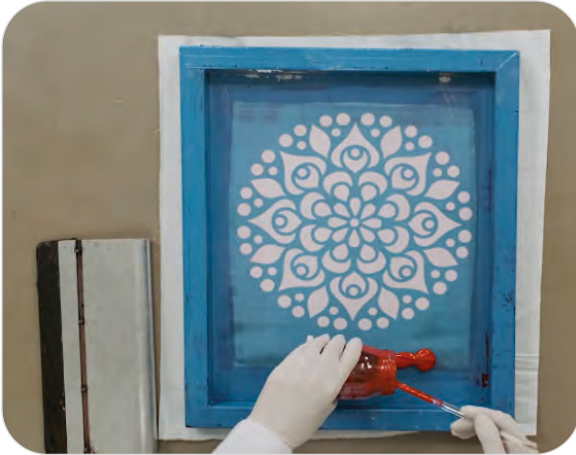
Görsel 7.9: Şablon pat garaj alanına baskı patının dökülmesi
