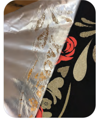
Görsel 16.19: Aşındırma-varak kombinasyon baskısında varak kâğıdının dikkatlice çıkartılması
