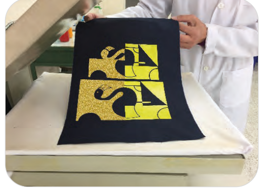
Görsel 16.5: Elde edilen varak-plastik baskı kombinasyonu örneği
