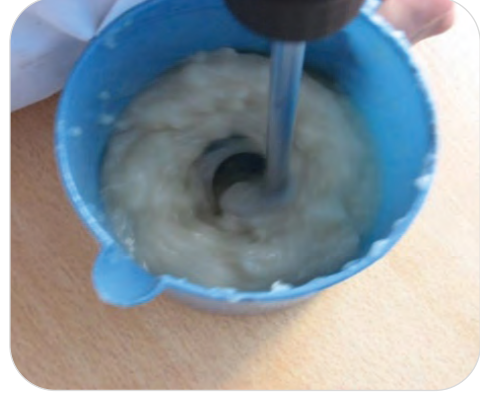
Görsel 11.3: Karıştırma kabındaki su ve guar eterinin karıştırılması
