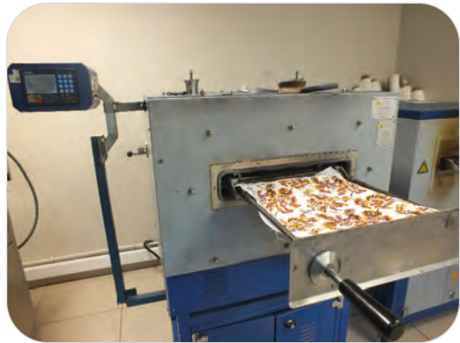
Görsel 9.10: Fikse makinesinde direkt boyar maddelerle yapılan baskının fiksesi
