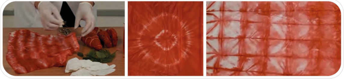
Görsel 15.11: Kumaştaki bağlı ipliklerin makasla kesilmesi ve elde edilen batık desenleri
