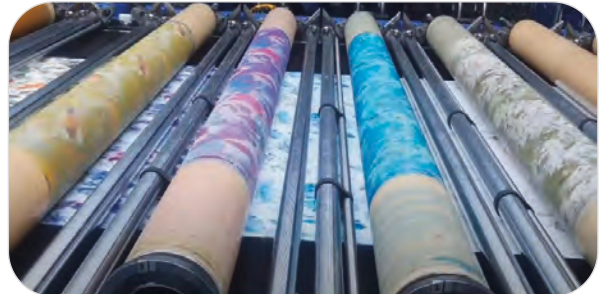
Görsel 6.18: Baskı patının kumaşa aktarılması
