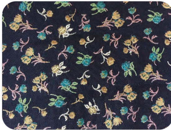
Görsel 10.8: Küp boyar maddelerle tek adımlı baskıda oksidasyon ve yıkama işleminden sonra meydana gelen renk değişimi
