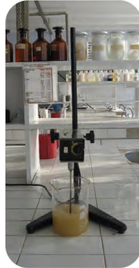
Görsel 8.4: Alginatın suyla karıştırılarak hazırlanması
