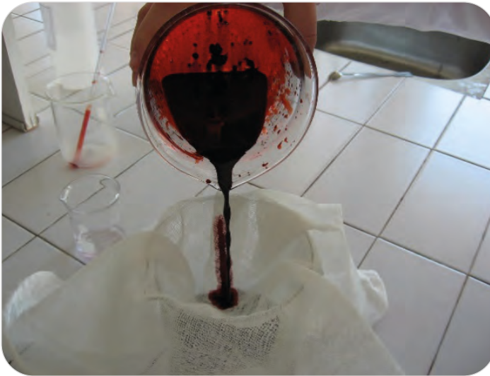
Görsel 9.6: Boyar madde ve boyar maddeyle birlikte hazırlanan kimyasal maddelerin süzülerek kıvamlaştırıcıya ilave edilmesi
