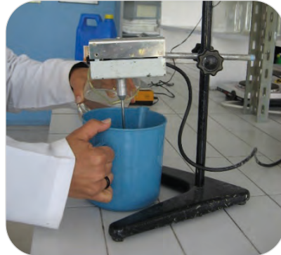
Görsel 10.4: Alkalinin karıştırılmakta olan kıvamlaştırıcıya ilave edilmesi
