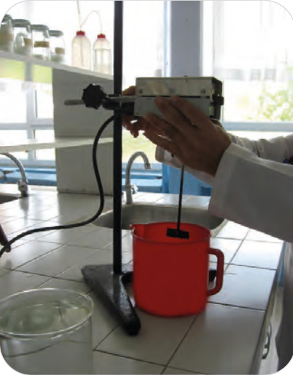
Görsel 8.3: Alginat ve suyu karıştırmak için mikserin hazırlanması
