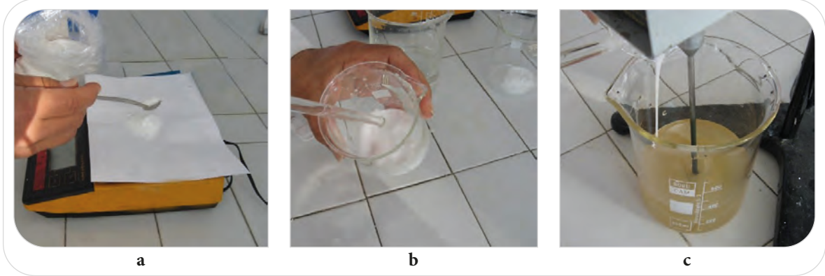
Görsel 8.5: a) Reaktif boyar madde baskı patı için soda ve sodyum bikarbonatın tartılması, b) Ayrı bir beherde çözündürülmesi, c) Soğutulmuş çözeltinin pata ilavesi
