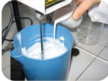
Görsel 4.5: Karıştırılmakta olan pata kimyasal maddelerin ilavesi
