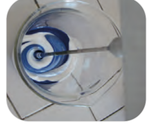
Görsel 4.11: Ana pat ve açma patının karıştırılması
