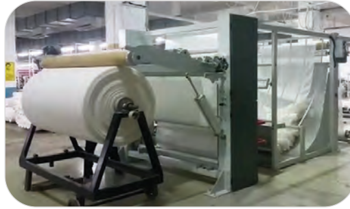
Görsel 1.28: Ham kumař açma makinesinde ham kumař açma (dok)
