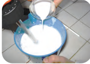
Görsel 7.4: Pata binder ilave edilmesi
