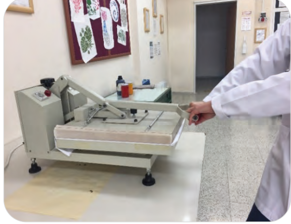
Görsel 15.4: Varak kâğıdının el presinde preslenmesi
