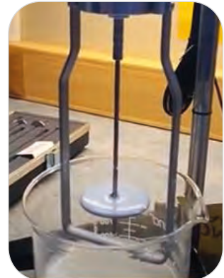
Görsel 13.3: Patın viskozite ölçümü
