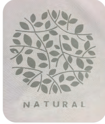
Görsel 15.15: Devore (yakma) baskı patının kumaş üzerinde görünümü
