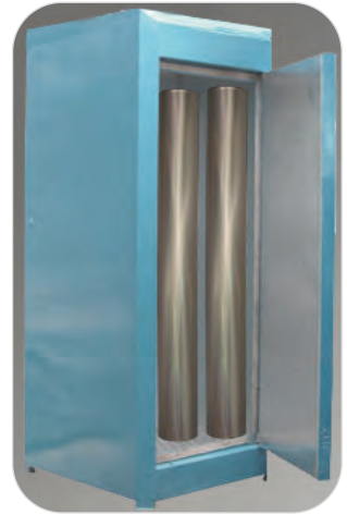
Görsel 3.11: Şablonların polimerizasyon dolabına yerleştirilmesi
