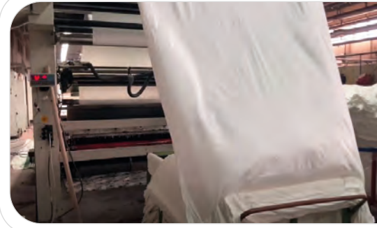
Görsel 6.15: Kumaşın makineye beslenmesi
