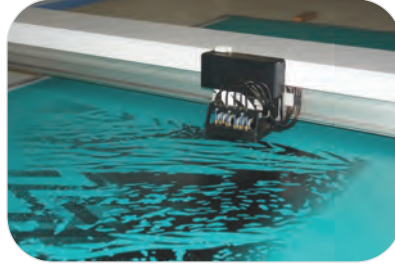
Görsel 2.22: Mürekkep püskürtmeyle desen bilgisayardan şablona aktarılması
