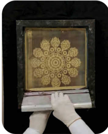
Görsel 15.22: Baskı patının rakleyle ileri geri sıyrılarak baskı işleminin gerçekleştirilmesi
