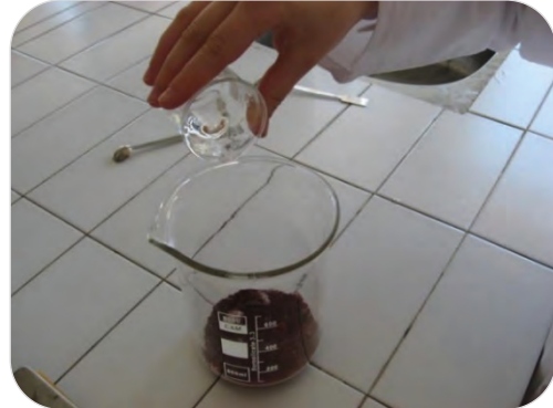
Görsel 11.5: Üre ya da tiyoüre beraberliğinde tiyoetilen glikol ve suyla boyar maddenin çözüldürülmesi
