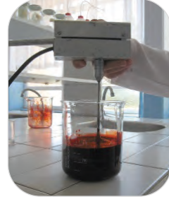
Görsel 11.9: Renkli patın mikserle karıştırılması
