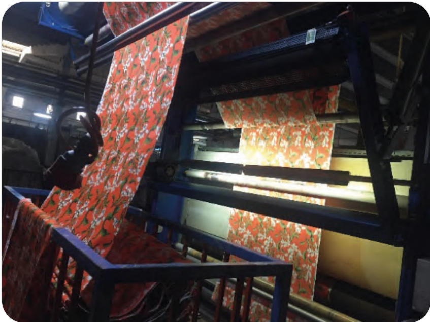
Görsel 14.5: Baskılı kumaşın fikse makinesinden çıkışı
