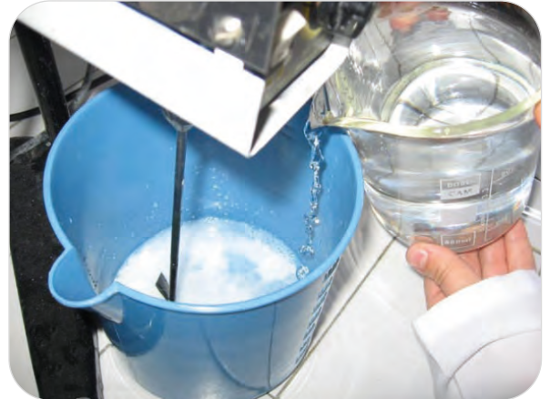
Görsel 7.2: Su ve kıvamlaştırıcının birbiri içinde karıştırılması
