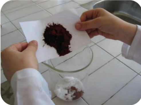
Görsel 11.4: Üre ya da tiyoüre beraberliğinde tiyoetilen glikol ve boyar maddenin ayrı bir kaba alınması
