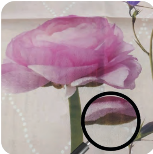
Görsel 5.28: Kalıp tıkanıklığı hatası
