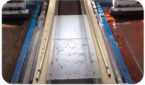
Görsel 6.10: Baskı patının kumaşa aktarılması
