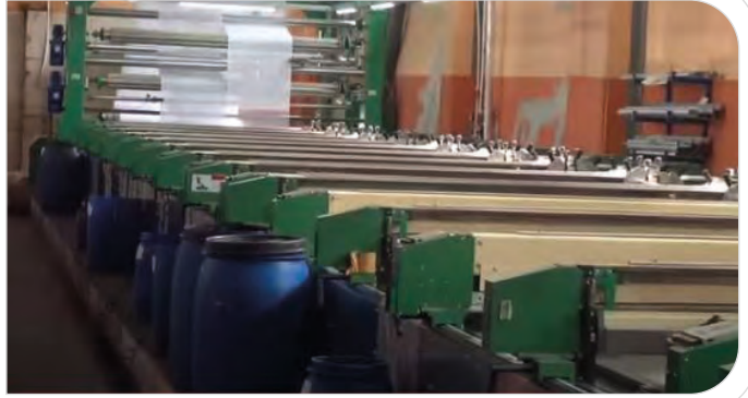
Görsel 6.8: Film-druck şablon üzerine baskı patı besleme
