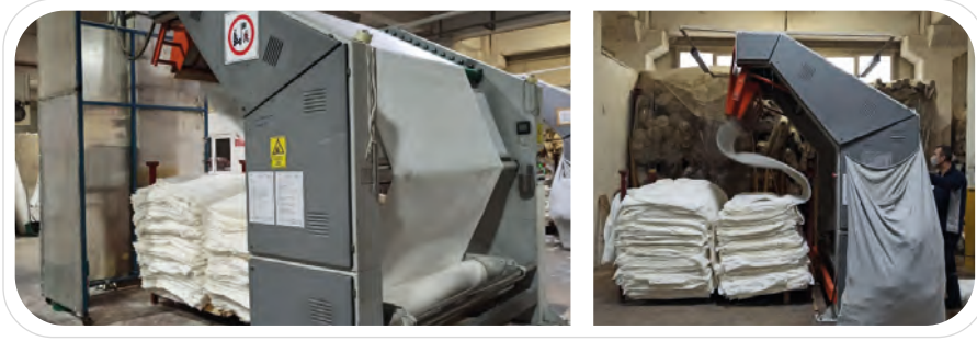
Görsel 1.27: Ham kumař açma makinesinde ham kumař açma (katlama)
