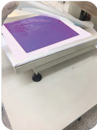
Görsel 16.15: Varak kâğıdının yapıştırıcı bulunan yere yerleştirilmesi
