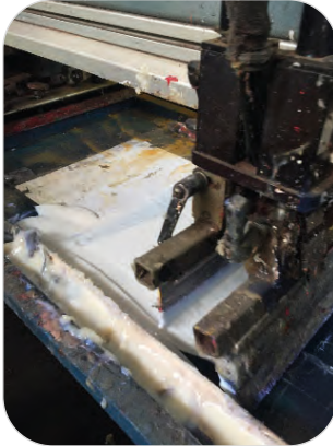
Görsel 16.10: Flok yapıştırıcısının şablondan kumaşa aktarılması
