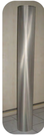
Görsel 3.10: Germe halkası takılarak yuvarlak hâle getirilen şablon
