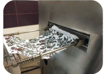
Görsel 8.19: Numune fikse makinesinde reaktif baskı fiksesi
