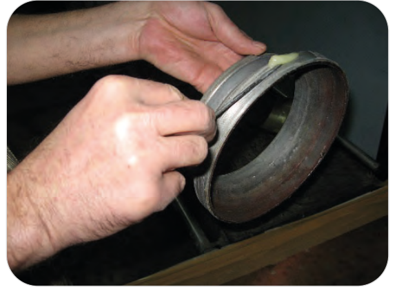
Görsel 3.41: Yapıştırıcının şablon kafasına sürülmesi
