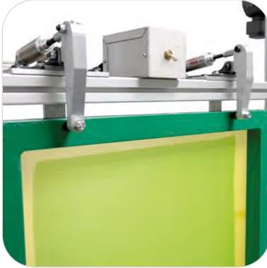
Görsel 2.14: Şablonun otomatik lak çekme makinesine sabitlenmesi
