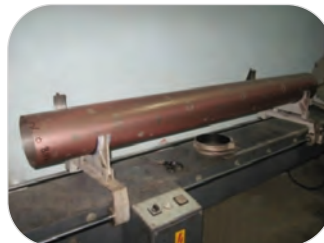
Görsel 3.43: Şablonun kafa takma sehmasına yerleştirilmesi
