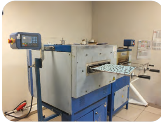
Görsel 5.20: Numune baskı kurutma ve fikse
