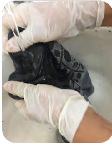
Görsel 15.16: Fikse işleminden sonra yapılan yıkama işlemi
