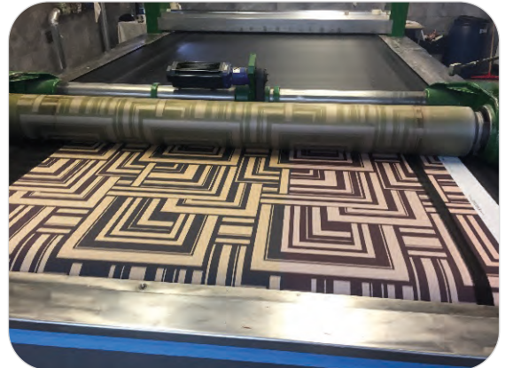
Görsel 5.7: Rotasyon numune baskı makinesi
