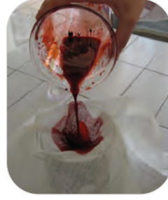
Görsel 11.7: Boyar maddenin süzülerek pata ilave edilmesi
