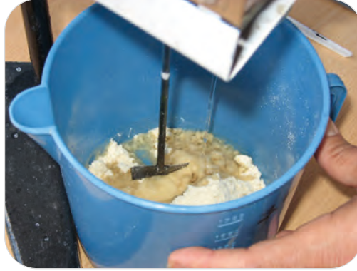
Görsel 9.2: Nişasta eterinin karıştırma kabında mikserle karıştırılması
