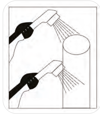
Şekil 3.2: Lak çekme öncesi yıkanan şablonun durulanması
