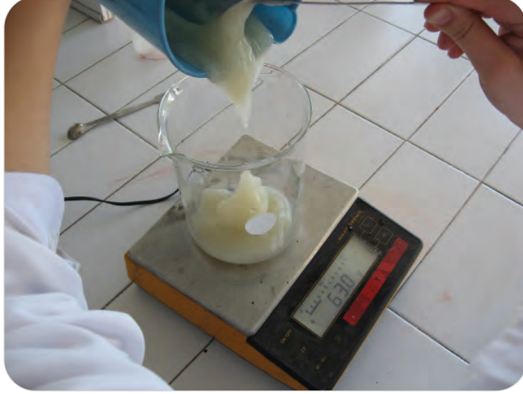
Görsel 9.5: Kıvamlaştırıcının reçetede belirtilen miktarda tartılması
