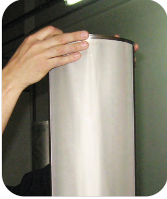
Görsel 3.8: Şablona germe halkalarının takılması
