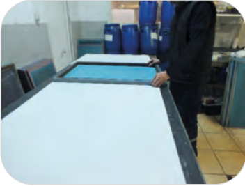
Görsel 8.16: Kumaşın kırışksız olarak baskı masasına serilmesi
