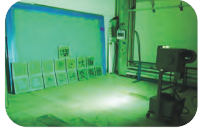
Görsel 2.23: Şablonların dikey pozlandırma makinesinde pozlandırılması
