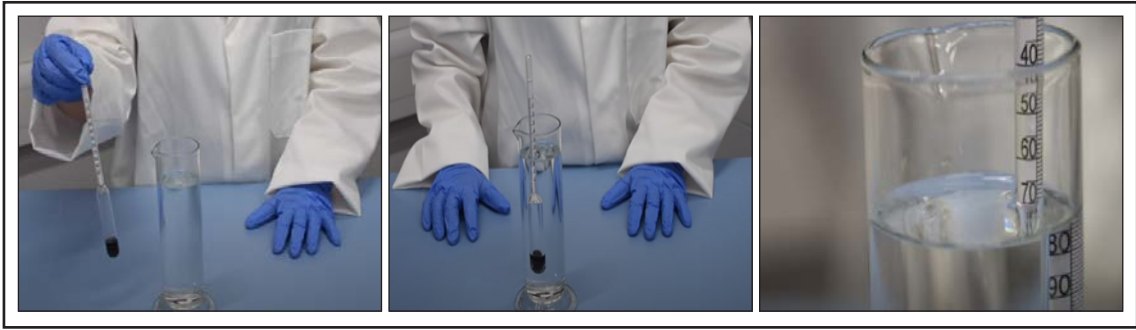
Görsel 4.3: Dansimetre ile sıvının yoğunluk ölçümü
