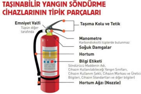
Görsel 1.11: Yangın söndürme tüpü
