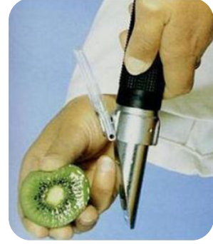
Görsel 6.14: Refraktometre ile hasat zamanı tayini
