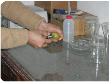
Görsel 6.13: Penetrometre ile meyve eti sertliğinin ölçümü
