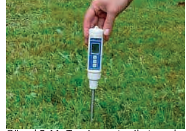
Görsel 5.11: Tansiyometre ile toprak neminin ölçülmesi
