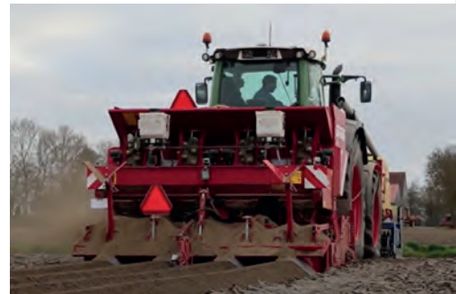
Görsel 6.59: Otomatik beslemeli patates dikim makinesi
