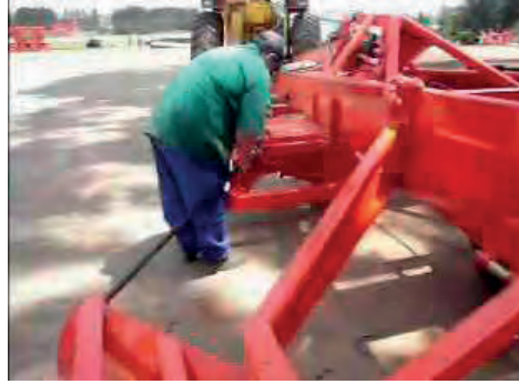
Görsel 6.17: Land Planenin bıçak bağlantı kollarının takılması
