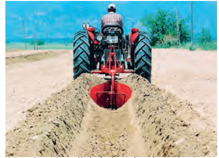
Görsel 5.40: Pulluk ile kanal açılması
