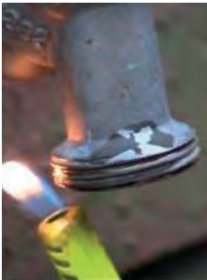
Görsel 5.36: Musluğun ağzının numune alma öncesi ateş ile sterilizasyonu
