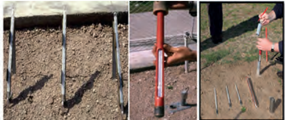
Görsel 1.4: 5, 10, 20, 50 ve 100 cm derinlikte toprak sıcaklığı ölçme
