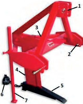
Görsel 6.31: Sabit işleyici organa sahip dip kazanının parçaları
