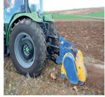
Görsel 3.5: Tarlada bulunan taşları taş kırma makinesi ile kırma
