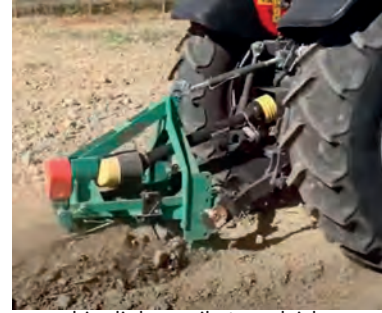
Görsel 6.22: Titreşimli organa sahip dipkazan ile toprak işleme
