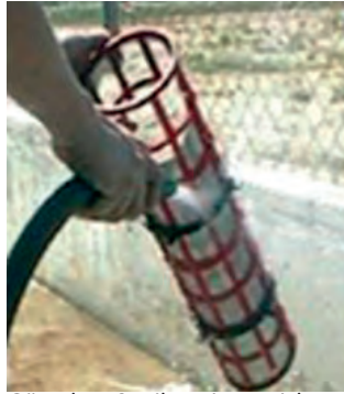
Görsel 5.72: Filtrenin temizlenmesi
