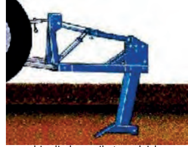
Şekil 6.3: Sabit işleyici organa sahip dip kazan ile toprak işleme
