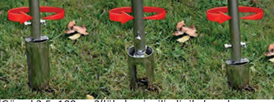
Görsel 2.5: 100 cm 3 'lük demir silindir ile bozulmamış toprak numunesi alma
