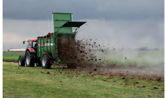
Görsel 4.13: Çiftlik gübresinin makine ile dağıtılması
