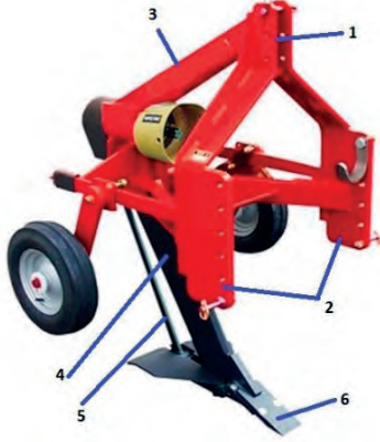
Görsel 6.32: Titreşimli işleyici organa sahip dip kazanın parçaları
