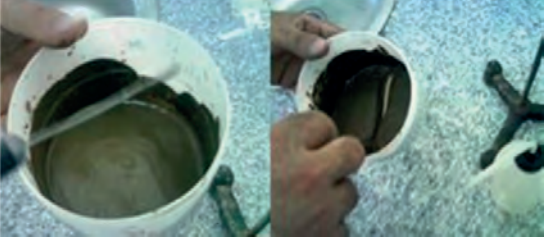
Görsel 2.14: Büret ile ölçülü su katılmış toprağın spatülle karıştırılması
