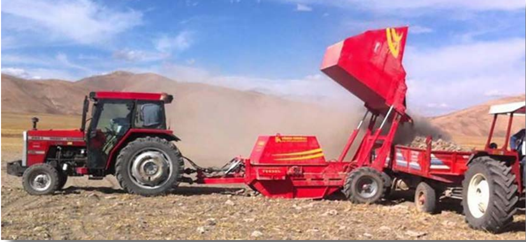
Görsel 1.5: Çekilir tip elevatörlü taş toplama makinelerinin boşaltılması
