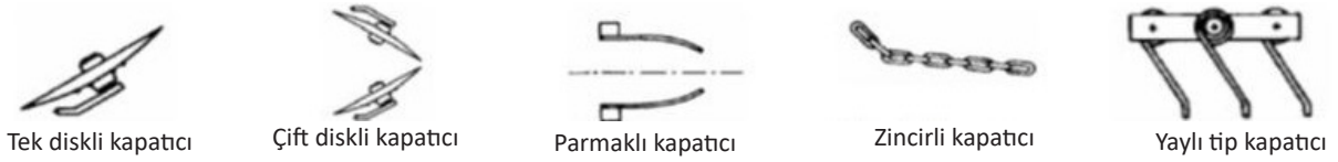
Görsel 2.27: Tohum üzeri kapama için kullanılan farklı düzenler
