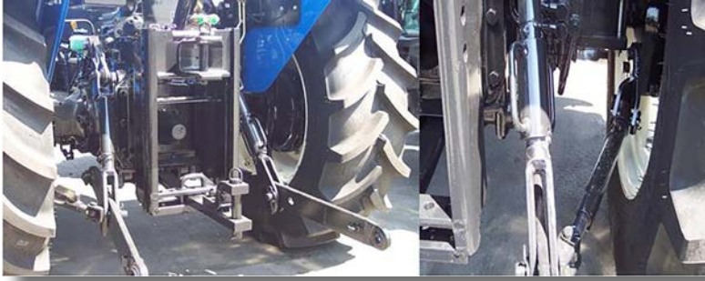
Görsel 1.38: Traktör yan bağlantı kollarındaki ayar yerleri
