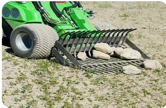
Görsel 1.3: Kovalı tip taş toplama makinesiyle taş toplama işlemi
