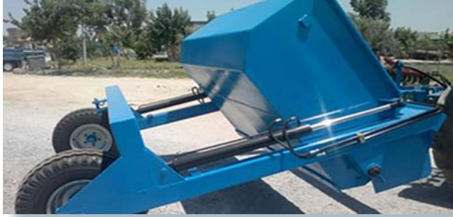
Görsel 1.24: Hidrolik skreyperin boşaltılması
