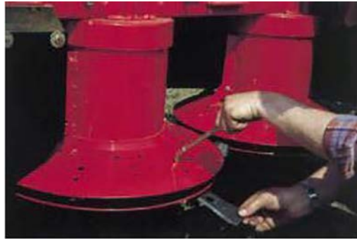
Görsel 3.9: Bıçakların özel aparat yardımı ile değiştirilmesi
