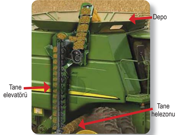
Görsel 1.42: Tane elevatörünün çalışması
