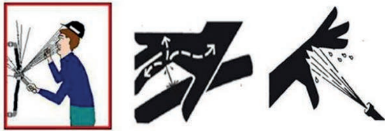
Görsel 1.53: Hidrolik yağı sızıntısı tehlikesi
