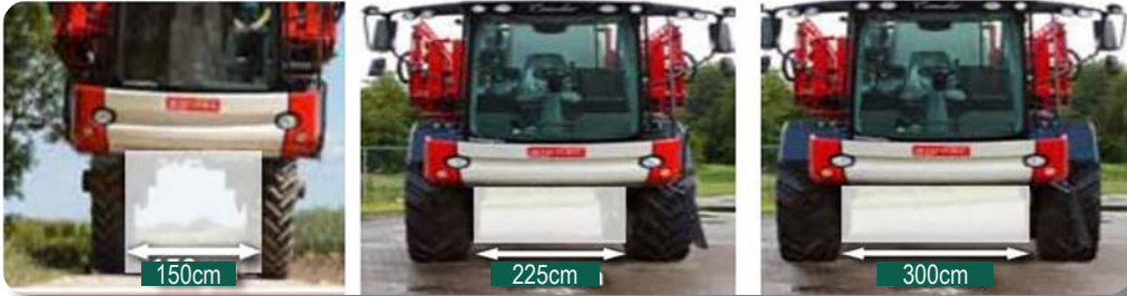
Görsel 3.14: Kendi yürür bitki koruma makinelerinin iz genişliği
