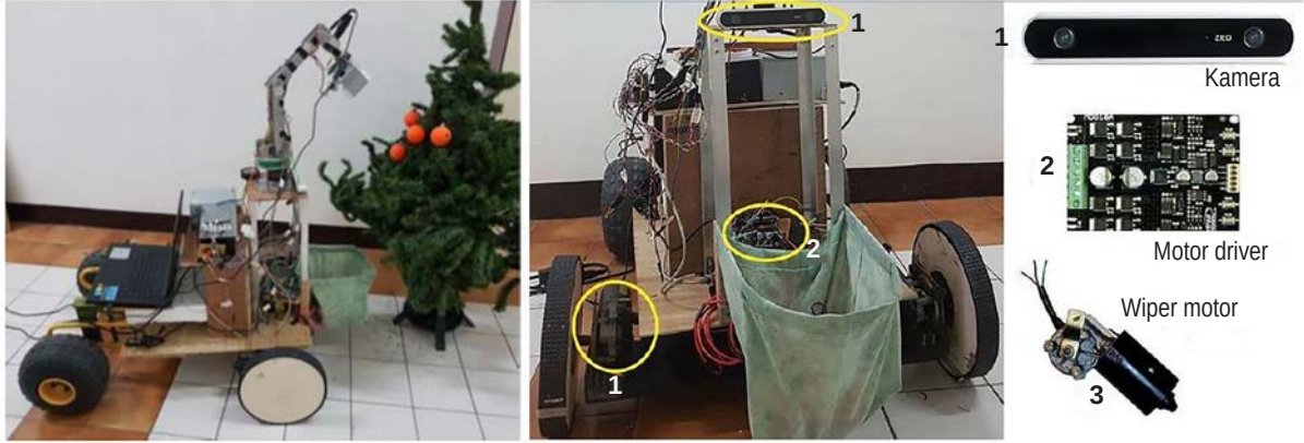
Görsel 2.10: Otonom hasat robotu ve robotun bazı parçaları
