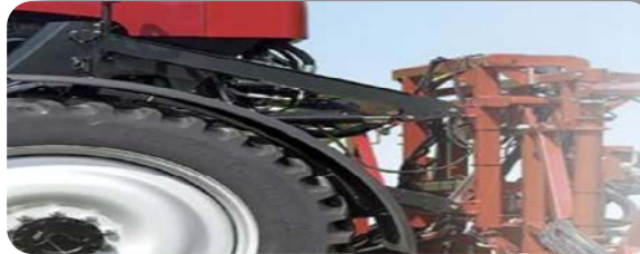
Görsel 3.16: Püskürtme boomunun yüksekliğini ayarlayan hidrolik sistem
