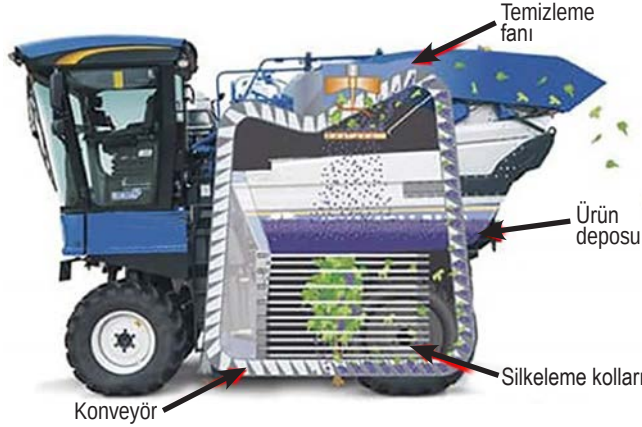
Görsel 2.8: Zeytin ve üzüm hasat makinesi üniteleri
