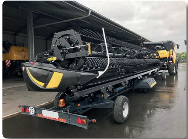
Görsel 1.48: Biçerdöver tablasının karayolunda taşınma durumu
