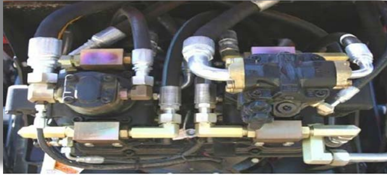
Görsel 3.7: Tekerlekleri hareket veren hidrostatik pompalar
