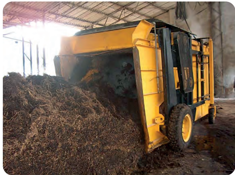
Görsel 1.38: Kompostun makine ile aktarılması
