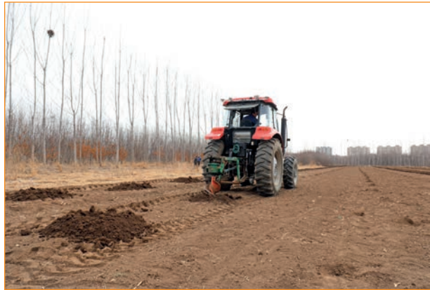
Görsel 2.12: Traktörle fidan çukurlarının açılması
