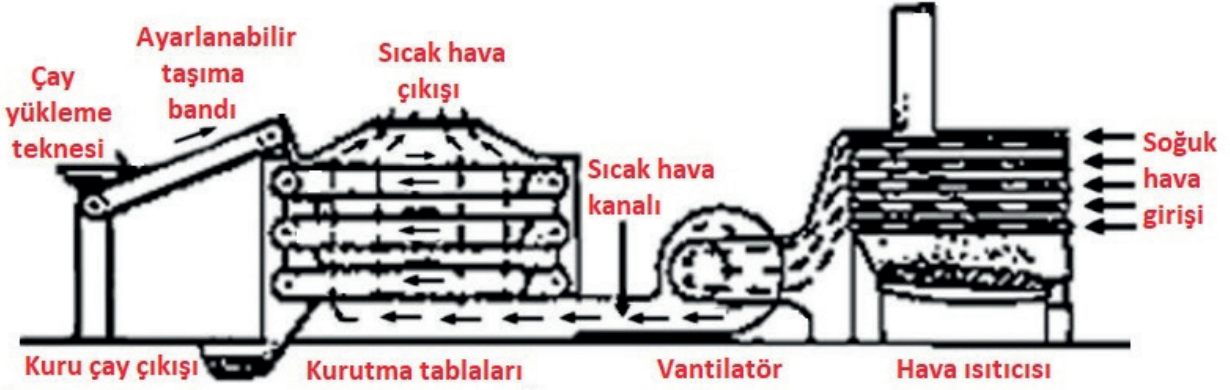
Görsel 4.15: Çay kurutma fırınının çalışma şeması
