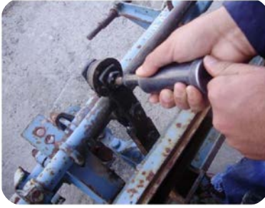
Görsel 1.14: Bağlama çatısının yataklarının greslenmesi
