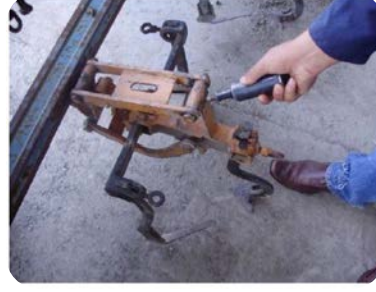
Görsel 1.15: Bağlantı muylularının greslenmesi
