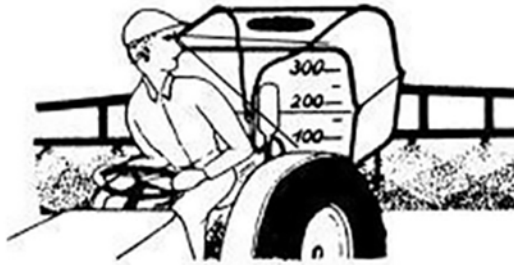
Görsel 2.12: Depo üzerindeki sıvı göstergesi
