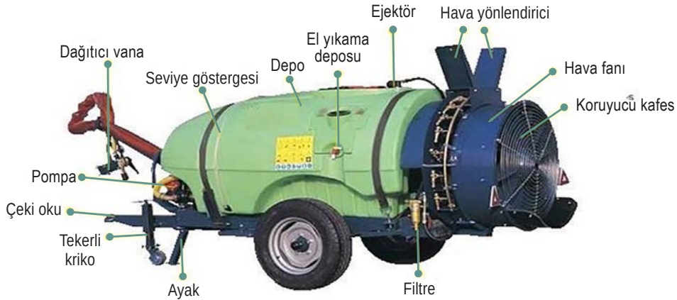
Görsel 2.41: Çekilir tip atomizörün parçaları
