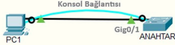
Görsel 1.36: Konsol bağlantısıyla Telnet yapılandırması
