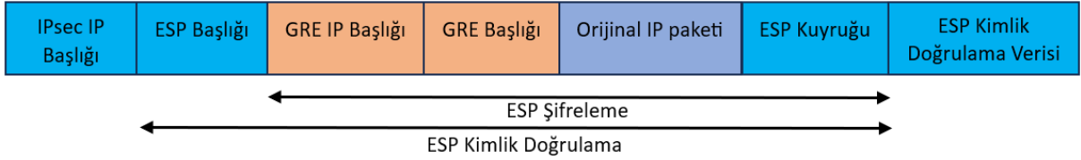
Görsel 4.22: Tünel modu IPsec VPN üzerinden GRE IP tüneli paket yapısı
