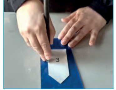
Görsel 4.157: Elması kalıbın kenarına dayayıp cam kesme
