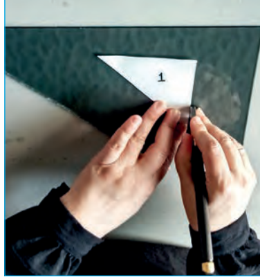
Görsel 4.134: Kalıbı camın üzerine yapıştırarak kesme
