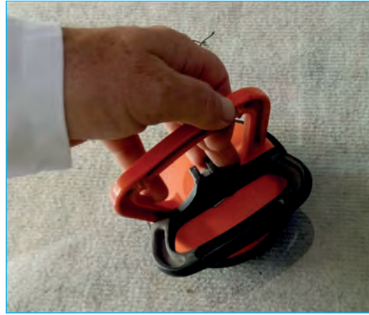
Görsel 4.38: Tekli vantuzun yapıştırılması
