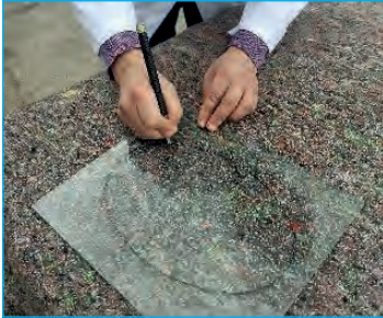
Görsel 4.144: Kesilen camın fazlalıklarının kesilmesi
