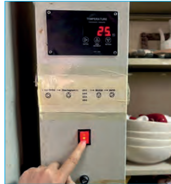
Görsel 5.43: Fırını düğmesinden açma
