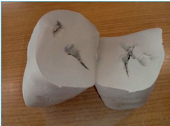
Görsel 1.90: Havası çıkarılmamış çamur kesiti
