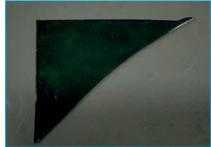
Görsel 4.180: Çapaklı kırılmış cam kenarı
