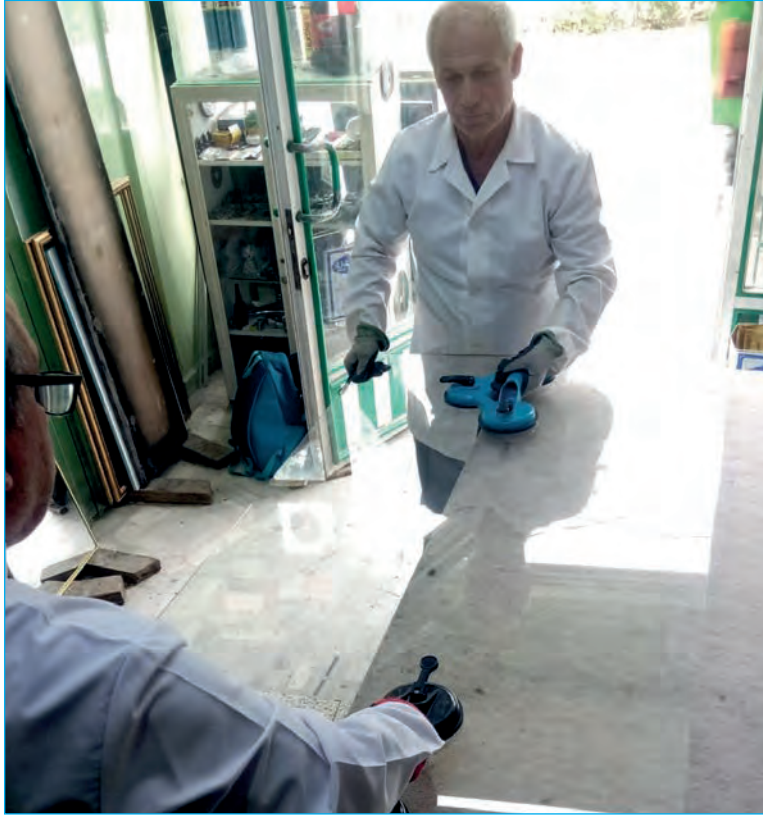
Görsel 4.61: İki kişinin vakumlu tutma araçlarıyla camı tezgâha yerleştirmesi
