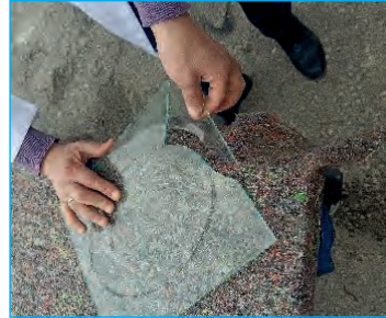
Görsel 4.145: Kesilen camın elle bükülerek kırılması
