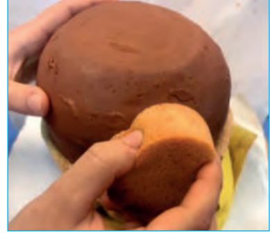
Görsel 2.123: Formun dışının nemli sünger ile düzeltilmesi
