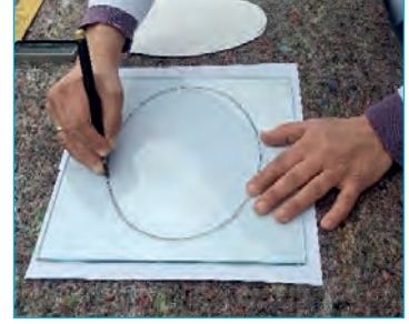
Görsel 4.143: Kalıba uygun cam kesimi
