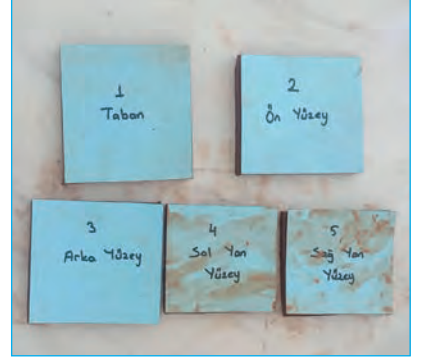
Görsel 3.35: Kalıpla kesilmiş plaka yüzeyler
