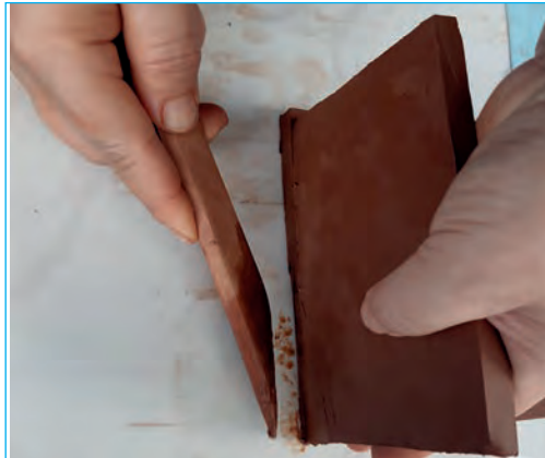
Görsel 3.48: Taban ile ön yüzeyi dıştan kaynaştırma
