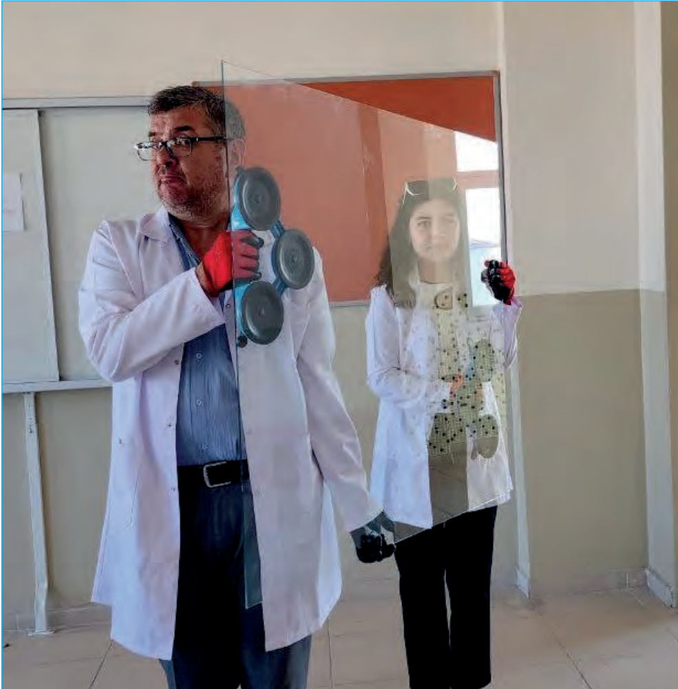
Görsel 4.50: Çapraz yapışmış vakumlu tutma aracıyla camın taşınması
