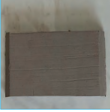
Görsel 3.75: Tabak yüzeylerinin köşelerinin 45 derece açılı kesilmesi
