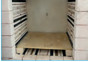
Görsel 5.33: İlk rafın yerleştirilmesi
