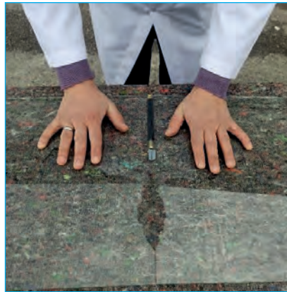
Görsel 4.140: Kesilen camın altına elmas koyup kırma
