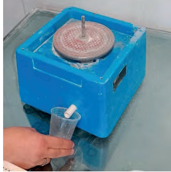
Görsel 4.205: Rodaj makinesinin haznesindeki kirli suyu tahliye etme
