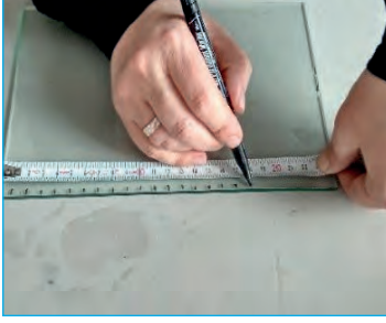
Görsel 4.147: Cama şerit kalınlıklarının işaretlenmesi
