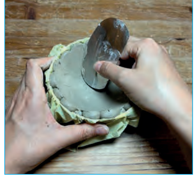
Görsel 1.159: Kâsenin iç yüzeyini sistre ile düzeltme
