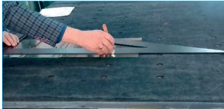
Görsel 4.100: Üçgen gönye ile cam kesimi
