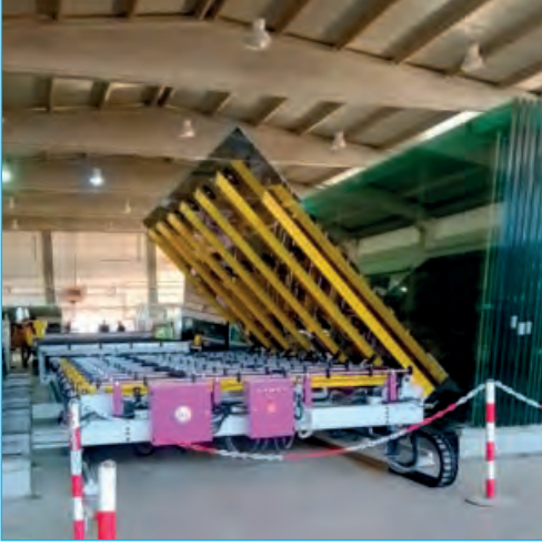
Görsel 4.51: Bilgisayarlı makinede camı vantuzla tezgâha yerleştirme
