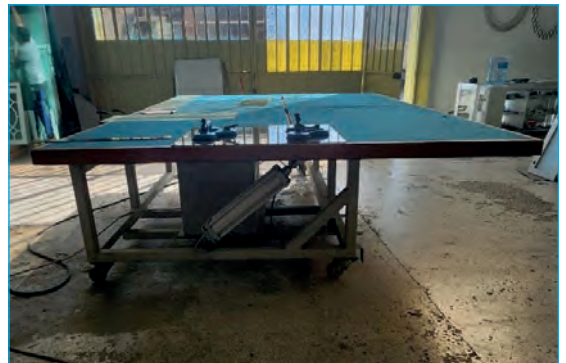
Görsel 4.54: Yüksekliği ayarlanabilen cam kesme masası
