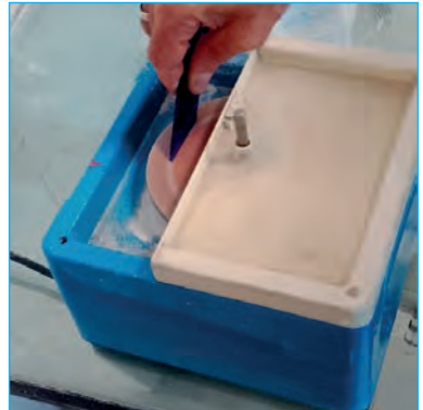
Görsel 4.200: Düz cam kenarının rodajlanması
