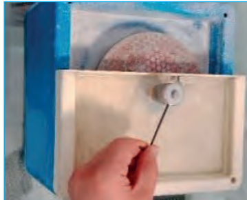
Görsel 4.202: Taşlama diskinin vidasını açma
