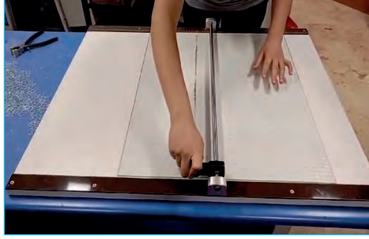
Görsel 4.164: Tablalı köprülü şerit kesici ile cam kesimi
