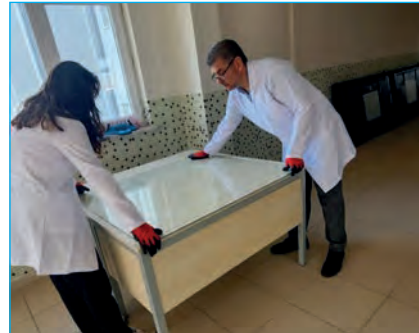
Görsel 4.60: İki kişinin camı tezgâha yerleştirilmesi
