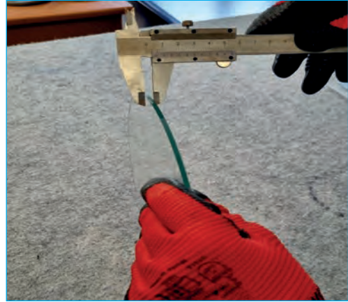
Görsel 4.68: Kumpas ile cam kalınlığını ölçme
