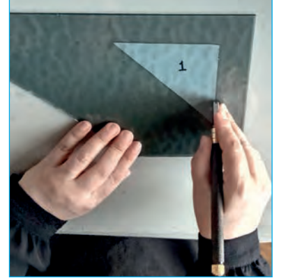
Görsel 4.135: Kalıbı camın altına koyup kesme
