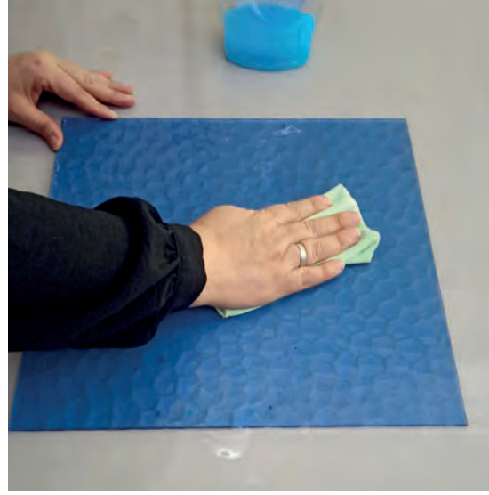
Görsel 4.207: Camın silinerek temizlenmesi ve kurutulması
