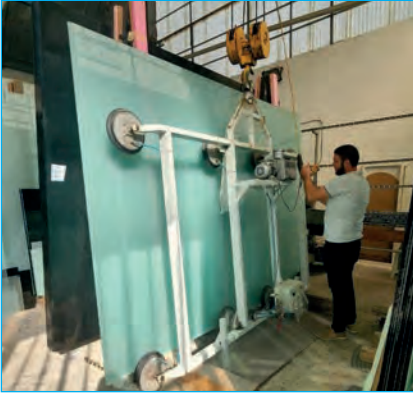
Görsel 4.31: Vinçle bağlı vantuzlu cam tutma ve taşıma aracı
