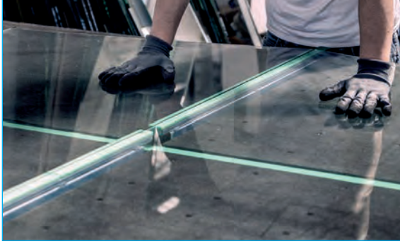
Görsel 4.112: Kesilen çizginin altına yükseltmek için cam kırma
