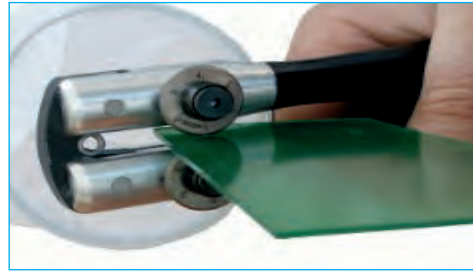
Görsel 4.121: Zagzag pense ile cam kesimi
