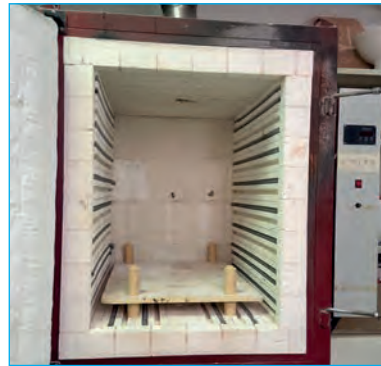
Görsel 5.27: Raf ayaklarının yerleştirilmesi
