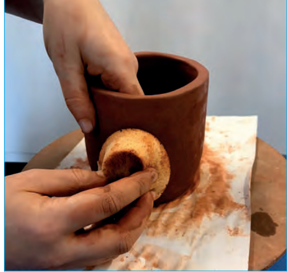
Görsel 2.41: Formun yüzeyinin nemli süngerle düzeltilmesi
