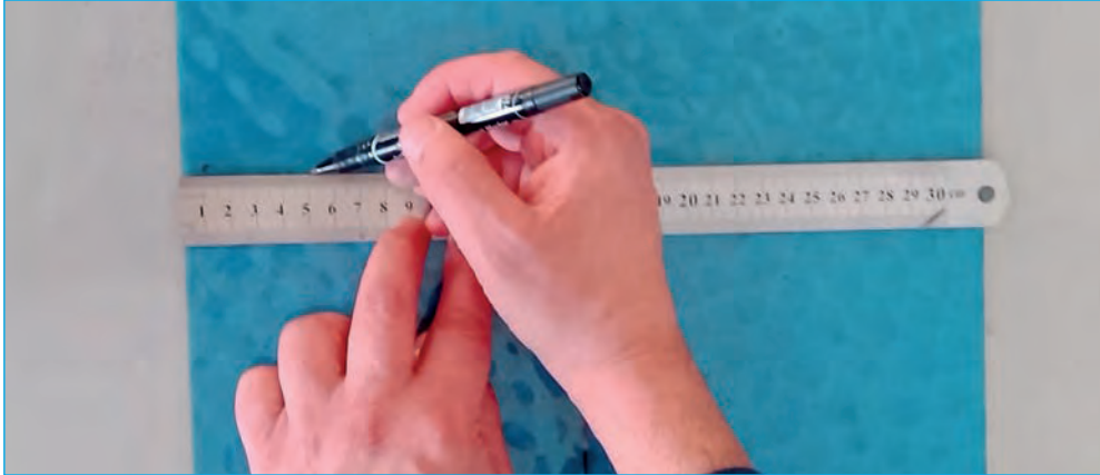
Görsel 4.70: İşaret kalemi ile cam ölçüsünü işaretleme
