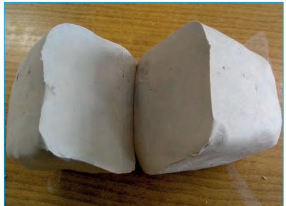
Görsel 1.91: Şekillendirilmeye hazır çamur kesiti
