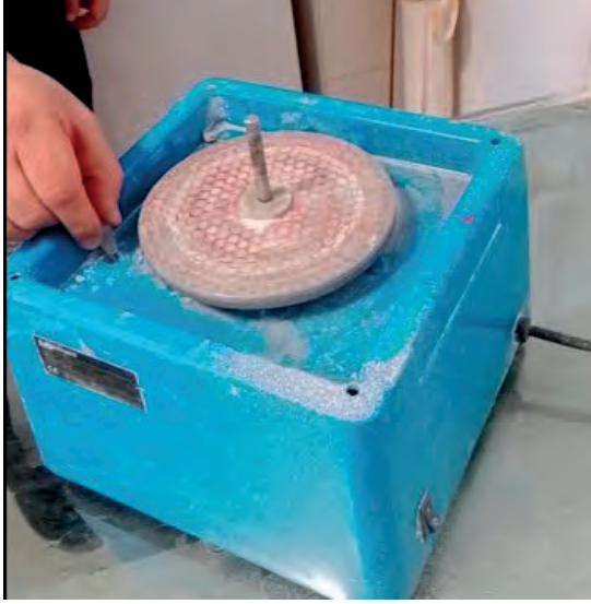
Görsel 4.204: Rodaj makinesinin haznesinin kapağını açma
