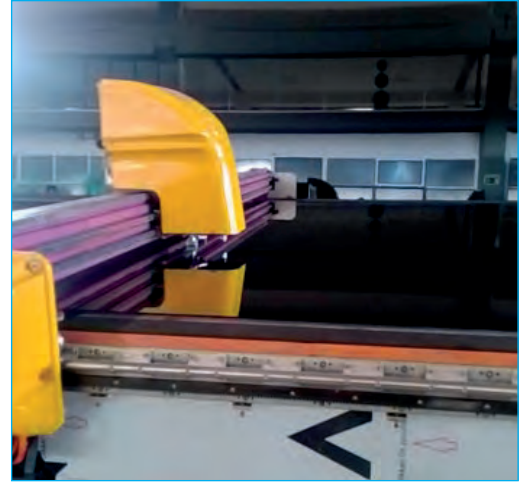
Görsel 4.126: CNC makinesi ile cam kesimi
