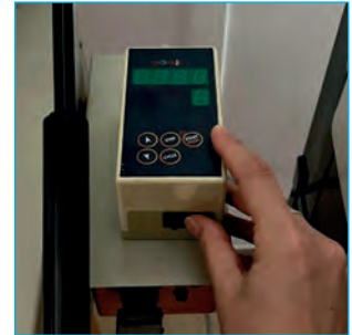
Görsel 5.85: Fırını düğmesinden açma
