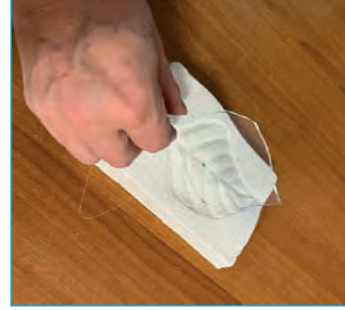
Görsel 5.74: Camı kalıba yerleştirme
