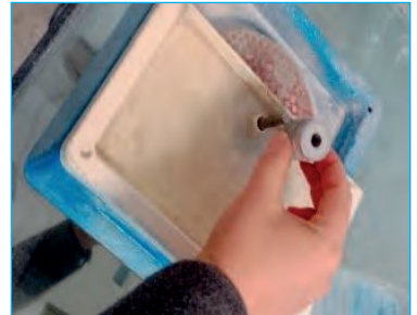
Görsel 4.203: Taşlama diskinin çıkarılması
