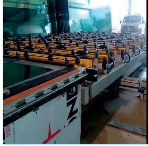
Görsel 4.52: Bilgisayarlı makinede camı makaralar ile kesim masasına taşıma
