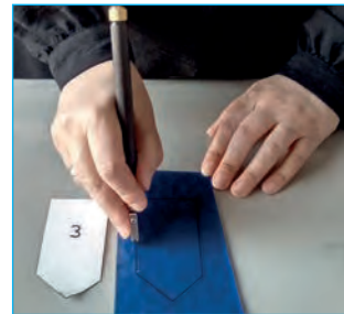
Görsel 4.154: İşaret çizgisi üzerinden cam kesme
