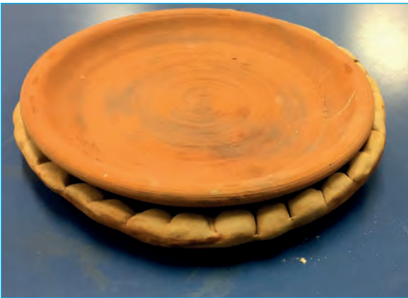
Görsel 1.176: Tabağın kalıptan çıkarılması
