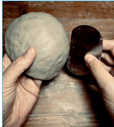
Görsel 1.124: Sistre ile kâsenin dışının düzeltilmesi
