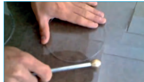
Görsel 4.123: Çatlatma topuzu ile camı çatlatma
