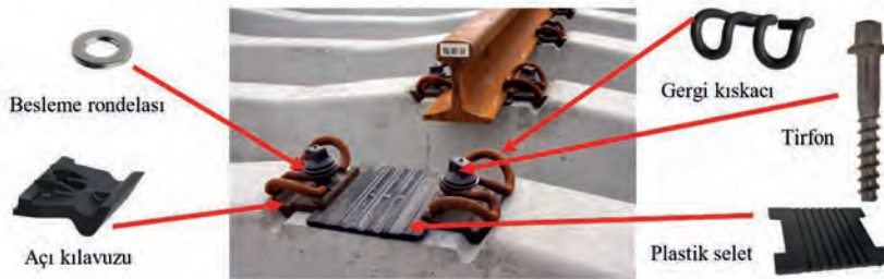
Görsel 3.20: HM tipi bağlantı malzemeleri
