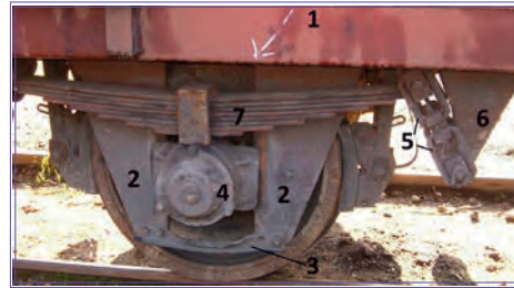
Görsel 5.54: Tekerlek takımını şasiye bağlayan parçalar
