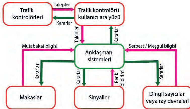
Şema 4.1: Anlaşman sistemi çalışma prensibi
