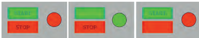
Görsel 4.27: Başlatma ve durdurma işlemlerinin operatör panelden gözlenmesi
