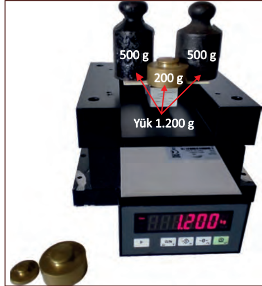
Görsel 1.36: Yük hücresinin tartım terminaline bağlanarak çalıştırılması ve farklı ağırlıkların ölçülmesi
