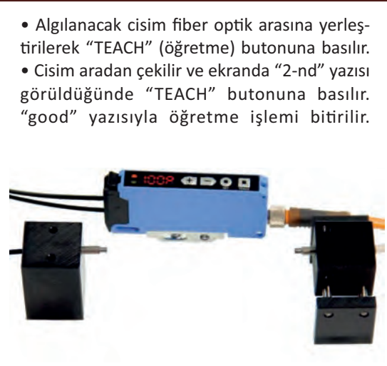
c) Sensör verici ve alıcı değerlerini ayarlama
