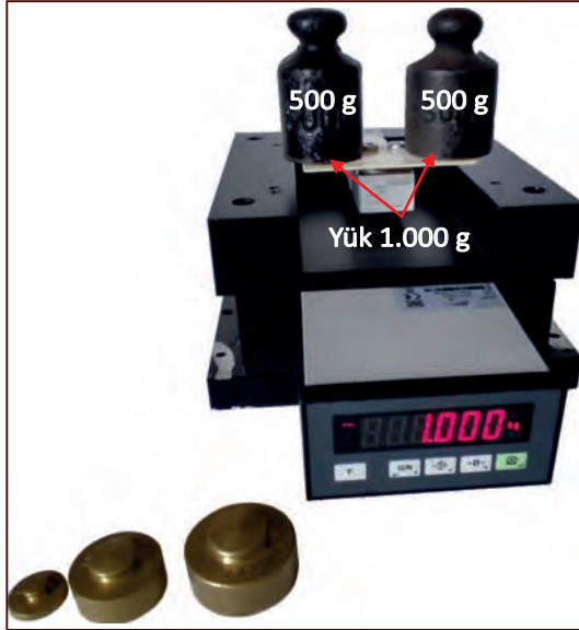
Görsel 1.36: Yük hücresinin tartım terminaline bağlanarak çalıştırılması ve farklı ağırlıkların ölçülmesi
