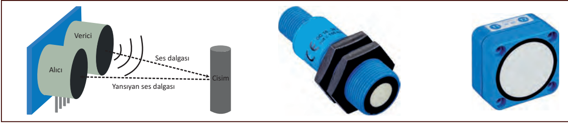
Görsel 1.37: Ultrasonik sensörün yapısı ve çalışması
