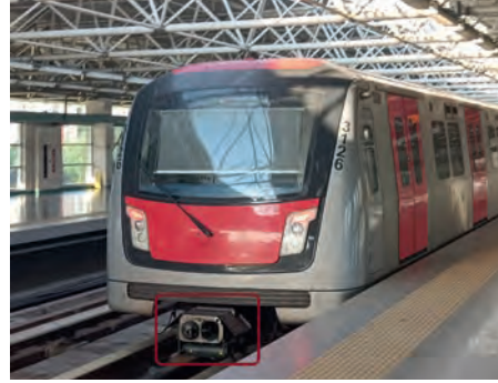
Görsel 7.31: Otomatik kuplaj sistemi
