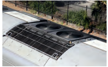
Görsel 7.35: Klima ünitesi
