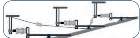
Şekil 3.13: Orta nokta ankraji
