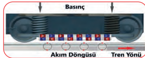
Şekil 7.8: Manyetik raylı frenleme
