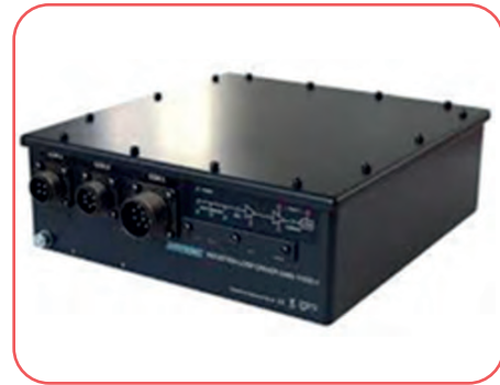
Görsel 7.39: İndüksiyon döngü sistemi
