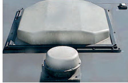
Görsel 7.10: Araç üstü iletişim antenleri
