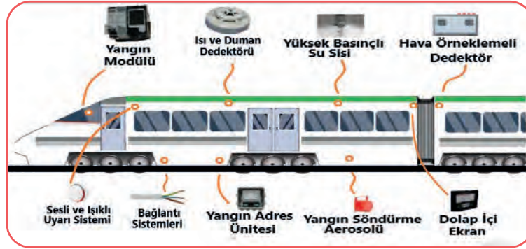
Şekil 7.12: Yangın sistem bileşenleri
