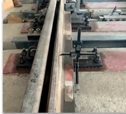
Görsel 11.3: Rayda yanal aşınma
