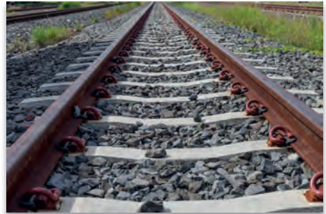
Görsel 3.14: Pandrol bağlantı sistemi (e-klips tipi)
