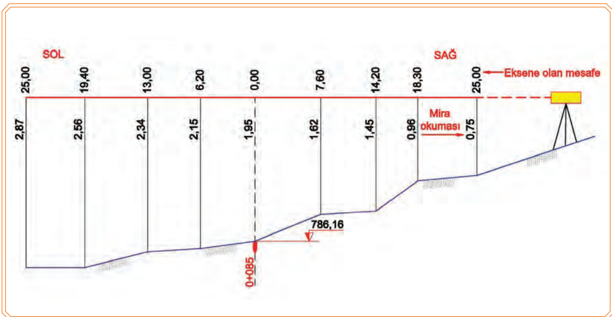
Görsel 9.13: Nivo ile en kesit alımı
