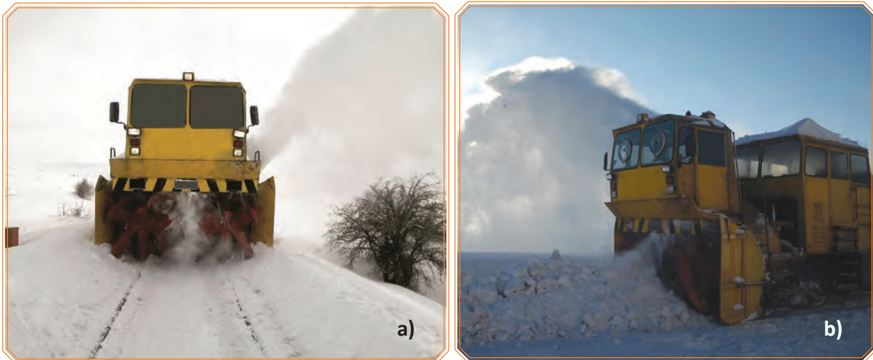
Görsel 6.27: (a,b) Makineli kar temizleme çalışmaları
