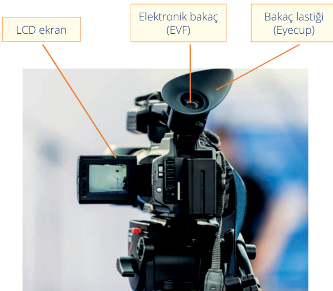
Görsel 3.30: ENG kameralarda EVF ve LCD ekran bir arada bulunur.
