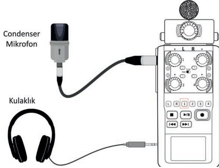
Görsel 1.12: Ses kayıt cihazına condenser mikrofon bağlama
