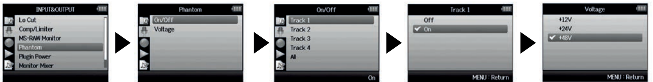
Görsel 1.13: Ses kayıt cihazında PHANTOM gerilimi
