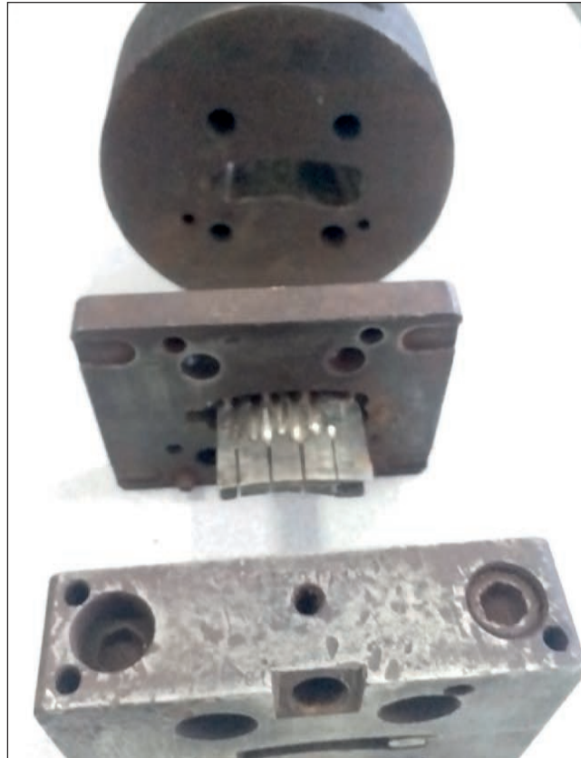
Görsel 9.3: Plastik ekstrüzyon profil kalıbının bakım için sökülmesi
