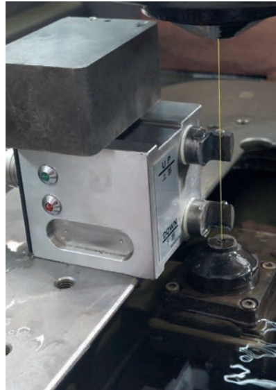
Görsel 7.23: Kesme telinin U ve V eksenleri diklik durumunun sensörle hizalanması
