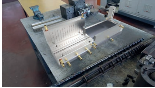
Görsel 8.4: Kalibre üzerinde vakum kanalları ve soğutma giriş çıkışları
