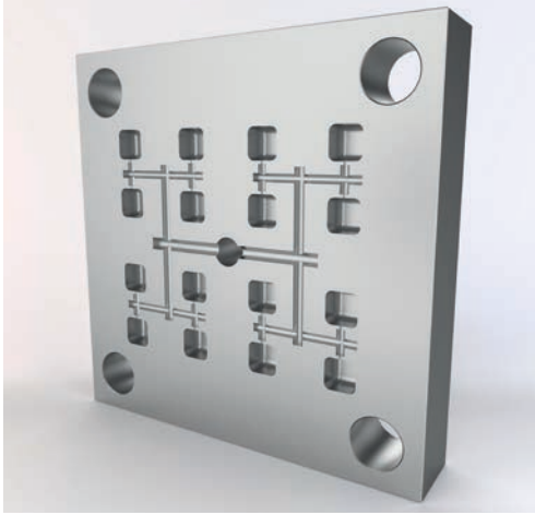
Görsel 4.8: Paralel yerleşimli dağıtıcı kanallar
