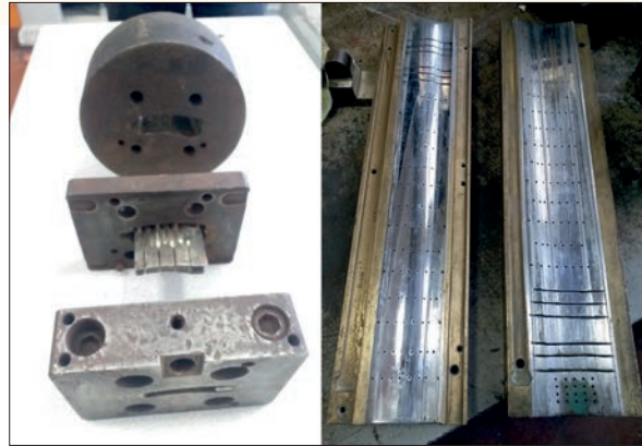
Görsel 9.2: Plastik ekstrüzyon profil kalıbı ve kalibresi
