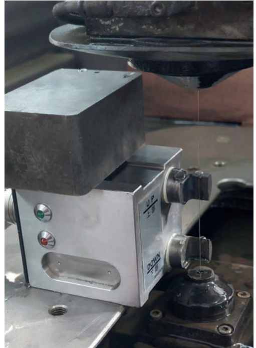
Görsel 2.21: Kalıp plakasındaki deliklerin delinmesi
