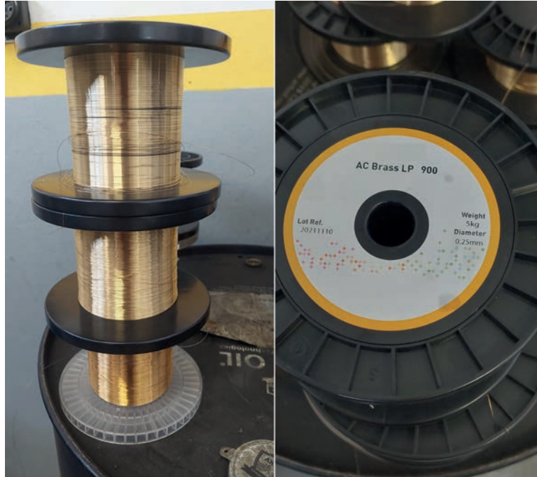
Görsel 7.19: Tel erozyon pirinç kaplamalı tel elektrot (çap 0.25mm)
