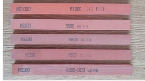
Görsel 5.15: Kendinden yağ dolgulı çeşitli tane büyüklüğüne sahip gaz taşları
