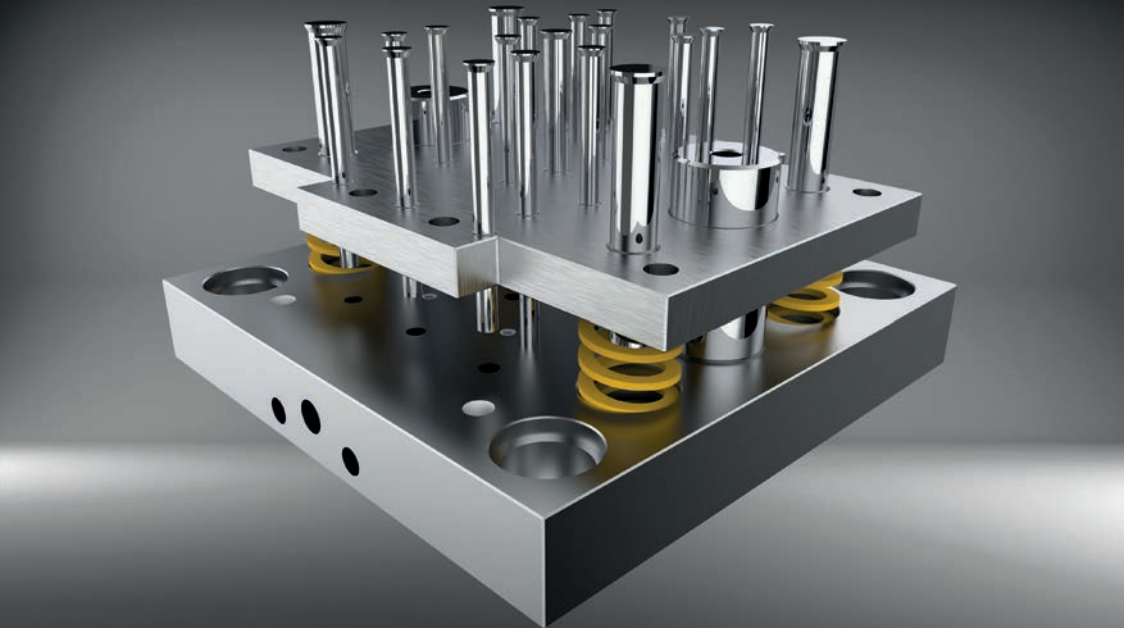
Görsel 5.25: Dişi kalıp plakası ve itici sistem montajı
