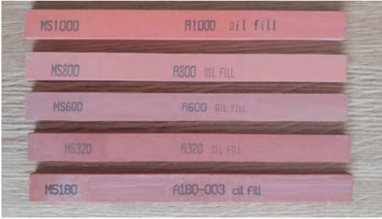
Görsel 8.7: Çeşitli tane büyüklüğüne sahip kendinden yağ dolgulı gaz taşları
