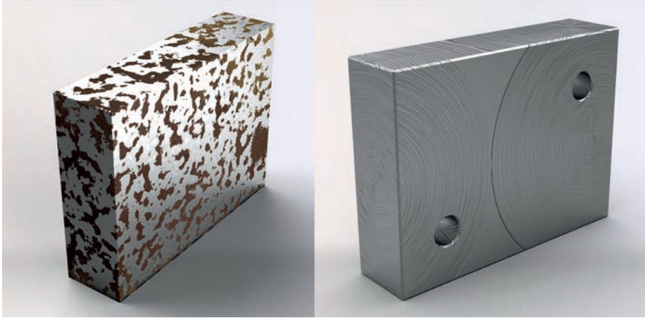
Görsel 2.19: El enjeksiyon erkek kalıbının frezeleme işlem öncesi ve sonrası
