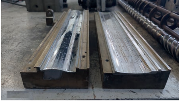
Görsel 8.5: Bronz kalibrede krom kaplama ve parlatma işlemi sonrası
