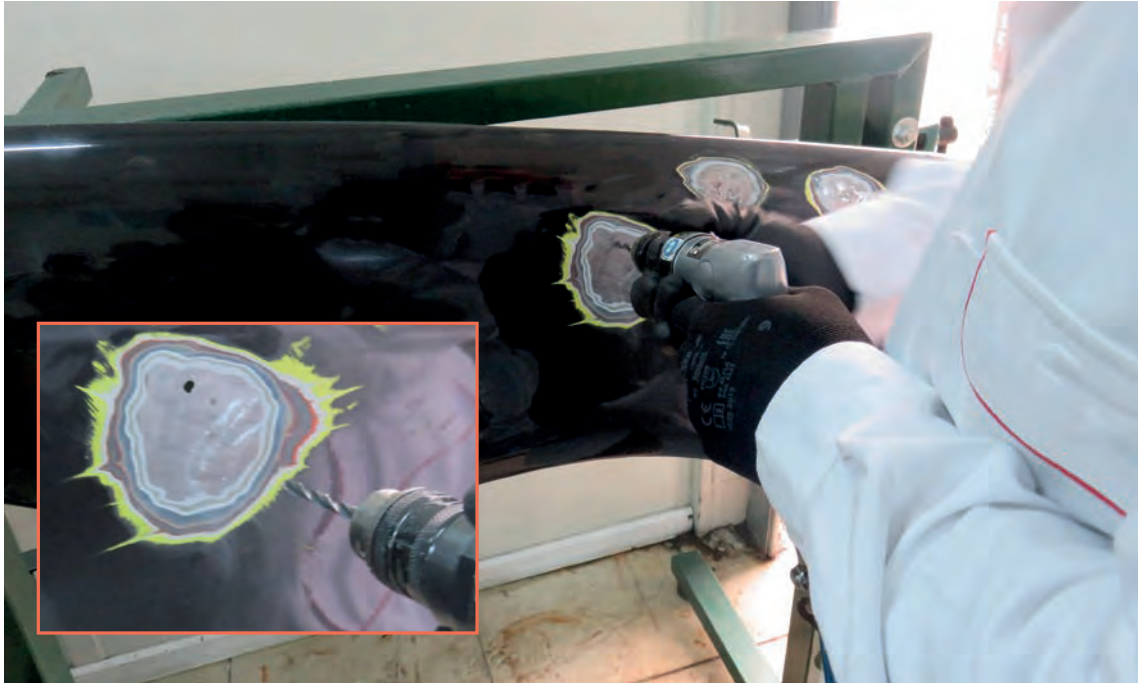
Görsel 2.41: Pnömatik el matkabı ile delme işlemi
