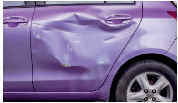
Görsel 4.2: Orta hasarlı araç paneli
