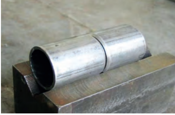
Görsel 1.121: Boruların sert lehimleme işlemine hazırlanması
