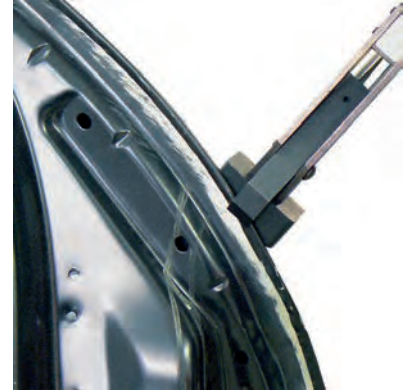
Görsel 5.27: Sac parçanın bükülmesi
