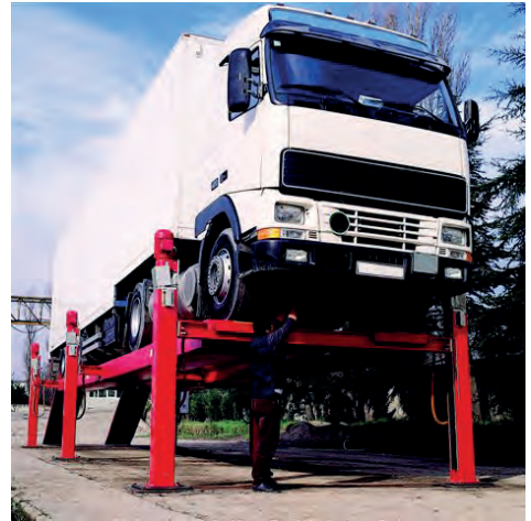
Görsel 3.101: Altı sütunlu lift ile ağır vasıta kaldırılması
