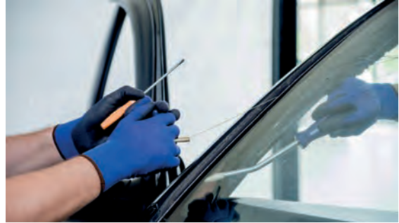
Görsel 5.12: İki kişi ile cam yapışkanının kesilmesi
