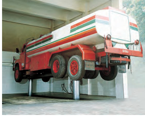
Görsel 3.103: Hidrolik pistonlu ağır vasıta liftinin kullanımı
