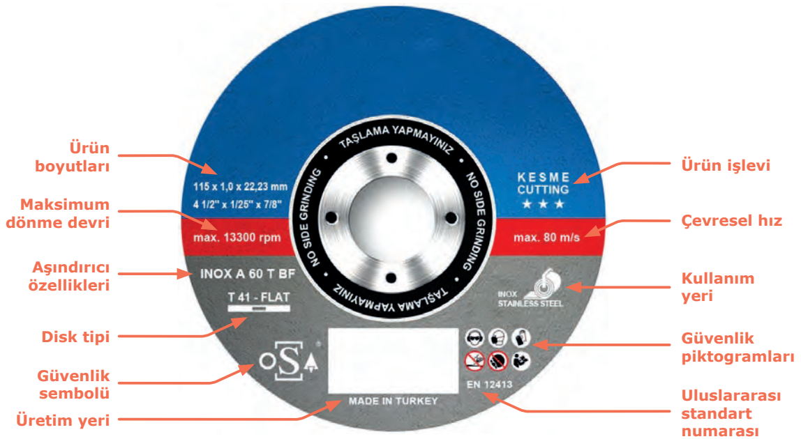
Görsel 2.12: Kesme diskinin üzerindeki etiket bilgileri
