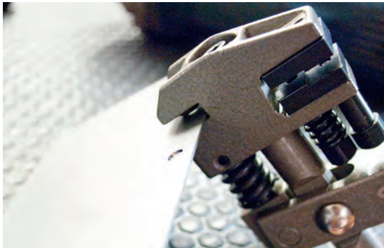
Görsel 5.23: Sac malzemede delik açılması
