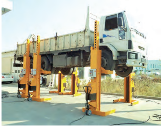
Görsel 3.106: Mobil kolonlu lift ile ağır vasıta kaldırılması
