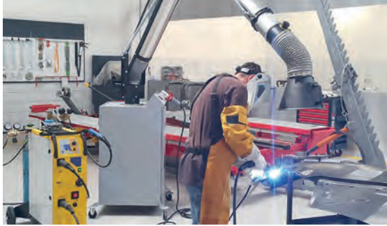
Görsel 1.84: Gazaltı kaynağı uygulaması
