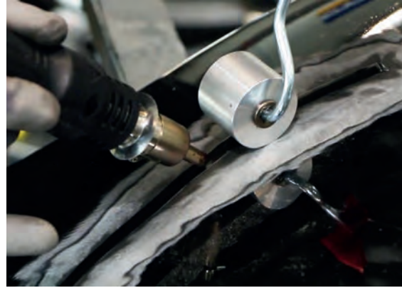
Görsel 3.43: Kaynaklanan kısmın düzeltilmesi
