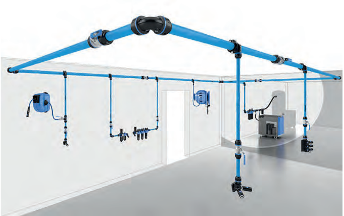
Görsel 2.3: Basınçlı hava tesisatı hattı
