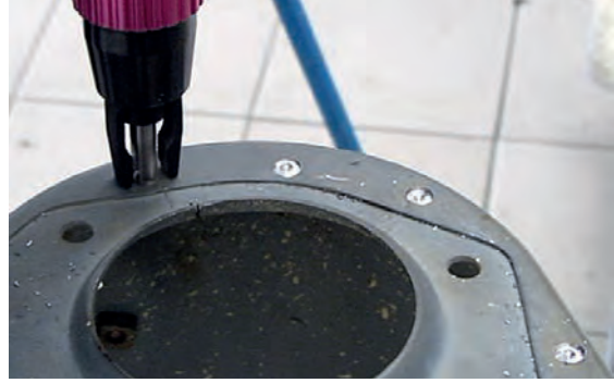
Görsel 2.23: Amortisör kulesi üzerinde punta çürütme
