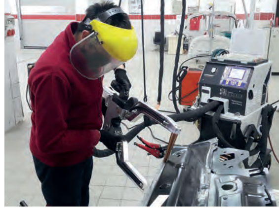
Görsel 1.66: X pense ile punta kaynağı
