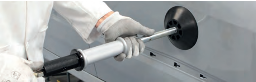
Görsel 2.66: Vakumlu çekirme cihazının kullanımı
