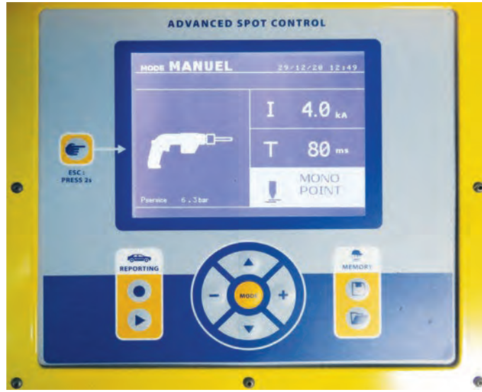
Görsel 1.62: Punta kaynak makinesi kontrol paneli
