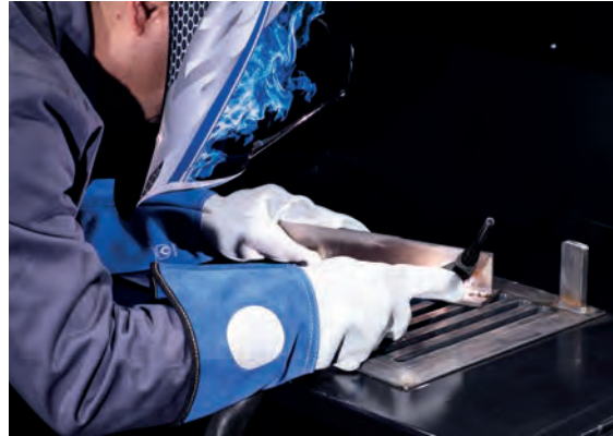
Görsel 1.99: TIG kaynağı ile alüminyum kaynatılması
