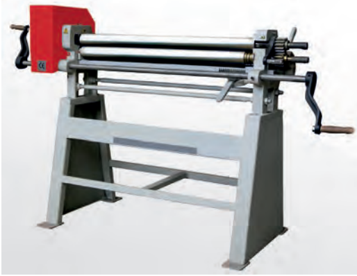
Görsel 5.34: Mekanik silindir kıvrırma makinesi
