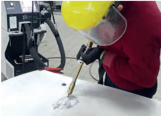
Görsel 1.76: Üçgen elektrot ile göçük çekirme
