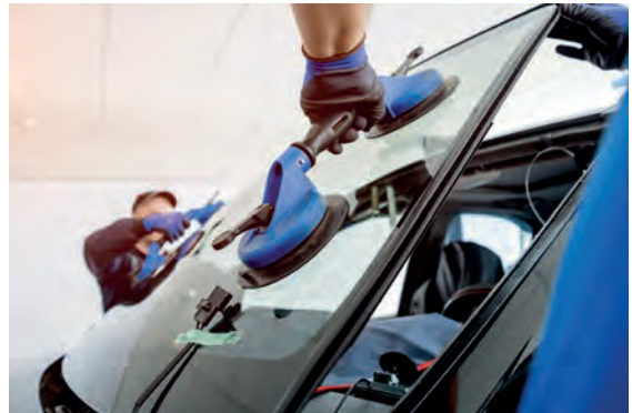
Görsel 5.15: Camın yerleştirilmesi
