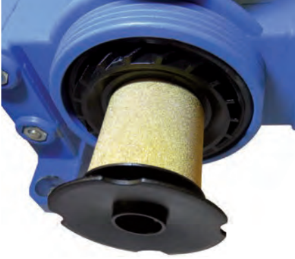
Görsel 2.5: Filtre bölümünün iç yapısı
