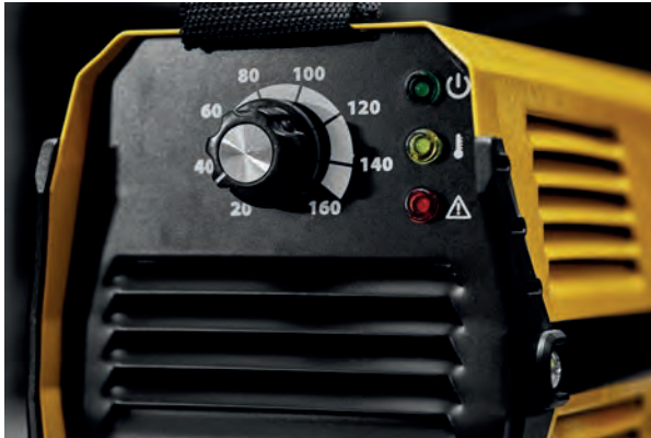
Görsel 1.48: Kaynak akımının ayarlanması
