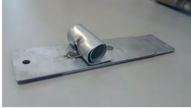
Görsel 1.80: Punta kaynağı kopma testi
