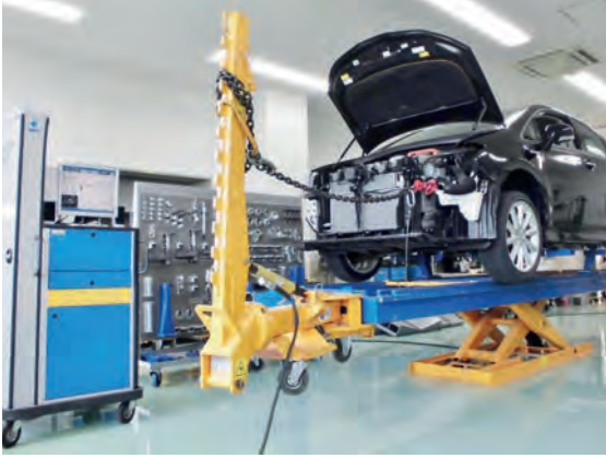
Görsel 4.17: Araç gövde düzeltme işlemi
