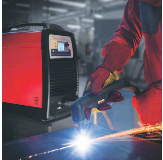
Görsel 3.54: Plazma kesme cihazının kullanımı
