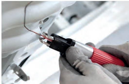
Görsel 2.18: Pnömatik karoseri testeresi ile kesme işleminin yapılması
