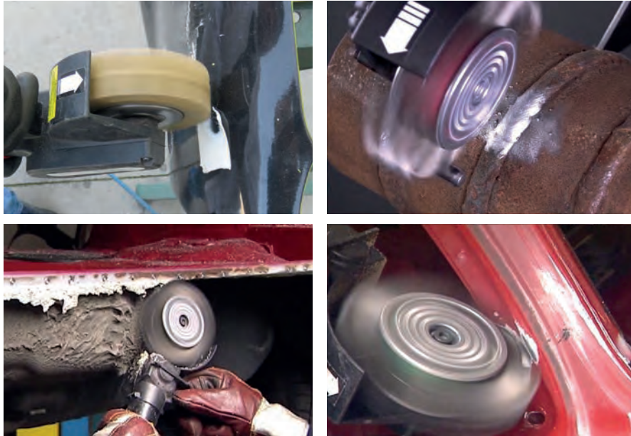
Görsel 2.64: Pnömatik yüzey temizleme cihazının kullanımı
