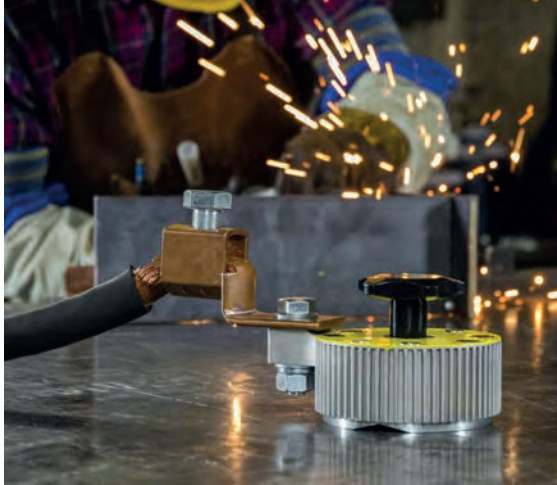
Görsel 3.66: Manyetik şase tutucu kullanımı
