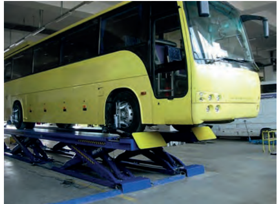
Görsel 3.118: Makaslı lift ile ağır vasıta kaldırılması
