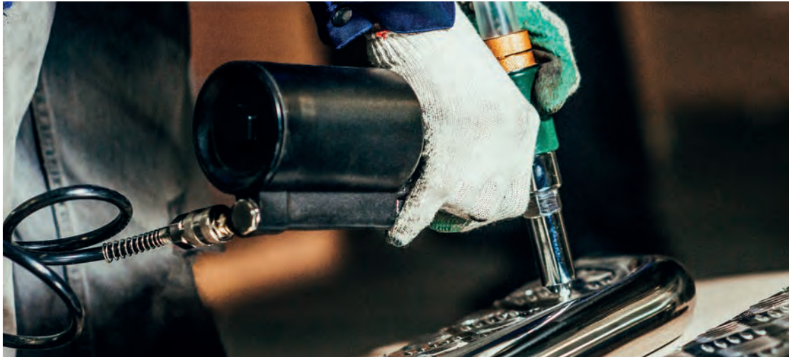
Görsel 2.51: Pnömatik perçin tabancasının kullanımı
