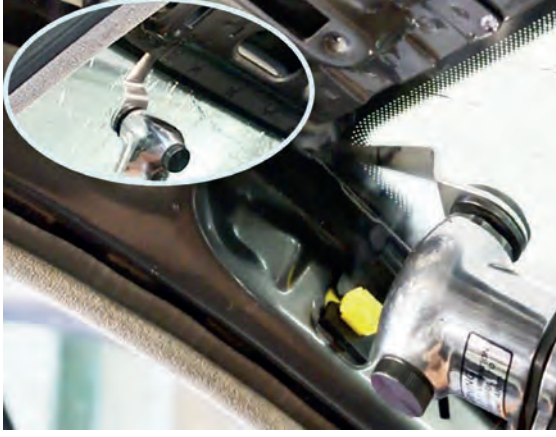
Görsel 2.30: Cam yapışkanının kesilmesi
