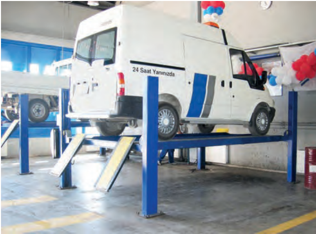
Görsel 3.100: Dört sütunlu lift ile hafif ticari araç kaldırılması
