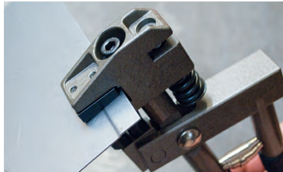
Görsel 5.24: Kenet pensesi ile parçanın hazırlanması
