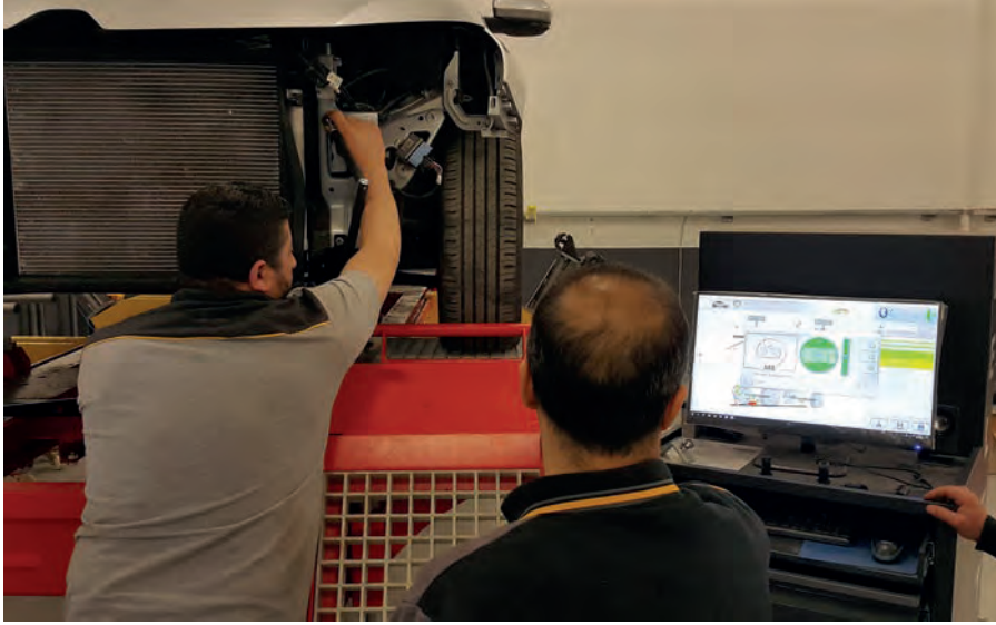
Görsel 4.9: Araç gövdesinin ön kısmında ölçüm yapılması
