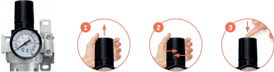
Görsel 2.9: Hava şartlandırıcıda basınç ayarlama işlemi
