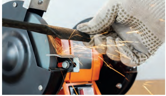
Görsel 3.20: Zımpara taşı tezgâhının kullanımı
