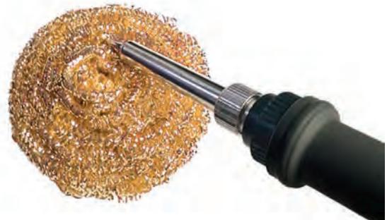
Görsel 1.107: Havya ucunun tel ile temizlenmesi
