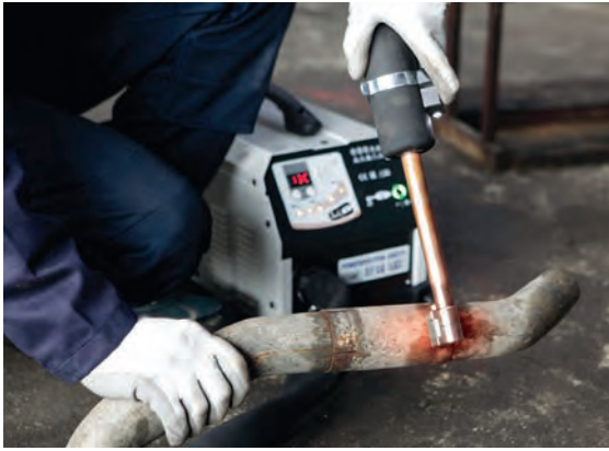
Görsel 3.59: Egzoz bağlantısının ısıtılması
