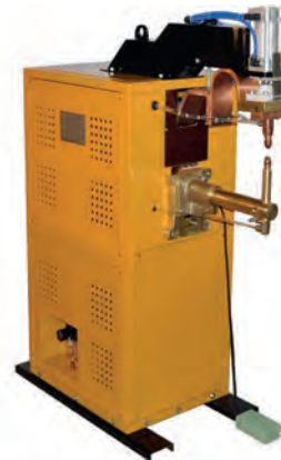
Görsel 1.58: Sabit punta kaynak makinesi
