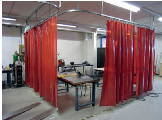
Görsel 1.38: Kaynak perdeleri ile ayrılmış kaynak alanı
