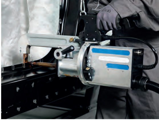
Görsel 1.65: C pense ile punta kaynağı
