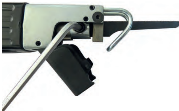
Görsel 2.17: Testere ucunun değiştirilmesi
