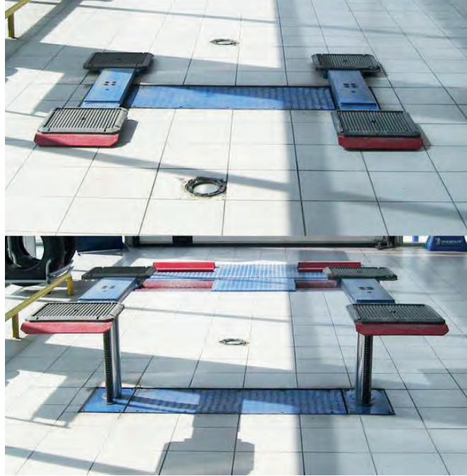
Görsel 3.95: Platformlu iki pistonlu elektrohidrolik lift
