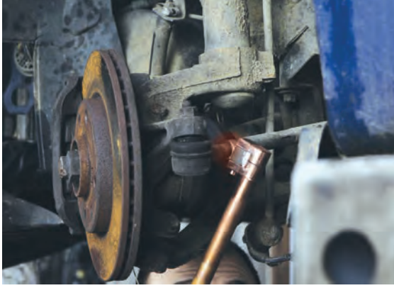
Görsel 3.57: Rot başının ısıtılması
