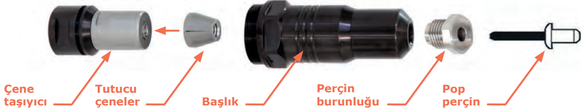
Görsel 2.50: Perçin tutucu çene mekanizmasının yapısı
