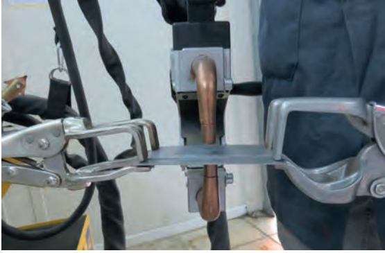
Görsel 1.51: Punta kaynağının yapılışı
