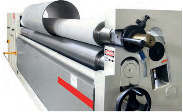
Görsel 5.35: Elektrikli silindir kıvrırma makinesi
