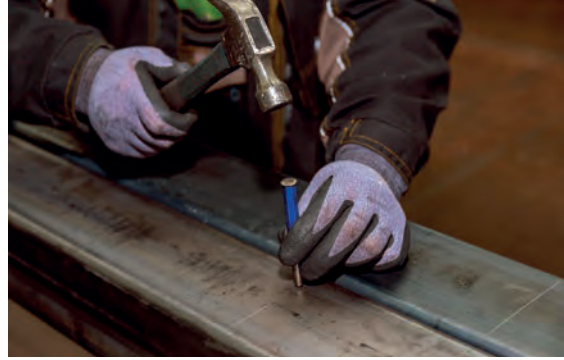
Görsel 5.58: Çekiç ve nokta ile markalama işlemi
