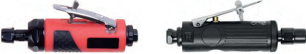
Görsel 2.35: Havalı kalıpcı taşlama cihazı
