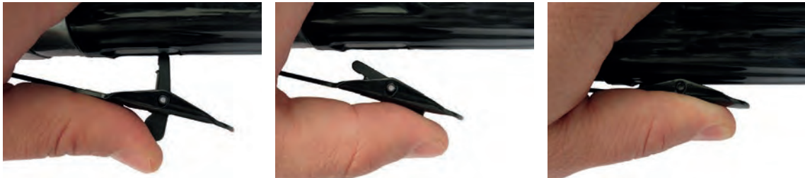
Görsel 2.14: Tetik emniyet mekanizmasının çalışması
