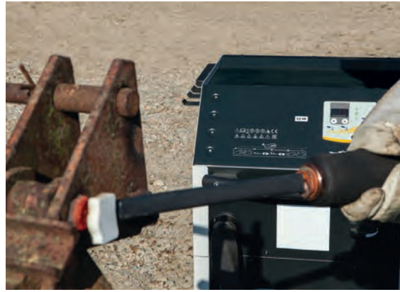
Görsel 3.60: Cıvata başının ısıtılması
