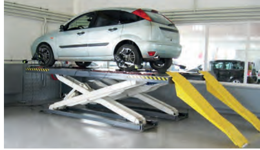
Görsel 3.112: Makaslı lift ile araç kaldırılması
