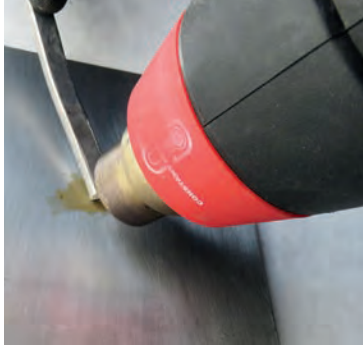
Görsel 1.108: Sıcak hava üfleyici ile lehimleme
