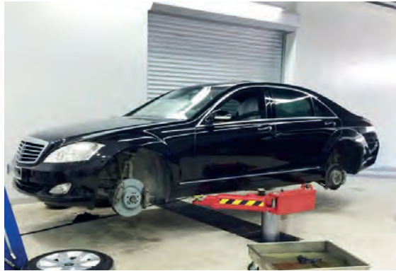
Görsel 3.96: Kollu iki pistonlu lift ile araç kaldırılması
