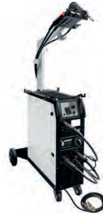
Görsel 1.88: Üç torçlu gazaltı kaynak makinesi
