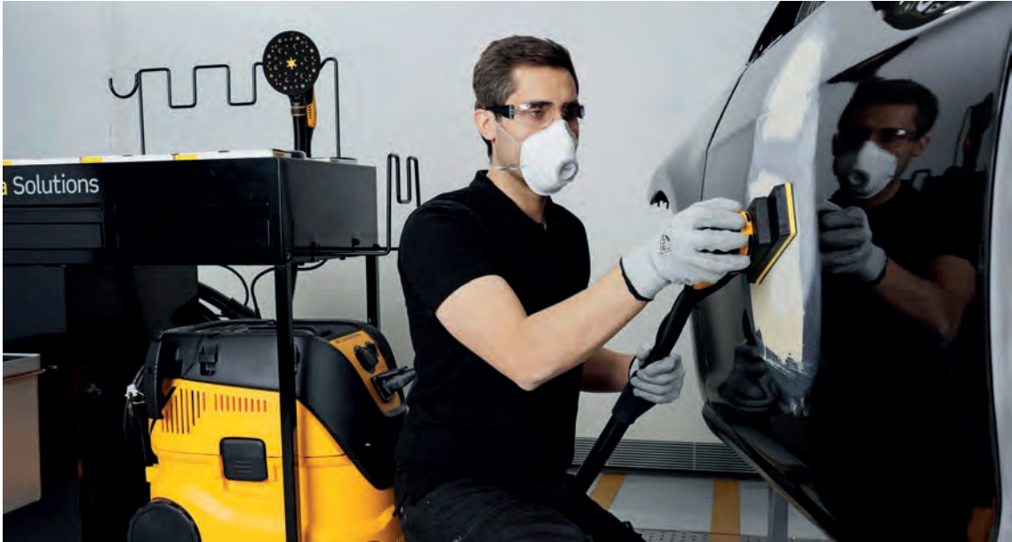
Görsel 3.33: Kuru zımpara toz emiş makinesinin kullanımı
