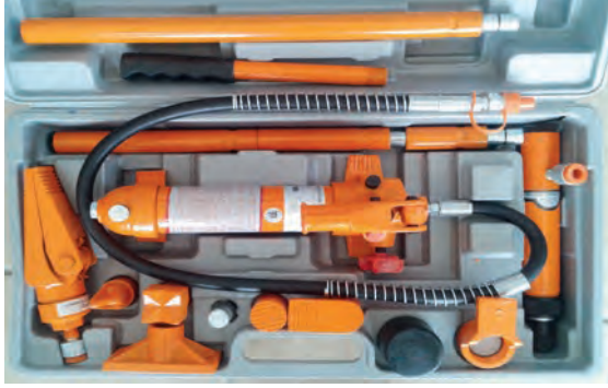
Görsel 4.26: 4 ton yük kapasiteli itme pistonu seti
