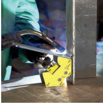
Görsel 3.69: Manyetik pozisyon tutucunun kullanımı
