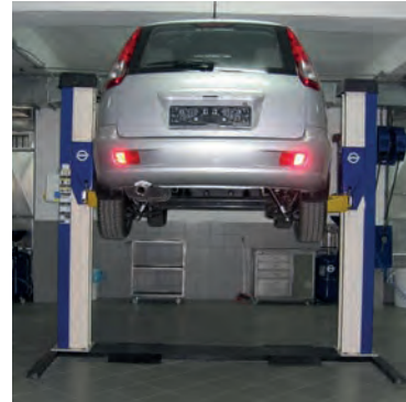
Görsel 3.86: Lift ile araç kaldırılması
