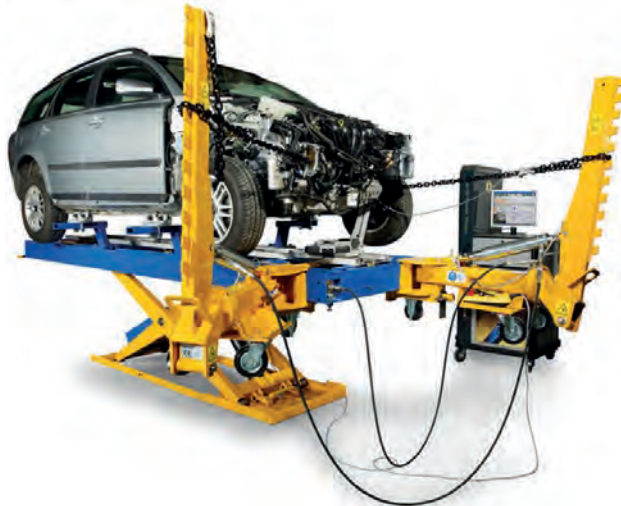
Görsel 4.14: Tezgâh üzerinde araç gövdesinin düzeltilmesi
