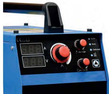
Görsel 1.49: Kaynak makinesi kontrol paneli
