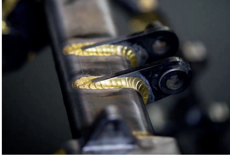
Görsel 1.116: Sert lehimleme ile yapılan birleştirme
