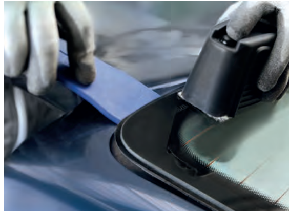
Görsel 3.62: Cam yapışkanının ısıtıcı ile sökülmesi
