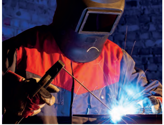
Görsel 1.18: Elektrik ark kaynağı
