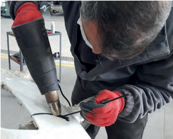
Görsel 3.51: Fön ile plastik kaynağı yapılması
