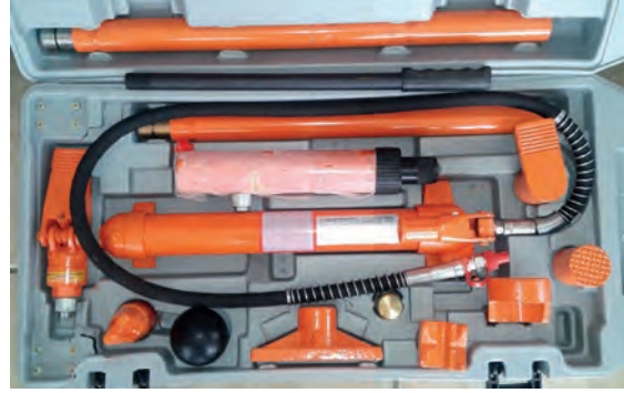
Görsel 4.27: 10 ton yük kapasiteli itme pistonu seti
