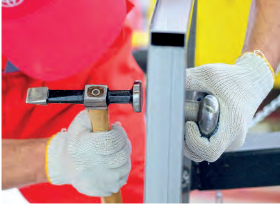
Görsel 5.63: Çekiç dayama yönteminin uygulanışı
