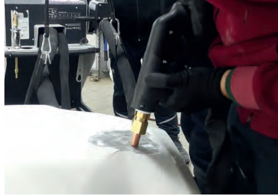
Görsel 1.75: Bakır elektrot ile şiş indirme
