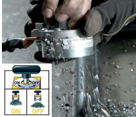
Görsel 3.67: Metal parçaların dökülmesi
