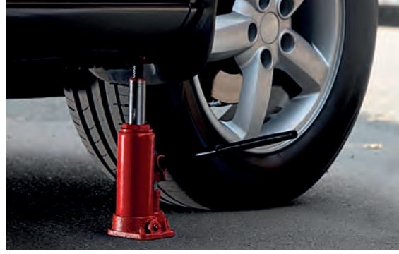
Görsel 4.22: Şişе kriko ile araç kaldırılması
