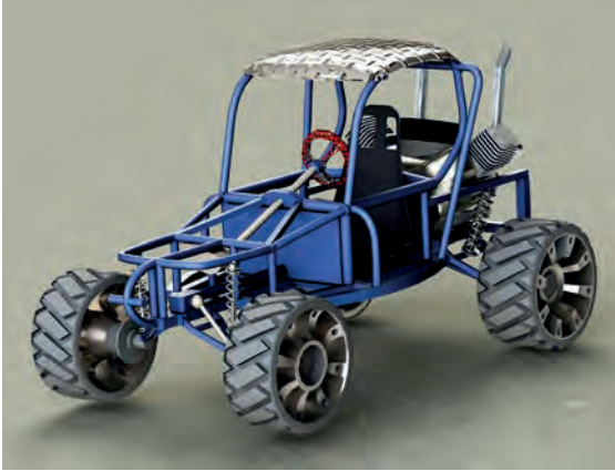
Görsel 5.1: Borudan imal edilmiş şasili buggy araç
