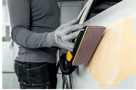
Görsel 3.29: Orbital zımpara makinesinin kullanımı
