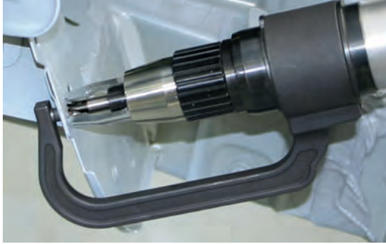
Görsel 2.22: Sac parçada punta çürütme işlemi
