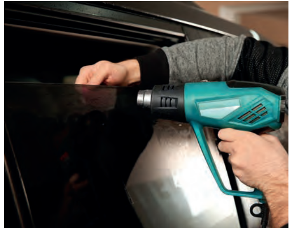
Görsel 3.52: Fön ile cam filmi uygulaması
