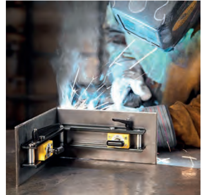
Görsel 3.73: Manyetik parça tutucu ile köşe kaynağı
