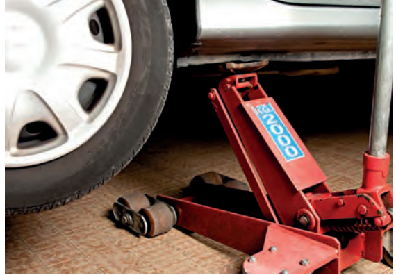
Görsel 4.30: Arabalı kriko ile araç kaldırılması
