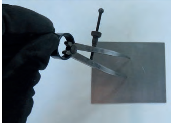
Görsel 5.54: Pergel ile markalama işlemi
