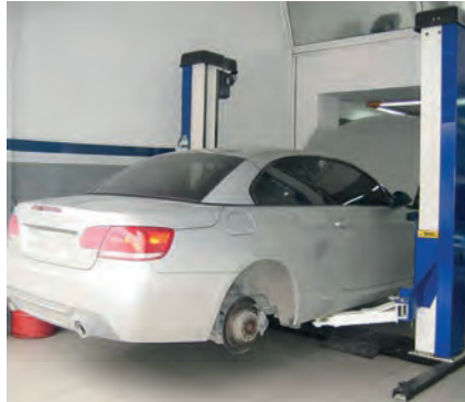
Görsel 3.85: Lift ile araç kaldırılması
