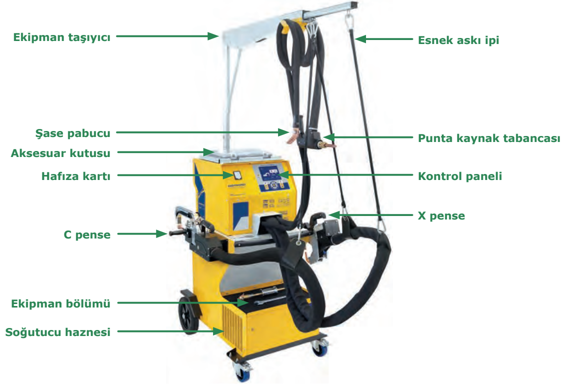
Görsel 1.61: Çok yönlü punta kaynak makinesinin yapısı
