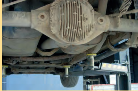
Görsel 3.90: Lift kollarının yerleştirilmesi
