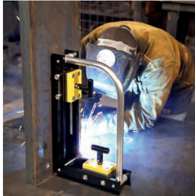
Görsel 3.72: Manyetik parça tutucunun kullanımı
