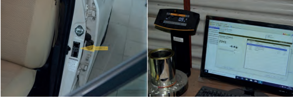
Görsel 1.45: Araçtan renk kodunun okunması ve renk bilgisayara girilmesi
