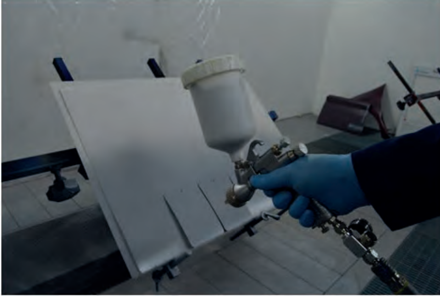
Görsel 1.49: Vernik uygulaması
