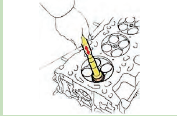
Görsel 6.73: Supabın supap yüzeyine bastırılması
