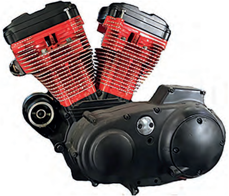
Görsel 7.1: Hava soğutmalı motosiklet motoru
