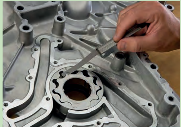
Görsel 7.45: Dişliler arası boşluğun kontrolü
