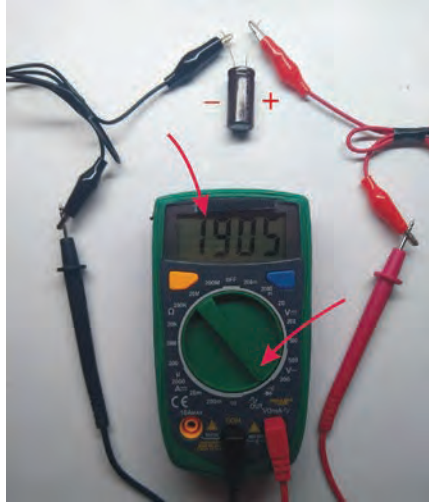
Görsel 10.7: Kondansatör sağlamlık kontrolü
