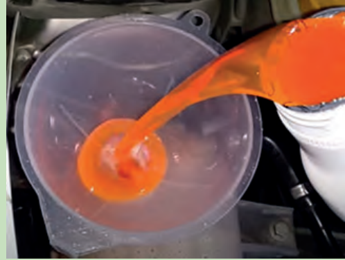
Görsel 7.27: Soğutma sıvısının konulması
