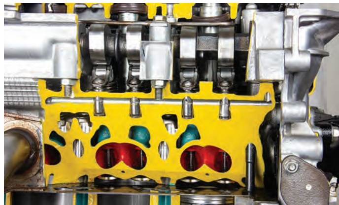
Görsel 6.5: Kam mili silindir kapağında olan külbütör sistemi
