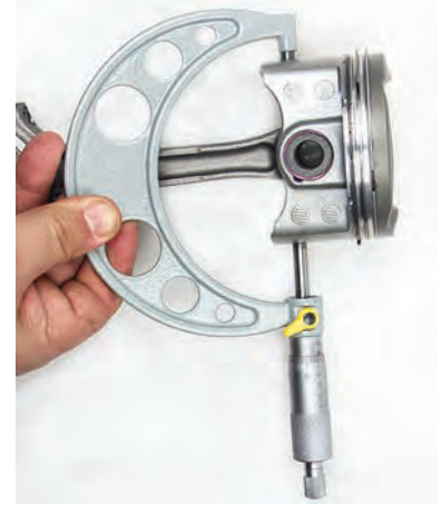
Görsel 8.8: Piston çap ölçümü
