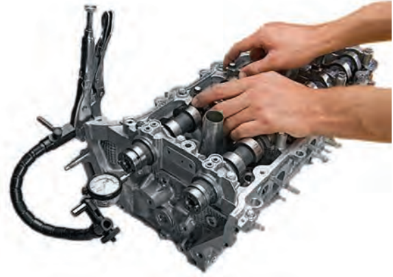
Görsel 6.32: Kam mili eksenel boşluk ölçümü
