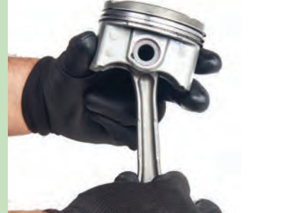
Görsel 8.15: Piston hareket durumunun kontrolü
