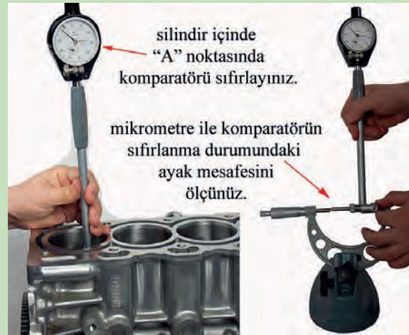
Görsel 2.58: Mikrometre ve komparatör ile ölçme
