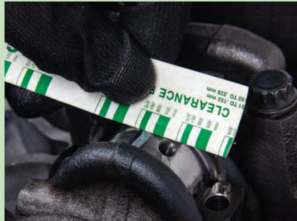
Görsel 8.35: Kol muylusu üzerindeki ezilmiş plastik geycin ölçümü
