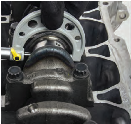
Görsel 8.59: Biyel kol muylusunun koniklik ve ovallik ölçümü
