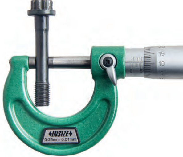
Görsel 8.31: Biyel kep cıvatası çap ölçümü
