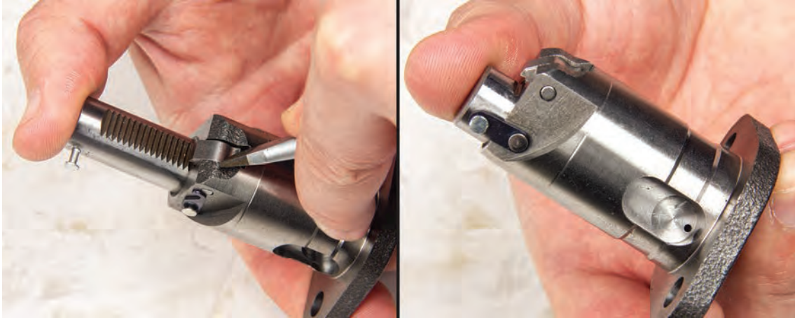
Görsel 6.58: Zincir gergisinin çalışma kontrolü
