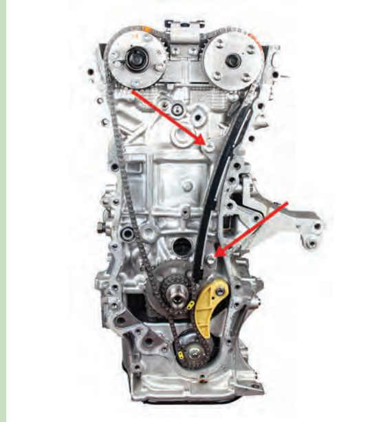
Görsel 6.45: Zincir titreşim sönümleyicisinin sökülmesi
