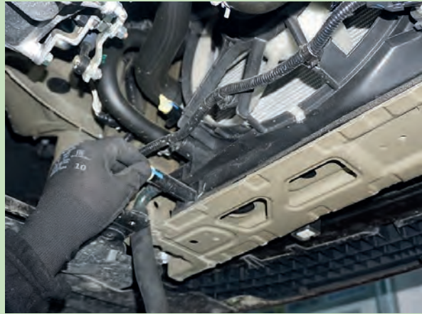
Görsel 7.12: Soğutma sıvısının boşaltılması
