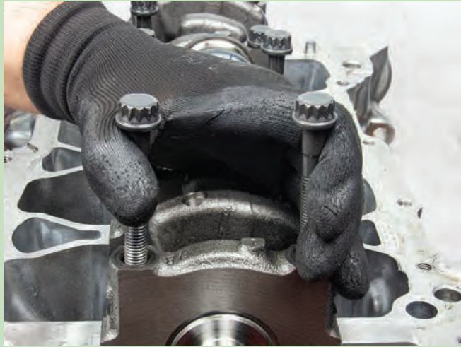
Görsel 8.77: Ana yatak keplerin sökülmesi
