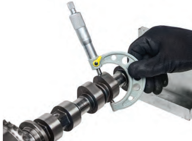
Görsel 6.36: Kam profili aşıntı ölçümü
