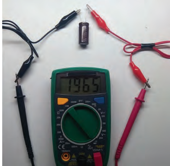
Görsel 10.15: Kondansatörün sağlamlık kontrolü
