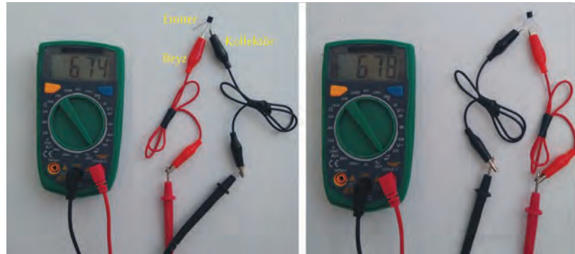
Görsel 10.5: Transistör ayaklarının tespit edilmesi
