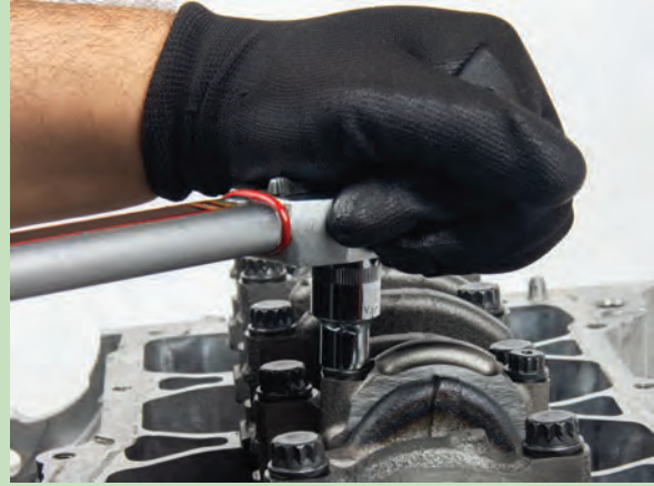
Görsel 8.34: Kol muylusu kep cıvatalarının sıkılması
