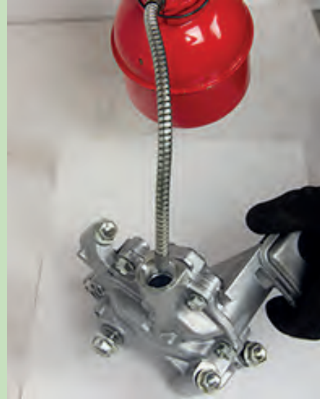
Görsel 7.44: Basınç ayarlama valfinin kontrolü
