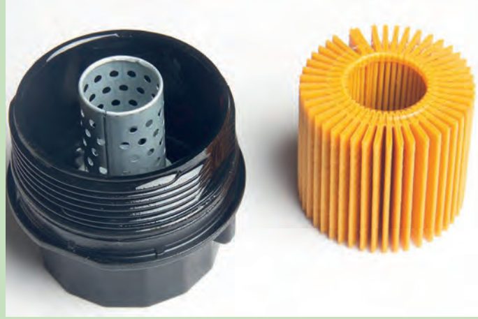
Görsel 7.50: Yeni filtre elemanının takılması
