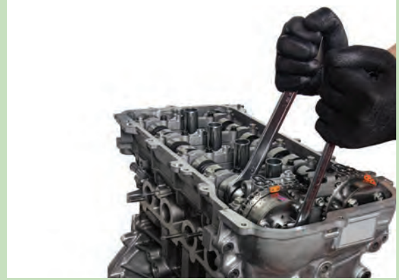
Görsel 6.24: Supap zamanlama dişlisinin sökülmesi
