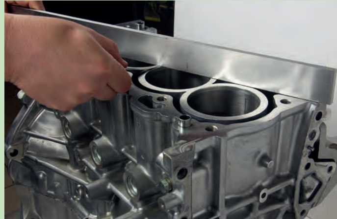
Görsel 5.46: Silindir bloğu yüzey eğikliği kontrolü
