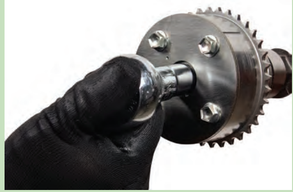
Görsel 6.96: Supap zamanlama dişlisinin sökülmesi
