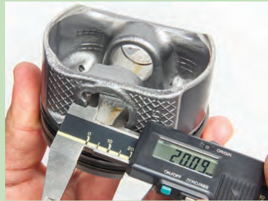
Görsel 8.24: Piston pim deliği çapı ölçümü
