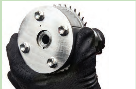
Görsel 6.98: Supap zamanlama grubunun kam miline takılırken döndürülmesi
