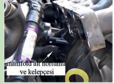
Görsel 5.15: Manifold alt hortum bağlantısı
