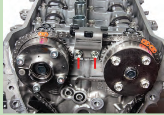
Görsel 6.52: Zincir titreşim sönümleyicisinin takılması
