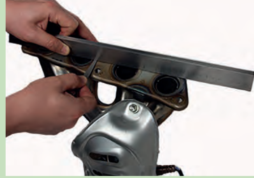
Görsel 5.22: Egzoz manifoldu yüzeyi eğiklik kontrolü
