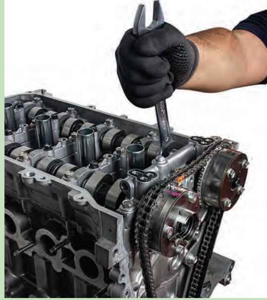
Görsel 6.49: Kam milinin anahtar yardımıyla döndürülmesi
