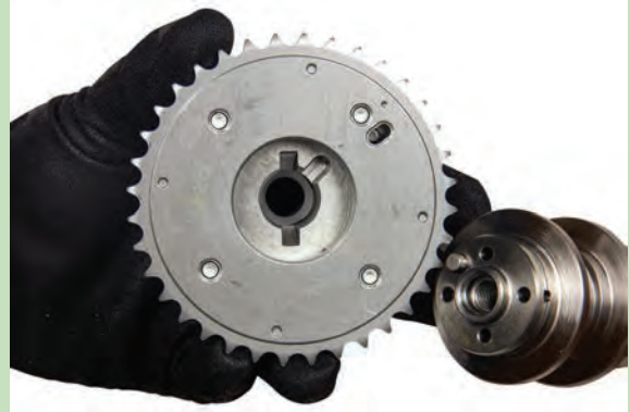
Görsel 6.97: Supap zamanlama dişlisinin sökülmesi
