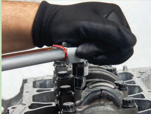
Görsel 8.73: Biyel kol kepi civatalarının sökülmesi
