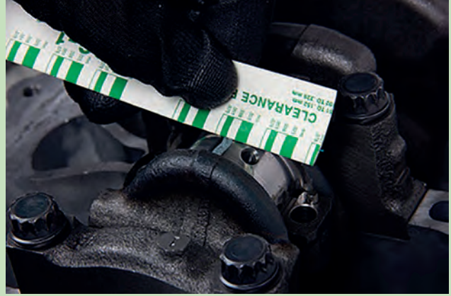
Görsel 2.60: Plastik geyç ile yağ boşluğunu ölçme
