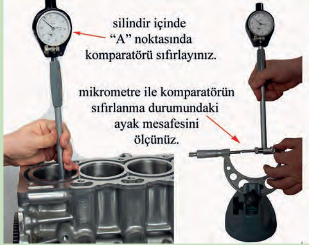
Görsel 5.48: Silindir iç çaplarının ölçülmesi
