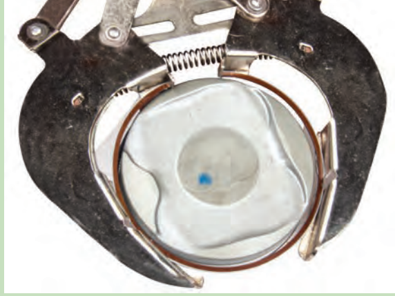
Görsel 8.82: Kompresyon segmanının pistona takılması
