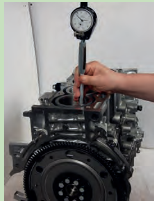
Görsel 5.50: Silindir iç çaplarının ölçülmesi
