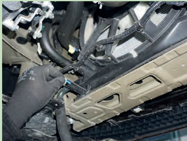
Görsel 7.16: Soğutma sıvısının boşaltılması
