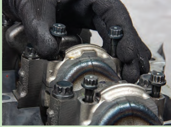
Görsel 8.74: Piston kolu kepinin sökülmesi
