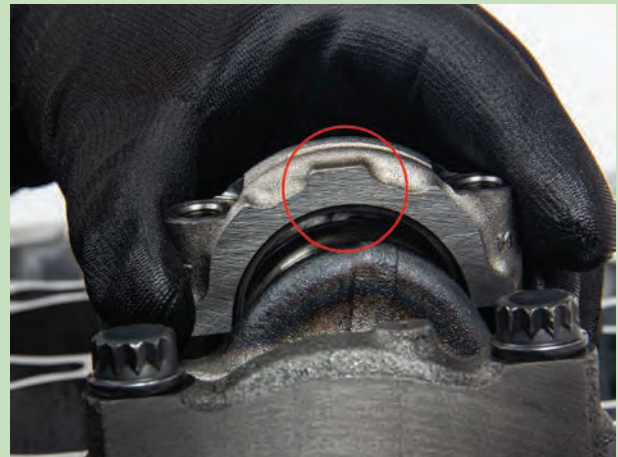
Görsel 8.92: Biyel keplerinin üzerindeki ön işareti
