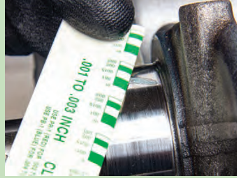
Görsel 8.54: Ana muylu üzerindeki plastik geycin ölçümü
