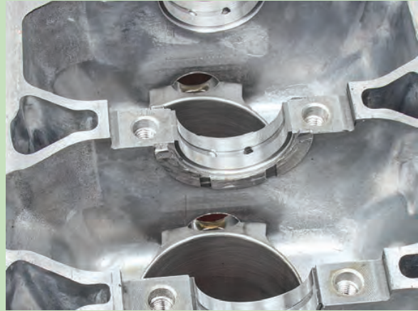
Görsel 8.55: Gezinti aylarının silindir bloğuna takılması
