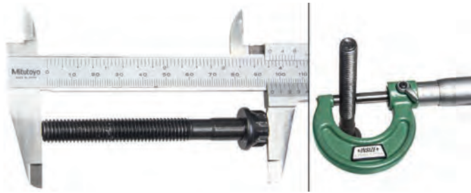
Görsel 8.61: Krank mili ana yatak civatasının uzunluk ve çap ölçümü
