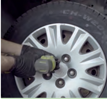
Görsel 7.17: Tekerleğin sökülmesi
