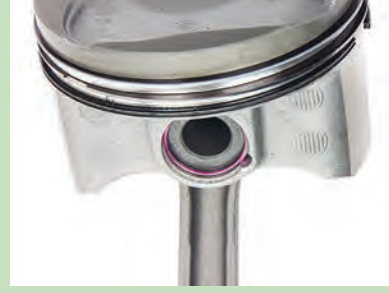
Görsel 8.13: Piston pimi segmanının takılması
