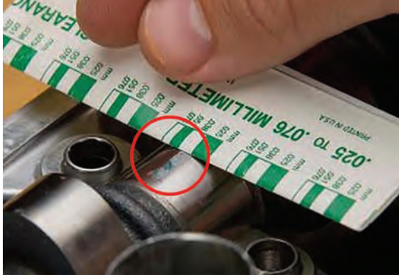
Görsel 6.34: Kam mili yağ boşluğu ölçümü
