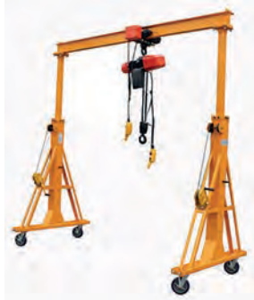
Görsel 2.46: Seyyar (Elektrik ve mekanik) vinçler
