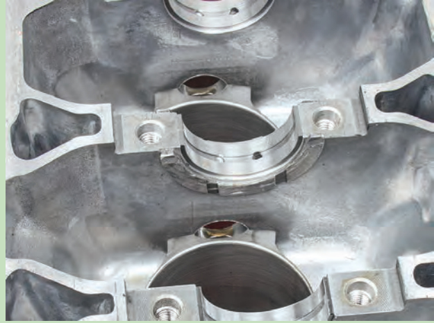
Görsel 8.85: Gezinti ayların silindir bloğuna takılması
