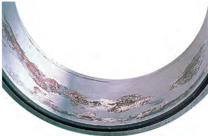
Görsel 8.70: Yatak yorgunluğu olan motor yatağı
