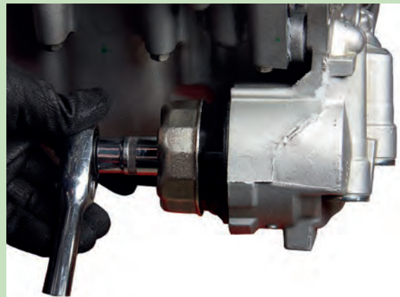
Görsel 7.51: Filtre kapağının sıkılması
