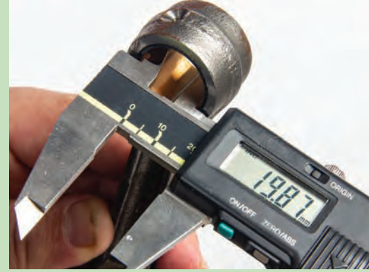
Görsel 8.26: Piston kolu pim deliği çap ölçümü
