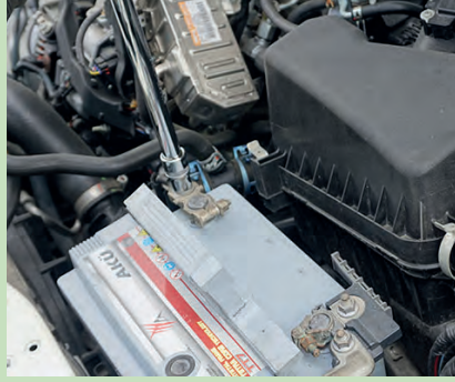
Görsel 7.18: Akü kutup başlarının sökülmesi
