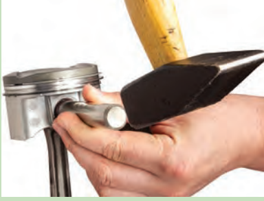
Görsel 8.12: Piston piminin çıkartılması
