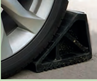
Görsel 4.18: Tekerleğe takoz yerleştirme
