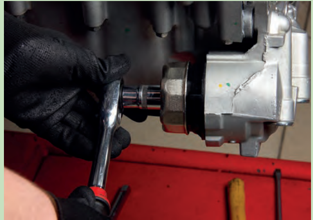
Görsel 7.48: Yağ filtresinin sökülmesi
