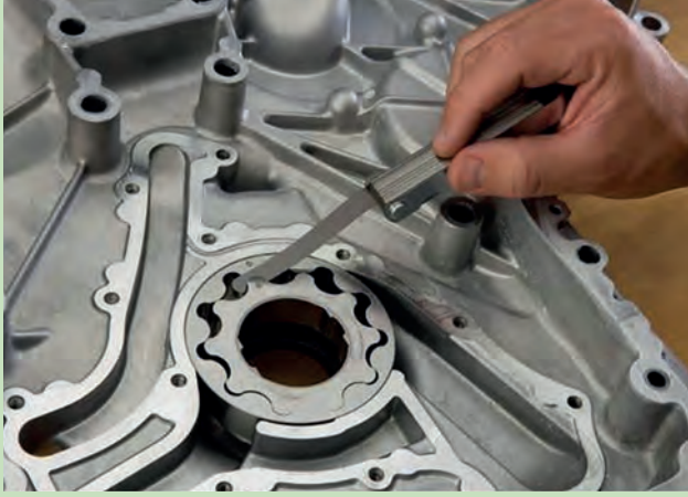
Görsel 7.47: Dişli ile gövde arasındaki boşluğun kontrolü
