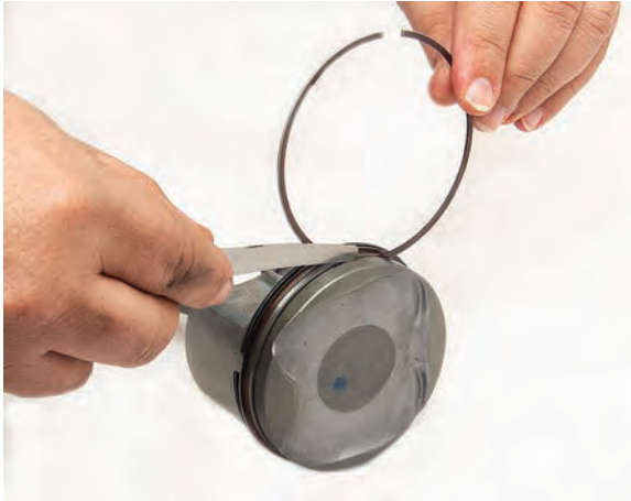
Görsel 8.9: Segman kanalı boşluğunun ölçümü
