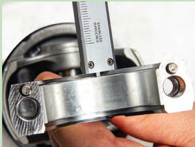
Görsel 8.89: Kol yataklarının takılması
