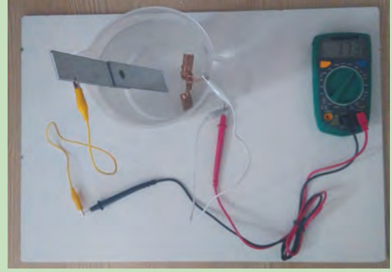
Görsel 9.40: Kimyasal yolla elde edilen elektriğin ölçümü
