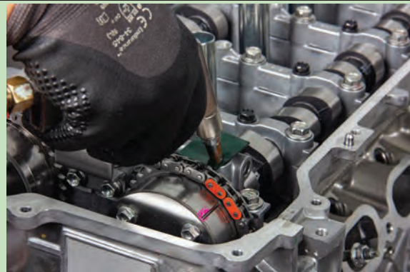
Görsel 6.100: Değişken supap zamanlama sistemine basınçlı hava verilmesi
