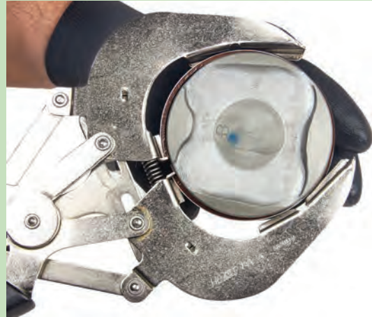
Görsel 8.75: Kompresyon segmanlarının sökülmesi
