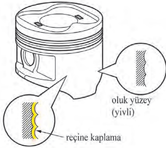
Görsel 8.6: Piston üzerindeki reçine kaplama
