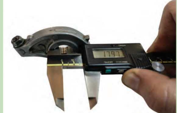
Görsel 6.11: Külbütör kolu çap ölçümü
