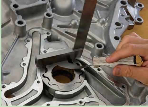
Görsel 7.46: Dişliler ile yüzey arası boşluğunun kontrolü
