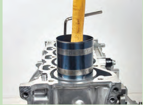
Görsel 8.91: Pistonların silindir bloğuna takılması
