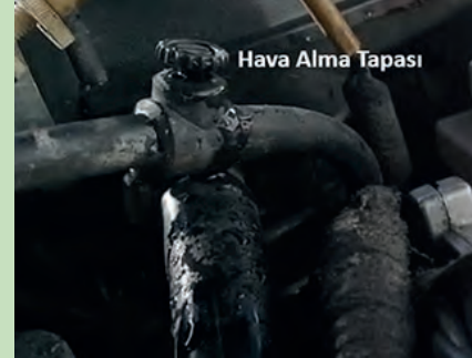
Görsel 7.28: Soğutma sisteminin havasının alınması
