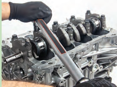
Görsel 8.51: Ana yatak kepi civatalarının sıkılması
