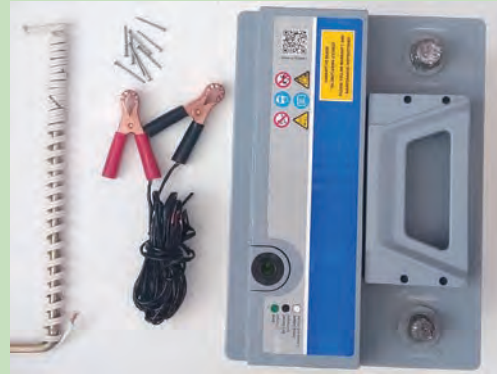
Görsel 9.36: Elektriğin manyetik etkisi deneyi araç ve gereçleri
