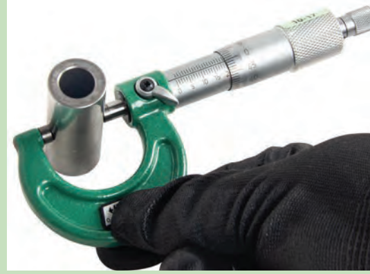
Görsel 8.25: Piston pimi çapı ölçümü
