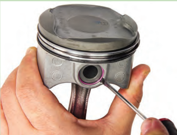
Görsel 8.10: Piston pimi segmanının çıkartılması
