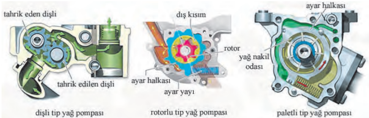
Görsel 7.34: Yağ pompası tipleri
