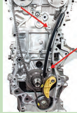
Görsel 6.46: Zincir titreşim sönümleyicisinin takılması
