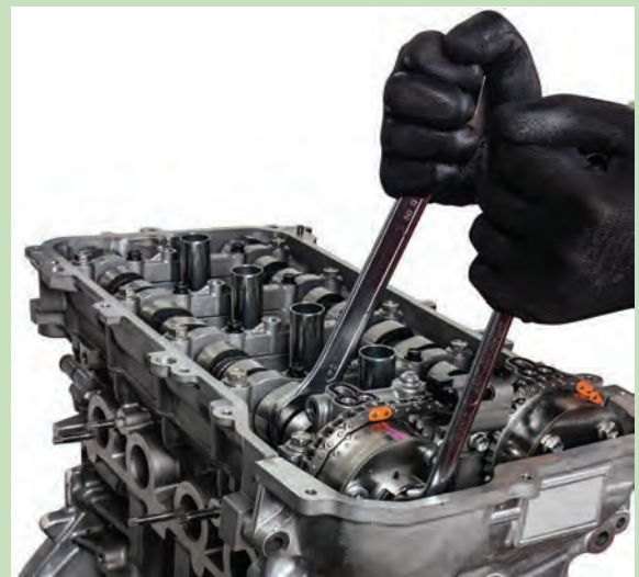
Görsel 6.95: Egzoz kam mili akıllı supap zamanlama dişlisinin sökülmesi
