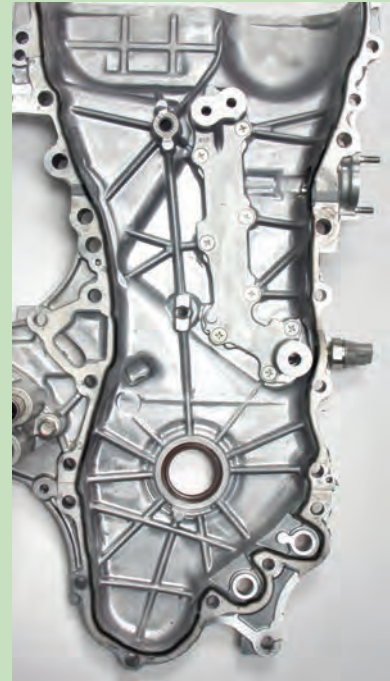
Görsel 6.53: Zamanlama zincir kapağına sıvı conta uygulaması
