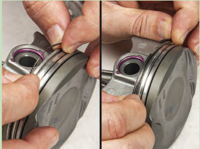
Görsel 8.81: Yağ segmanlarının pistona takılması
