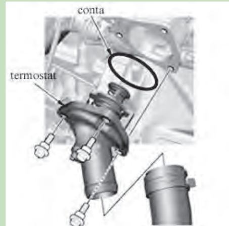
Görsel 7.13: Termostatın sökülmesi
