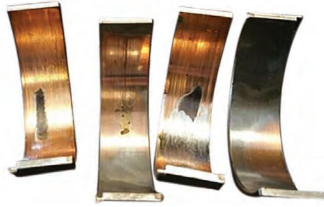
Görsel 8.71: Korozyona uğramış motor yatağı
