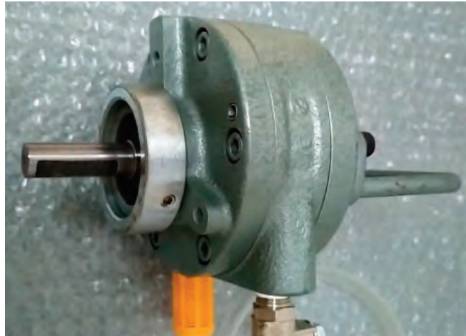
Görsel 3.41: Türbin tipli pnömatik motor
