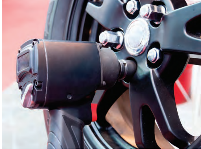
Görsel 3.36: Pnömatik motorla çalışan el aleti
