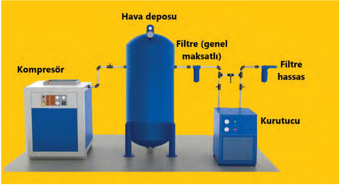
Görsel 3.13: Kurutucu bağlanmış pnömatik sistem
