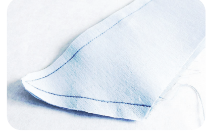
Görsel 2.6: Yakaya makine çekilmesi
