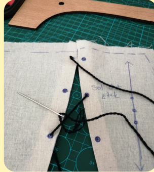
Görsel 1.113: Dikiş iğnesiyle kordon geçirme
