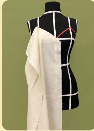
Görsel 2.100: Sol beden kumaşını yerleştirme
